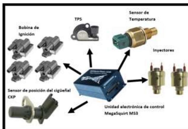
**Nota:** descripción de sensores y actuadores del sistema electrónico de control MS3.
