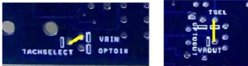
*Nota:* En el apartado a) se muestra la selección de sensor CKP o distribuidor, en el apartado b) se selecciona el tipo de lectura para un sensor tipo DC o AC. Configuración de la placa MS3 ((base)/V3.0 Hardware Guide, Crank and Cam tach inputs. Pag.70. 2018)
