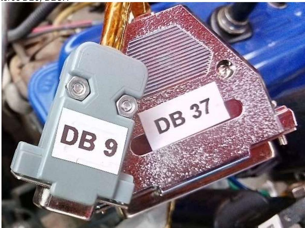
*Nota:* Armado de las tapas de los conectores DB9 y DB37
