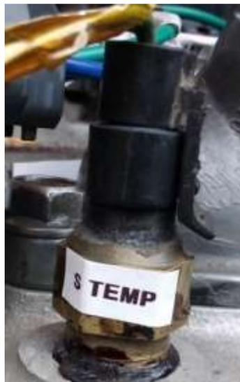
*Nota:* Conexión del sensor de temperatura ubicado en el colector de admisión con contacto con los conductos de refrigerante del radiador.
