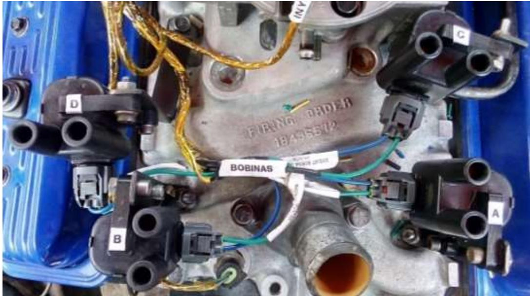
**Nota:** Montaje de bobinas y bases metálicas en el cuerpo de admisión.
