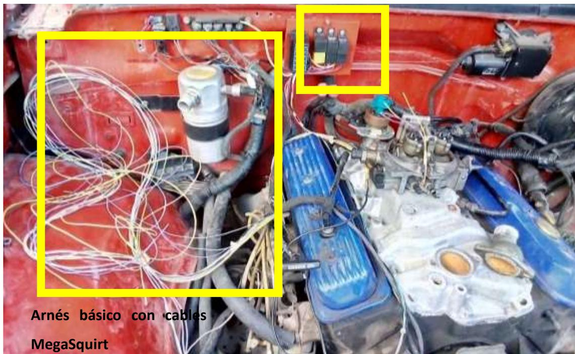
*Nota:* Montaje del arnés básico con el tablero de fusibles y relés en la parte superior del motor de la camioneta Chevrolet Silverado.
