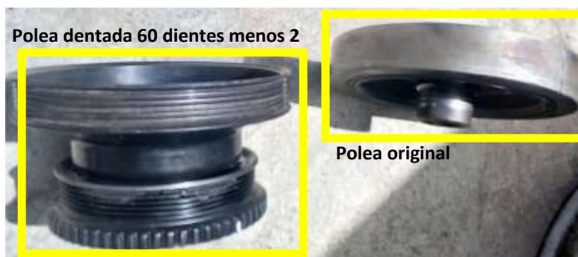
*Nota:* Reemplazo de la polea original por la polea dentada para el señor CKP.
