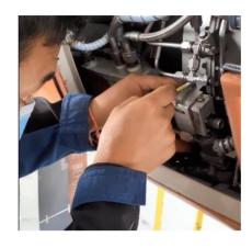
*Nota:* Fotografía obtenida durante el proceso del proyecto de tesis, ajustamiento del perno que está en la parte superior del compensador.
