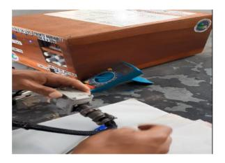
Nota: Fotografía obtenida durante el proceso del proyecto de tesis, verificación funcionamiento de la resistencia compensador que presenta un fallo de calibración.
