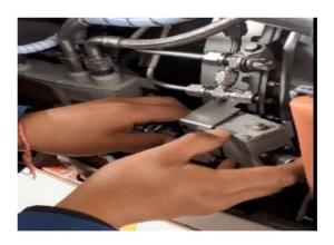
*Nota:* Fotografía obtenida durante el proceso del proyecto de tesis, colocación correcta del compensador.
