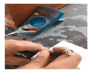
Nota: Fotografía obtenida durante proceso del proyecto de tesis, la resistencia de compensación EGT, número de pieza 897476. La rotación en sentido horario del tornillo de ajuste aumenta el número de ajuste y más (+°C (+°F)). El rango total de ajuste del tornillo a más o menos es de aproximadamente 12 vueltas.
