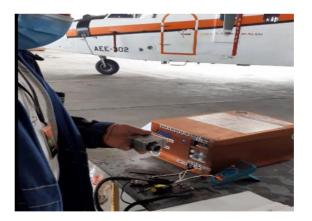
Nota: Fotografía obtenida durante proceso del proyecto de tesis del compensador con un setting 7 donde aparenta una des calibración, numero de pieza 897476 se procede a su respectivo chequeo.
