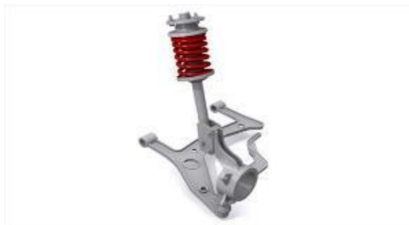
Sistema de Suspensión McPherson
