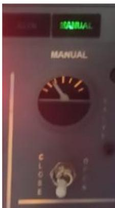
*Nota.* En la imagen se observa el indicador de la válvula de salida cerrada y el interruptor manual en CLOSE. Tomada del simulador de vuelo Boeing 737 de la Universidad de las Fuerzas Armadas ESPE.
