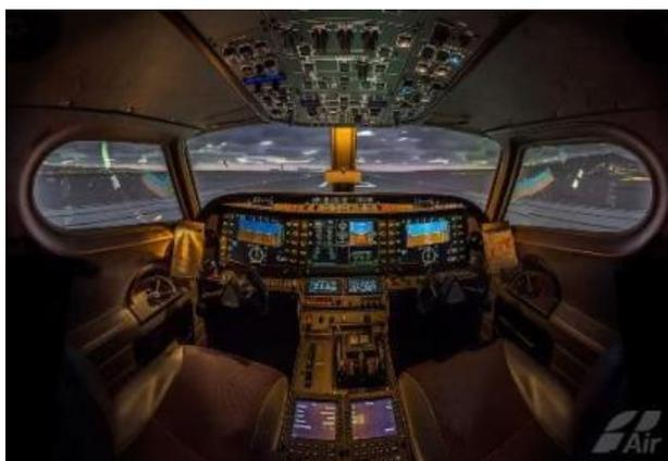
*Nota.* En la imagen se observa una cabina de un simulador de vuelo FFS (Full Flight Simulator) Simulador de vuelo completo. Tomada de One Air (Snapshot, s. f.)
