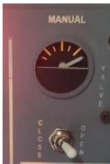
*Nota.* En la imagen se observa el indicador de la válvula de salida abierta y el interruptor manual en OPEN. Tomada del simulador de vuelo Boeing 737 de la Universidad de las Fuerzas Armadas ESPE.
