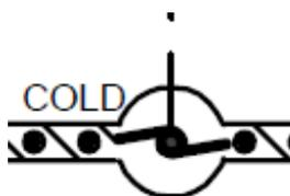
*Nota.* El gráfico representa el control del aire frío que va a pasar directo ya que se puede controlar en modo manual y automático. Tomado de (ATA 21 AIR CONDITIONING.pdf, s. f.)
