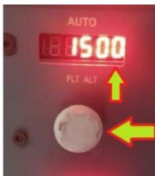
*Nota.* En la imagen se observa una altitud de 1500 ft ya que el aeropuerto en el cual se encuentra la aeronave está a 1000 ft, lo cual cumple con la disposición de 500 pies sobre la altitud de campo. Tomada del simulador de vuelo Boeing 737 de la Universidad de las Fuerzas Armadas ESPE.
