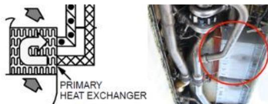
*Nota.* EL gráfico representa el primer intercambiador de calor primario, por el cual pasa la purga del aire del motor. Tomado de (*ATA 21 AIR CONDITIONING.pdf*, s. f.)
