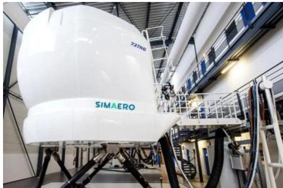
*Nota.* En la imagen se observa un simulador de vuelo de nivel D FFS (Full Flight Simulator). Tomado de SimAero de Egipto.
