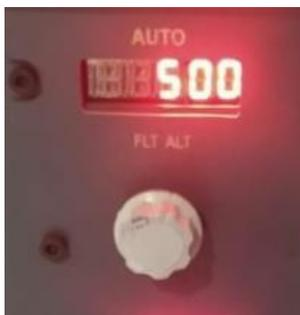
*Nota. En la imagen se observa una altitud de 500 ft ya que el aeropuerto en el cual se encuentra la aeronave está a 1000 ft, lo cual cumple con la disposición de 500 pies por debajo de la altitud de campo. Tomada del simulador de vuelo Boeing 737 de la Universidad de las Fuerzas Armadas ESPE.*
