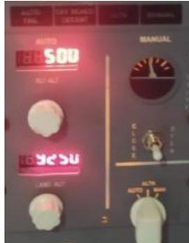
*Nota.* En la imagen se observa las luces apagadas y la válvula de salida abierta. Tomada del simulador de vuelo Boeing 737 de la Universidad de las Fuerzas Armadas ESPE.
