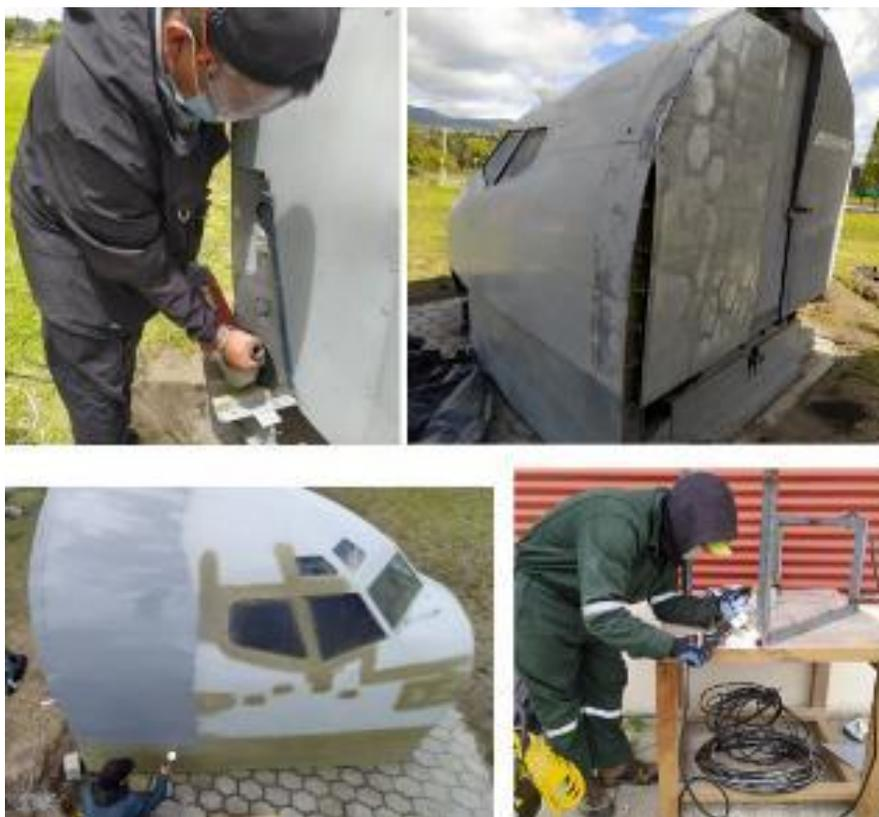
*Nota.* En las imágenes se observan el proceso de rehabilitación a la cual es sometido el simulador de vuelo para recuperar su estructura, en la cual se impermeabiliza, se suelda, se pinta, se masilla el chasis del simulador. Tomadas en la Universidad de la Fuerzas Armadas ESPE extensión Latacunga, febrero 2021.
