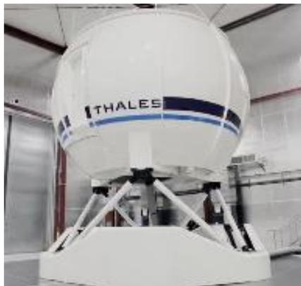
*Nota.* En la imagen se observa un simulador de nivel B el modelo AW-139. Tomado del simulador FFS Nivel B en Qatar.
