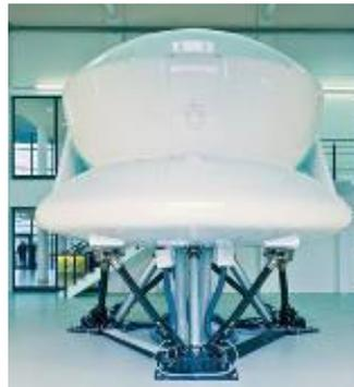
*Nota.* En la imagen se observa un simulador de vuelo nivel C el modelo Cessna Citation CJ1 525A. Tomada de Cessna en Estados Unidos.
