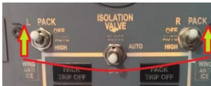
*Nota.* En la imagen se observan los selectores L y R PACK de tres posiciones en OFF. Tomada del simulador de vuelo Boeing 737 de la Universidad de las Fuerzas Armadas ESPE.
