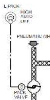
*Nota.* El gráfico representa el interruptor en cabina en el panel 5, controla el flujo del aire neumático. Tomado de (ATA 21 AIR CONDITIONING.pdf, s. f.)
