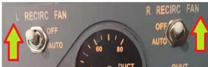
*Nota.* En la imagen se observan los selectores de dos posiciones RECIRC FAN en OFF. Tomada del simulador de vuelo Boeing 737 de la Universidad de las Fuerzas Armadas ESPE.
