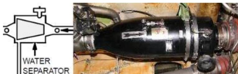
*Nota.* El gráfico representa la máquina del separador de agua el mismo que retira del sistema todo tipo de agua y humedad. Tomado de (*ATA 21 AIR CONDITIONING.pdf*, s. f.)
