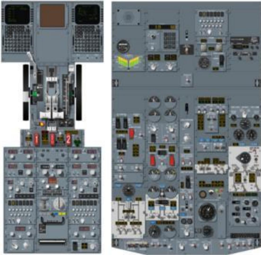
*Nota.* En la imagen se observa el panel central y overhead sucesivamente en los cuales se encuentran palancas y botones para activar baterías generadores, encender motores, activar la potencia en motores comunicación aire acondicionado y presurización.
