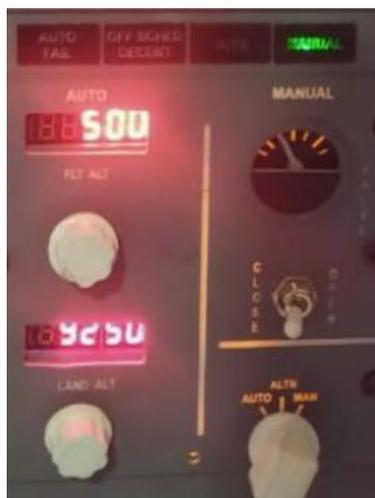
*Nota.* En la imagen se observa la luz de manual encendida y el selector en posición MAN (Manual). Tomada del simulador de vuelo Boeing 737 de la Universidad de las Fuerzas Armadas ESPE.
