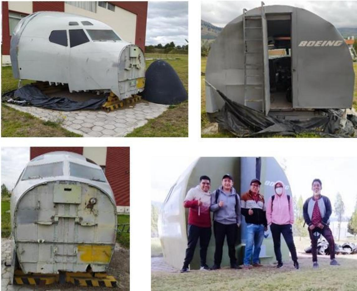
*Nota.* En las imágenes se observa el inicio del proceso de rehabilitación a la cual va a ser sometido el simulador de vuelo, se observa una estructura en deterioro con un poco de corrosión. Tomadas en la Universidad de la Fuerzas Armadas ESPE extensión Latacunga, noviembre 2020.
