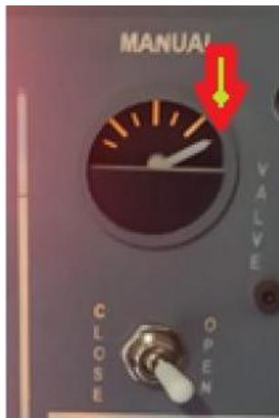
*Nota.* En la imagen se observa el indicador de la válvula de salida cerrada. Tomada del simulador de vuelo Boeing 737 de la Universidad de las Fuerzas Armadas ESPE.
