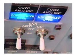
3. Cuando el interruptor "Eng Anti-Ice" se coloca en OFF, las luces de "valvula de capó abierta" se enciende brillantemente para indicar que la válvula está en tránsito, luego se apaga para indicar que la válvula está cerrada.
