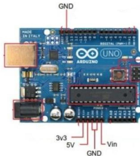
*Nota.* La figura representa los pines de alimentación del Arduino Uno. Tomado de ingeniería Mecafénix en 2017.
