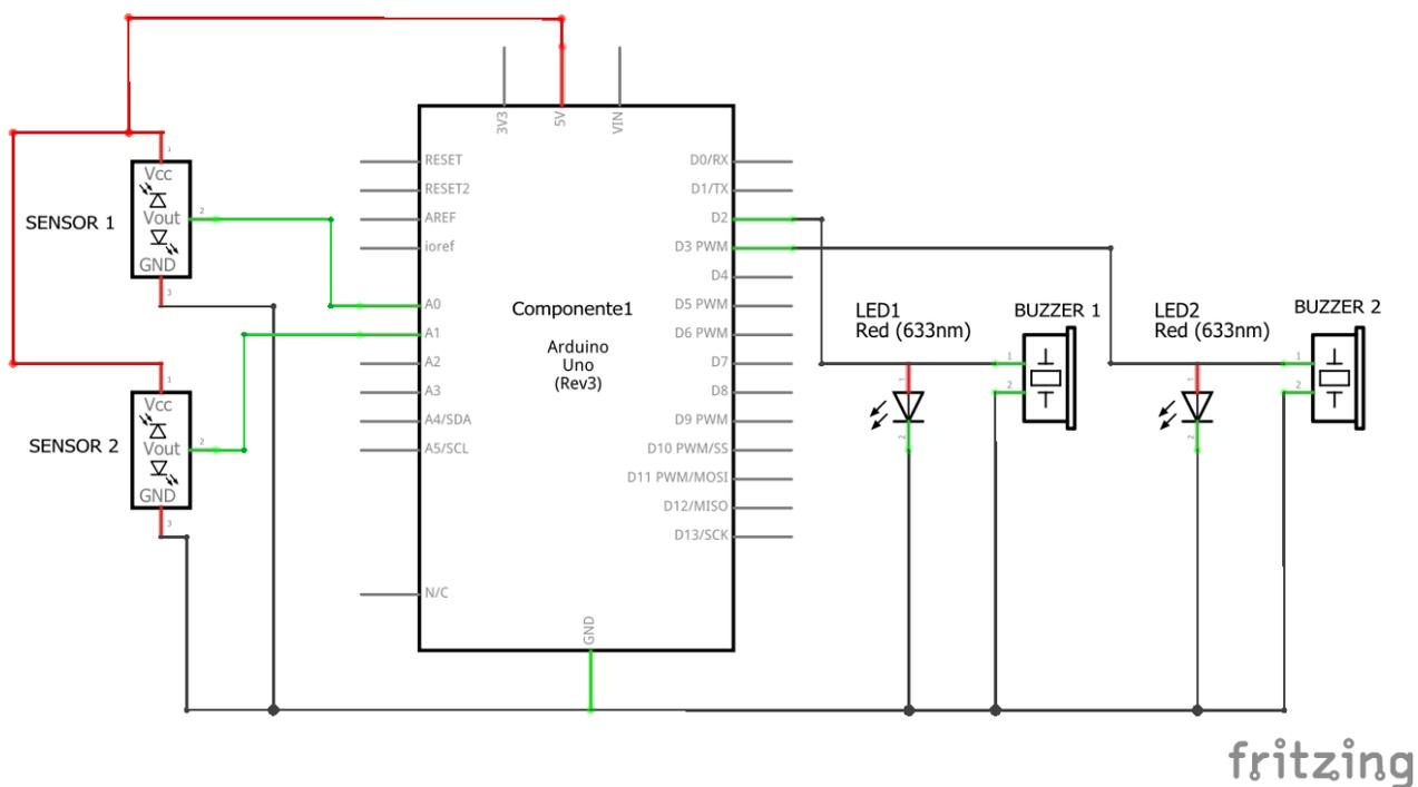
*Nota.* La figura representa el diagrama eléctrico esquemático de los sensores de movimiento.
