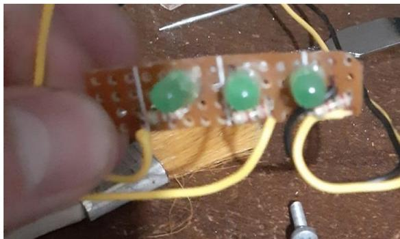
*Nota.* La figura representa el módulo de luces led para el indicador visual.
