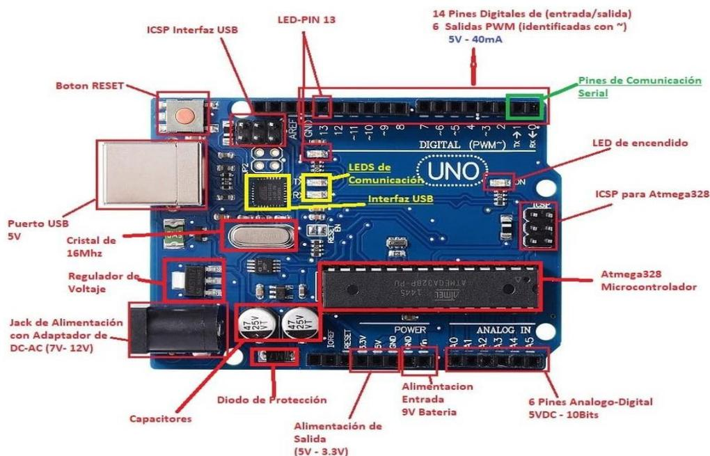
Nota. La figura representa las partes de la placa Arduino Uno. Tomado de.ingeniería Mecafenix 2017
