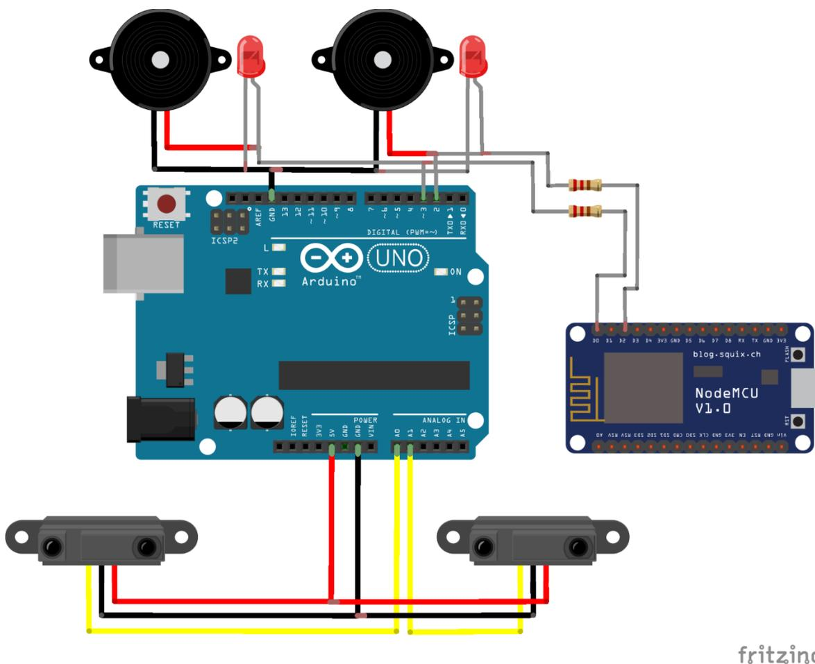
*Nota.* La figura representa el diagrama eléctrico físico de la conexión el Arduino Uno con el NodeMCU.
