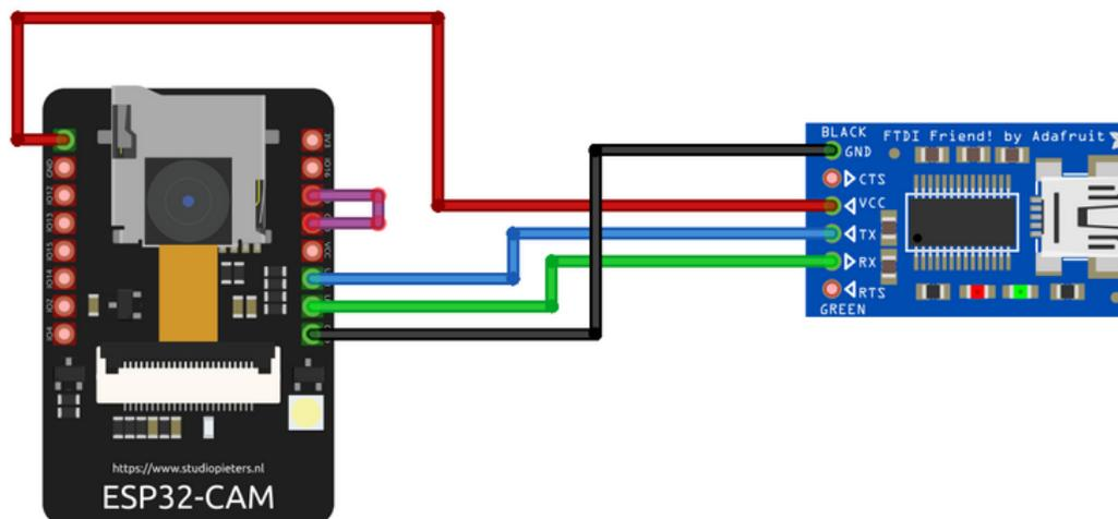
*Nota.* La figura representa la conexión del microcontrolador con el convertor USB a TTL para la comunicación entre la placa con el ordenador. Tomado de (Viral Science).
