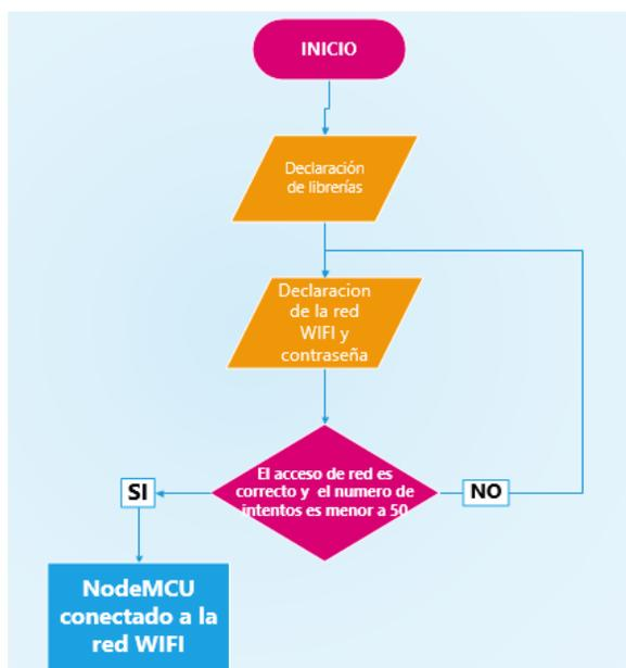
*Nota.* La figura representa el diagrama de bloques de la conexión del microcontrolador con una red WIFI.
