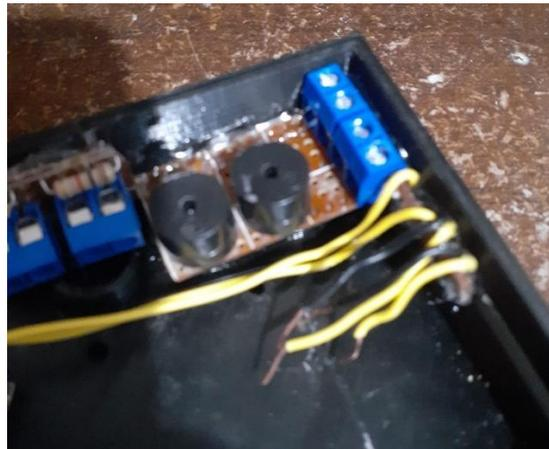
*Nota.* La figura representa los conectores, y el módulo de la conexión de los buzzers para el indicador auditivo.
