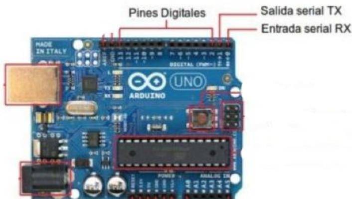
*Nota.* La figura representa los pines digitales y de comunicación del Arduino Uno. Tomado de ingeniería Mecafenix en 2017
