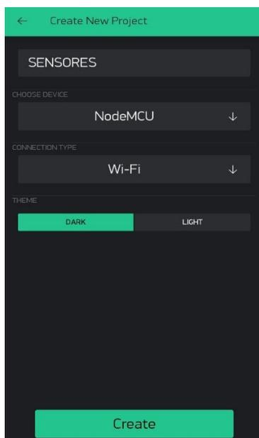
*Nota.* La figura representa la creación de un nuevo proyecto en la aplicación Blynk para recibir notificaciones del NodeMCU.
