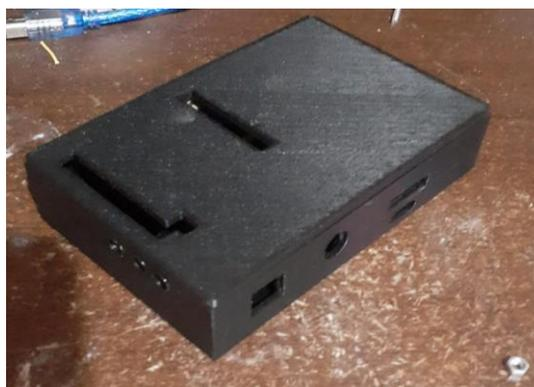
*Nota.* La figura representa la caja impresa en 3D donde se va a instalar el sistema.
