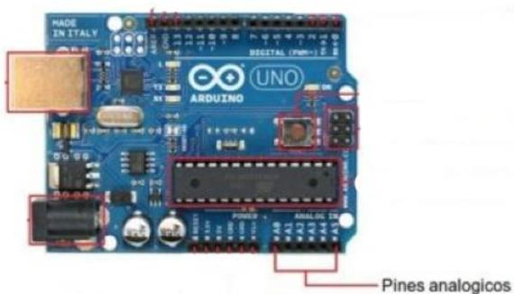
*Nota.* La figura representa los pines analógicos del Arduino Uno. Tomado de ingeniería Meca fénix en 2017.
