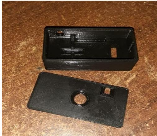
*Nota.* La figura representa la caja impresa en 3D donde se va instalar la placa ESP32-Cam.
