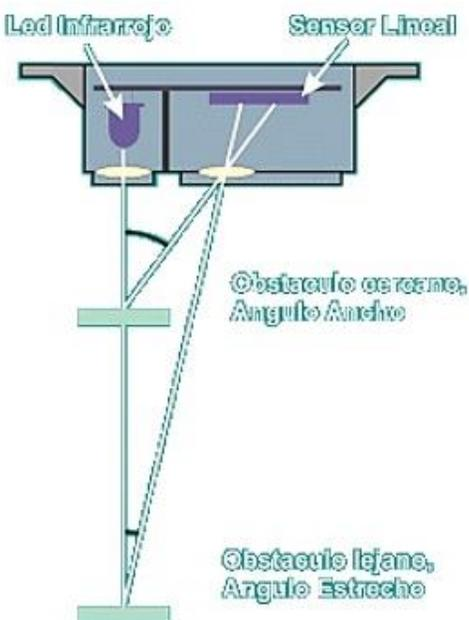
*Nota.* La figura representa las partes y el funcionamiento del sensor Sharp GP2Y0A21. Tomado de sitio web Naylamp en el año 2021.
