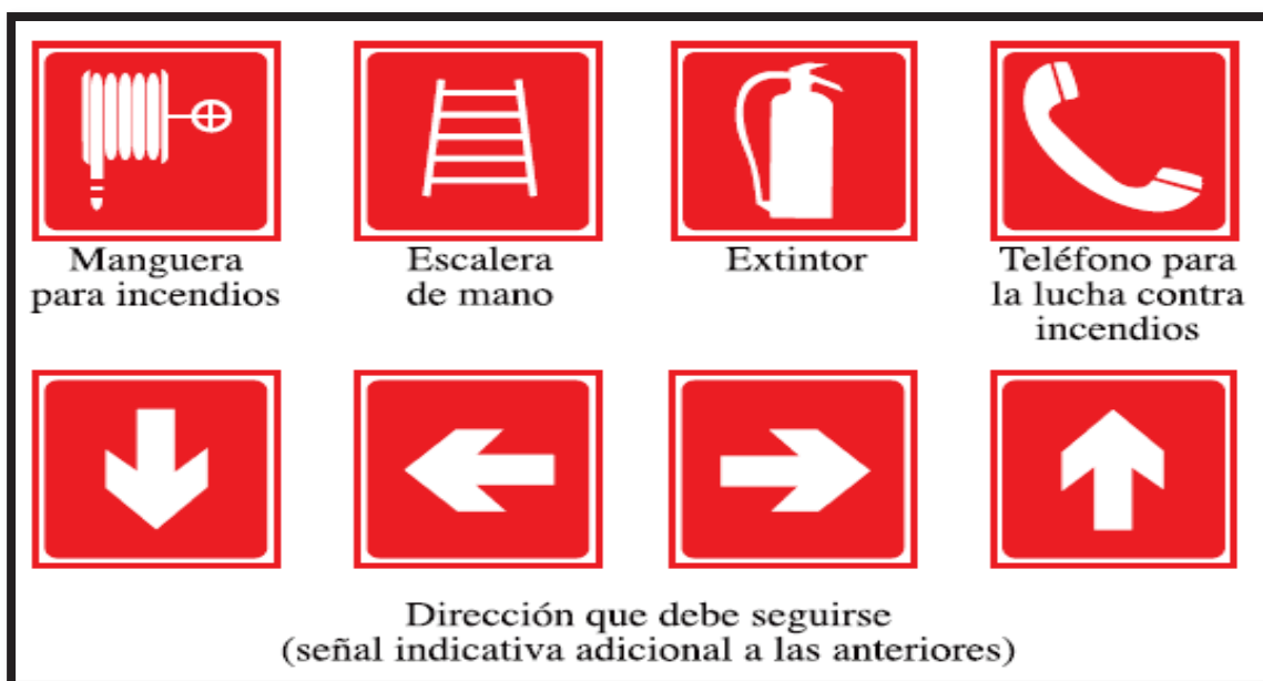
Figura: 2.4 Señales Relativas a los Equipos de Lucha Contra Incendios.
