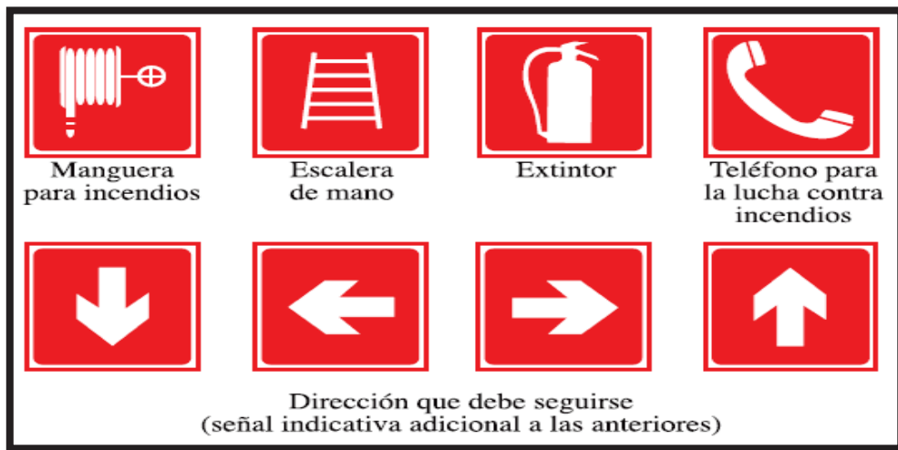
Figura: 3.4 Señales relativas a los equipos de lucha contra incendios
