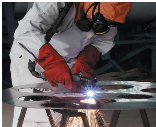
**Figura 8** Soldadura por plasma
