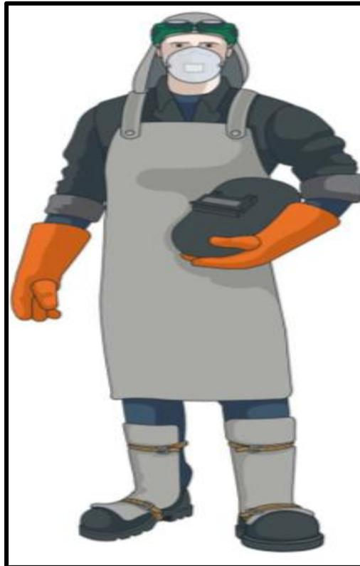
**Figura 20** Equipos de protección para Soldadura
