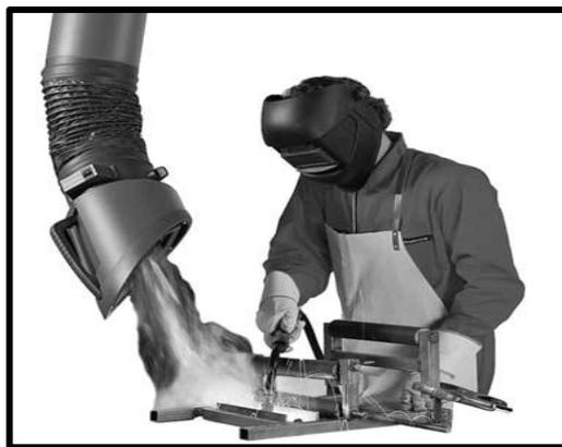
**Figura 19** Ventilación automática
