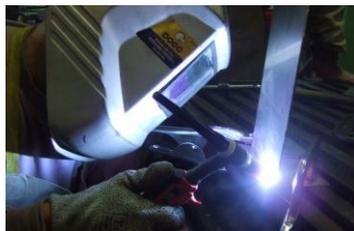
**Figura 14** Radiación producida por Soldadura
