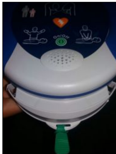
Figura 33 Colocación del padpak
