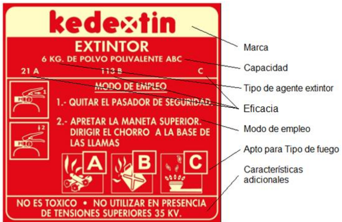
Figura 26 Placa de identificación de extintores
