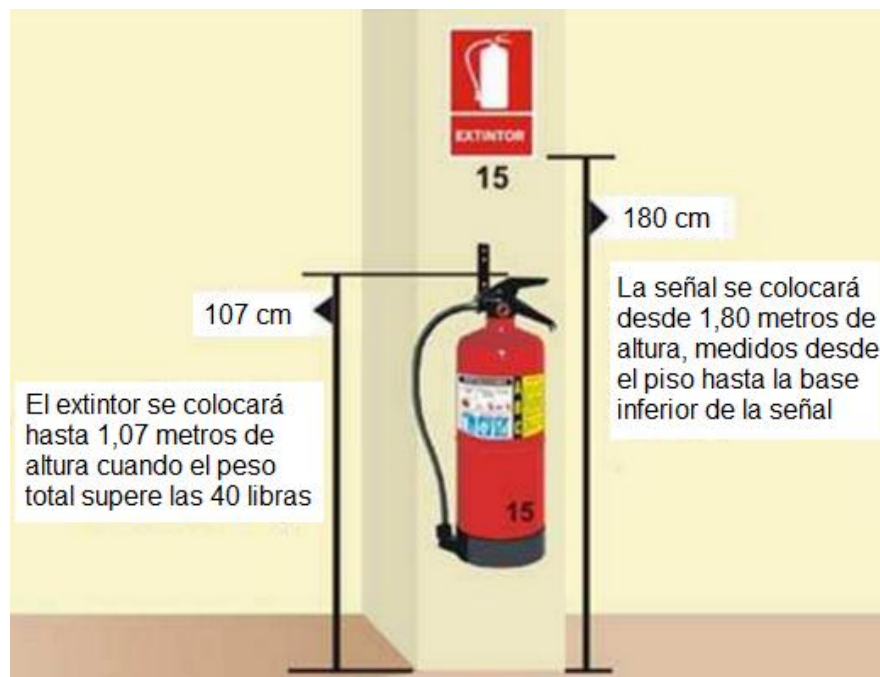
Figura 39 Instalación de extintor de más de 40 libras
