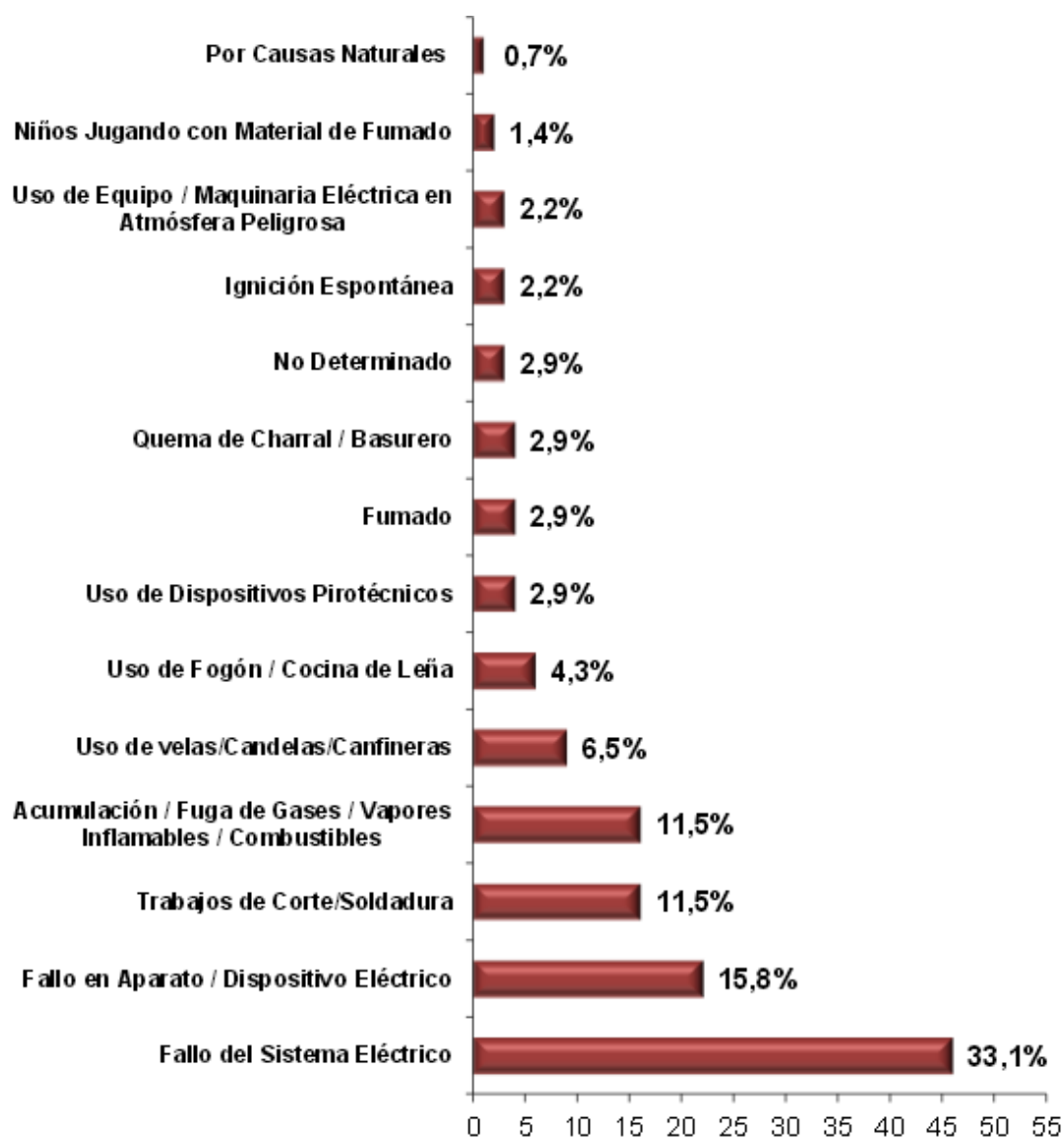
Figura 2 Clasificación de incendios investigados por causa
