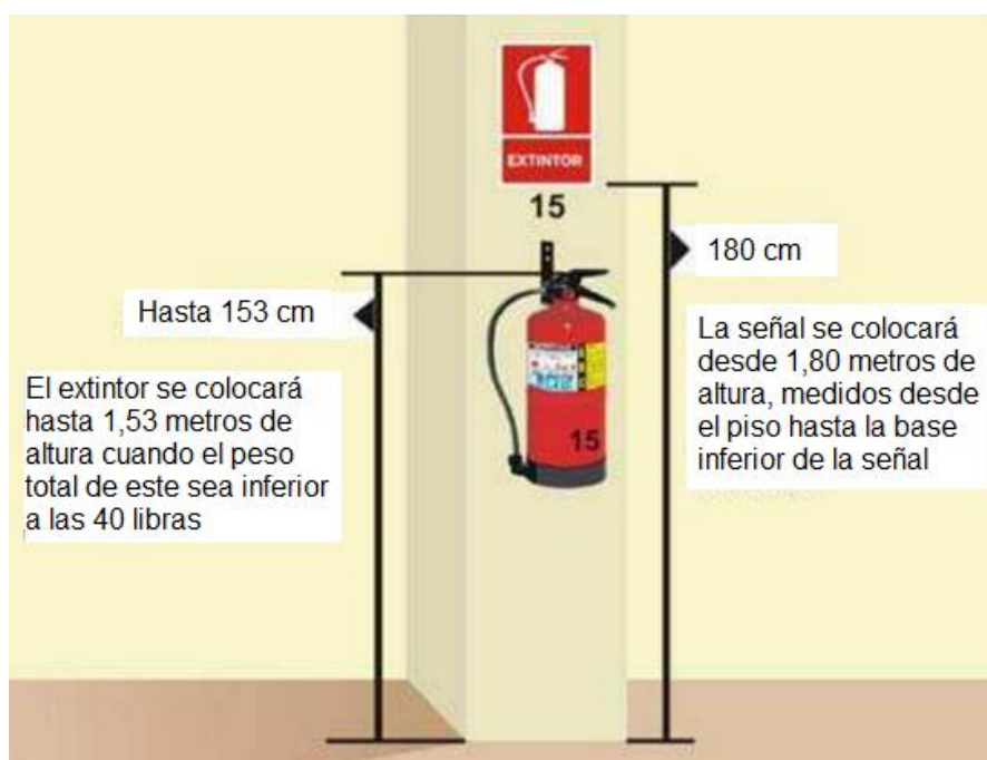
Figura 38 Instalación de extintor de hasta 40 libras
