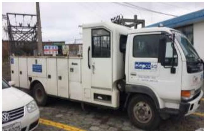
**Figura 14 Camión de mantenimiento de redes**
