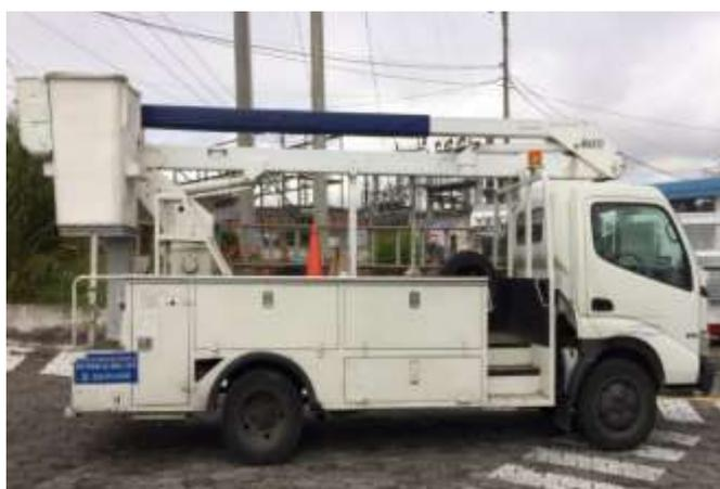
**Figura 10 Camión canasta de alumbrado público**
