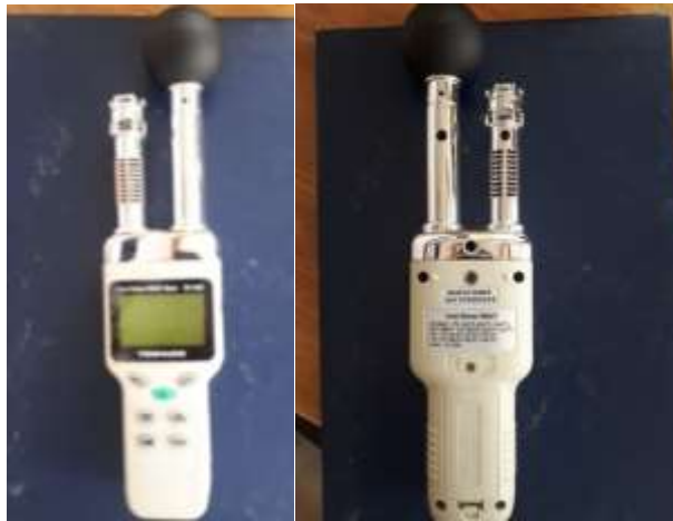
Figura 35 Medidor de Estrés Térmico
