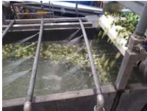
Figura 18 Lavadora Línea 1 Fuente: Investigación de campo
