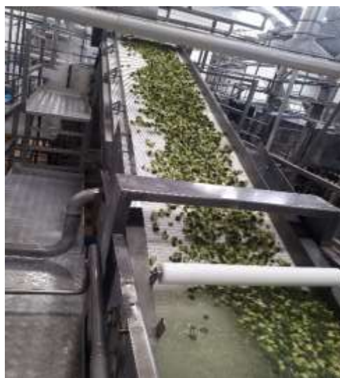
Figura 21 Cinta de ascenso y descenso del producto Fuente: Investigación de campo
