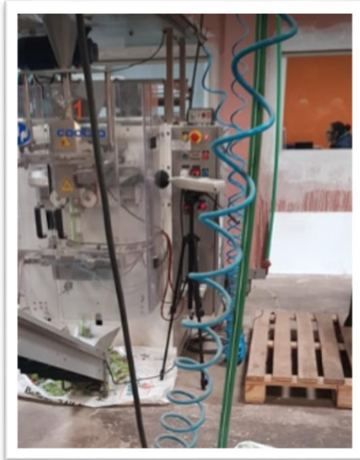
Medición de ruido maquina envasadora
