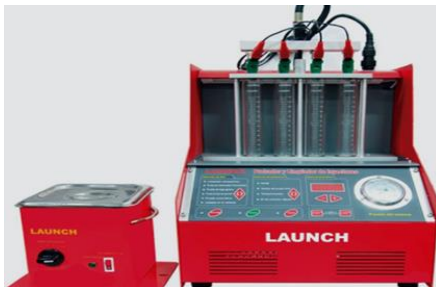
Figura 11 Maquina para limpieza de inyectores. Fuente: (Suarez, 2018).
