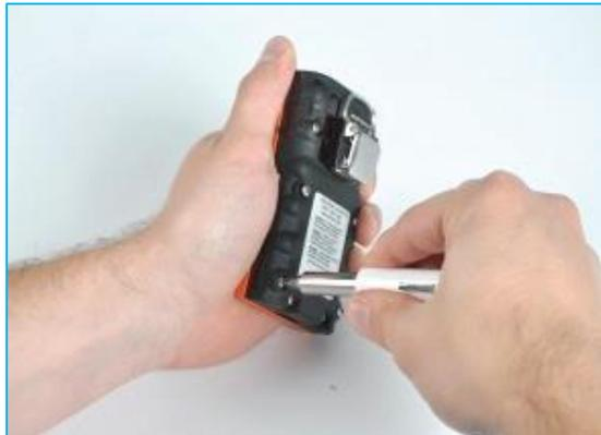
**Figura. 35** Asegurando batería
