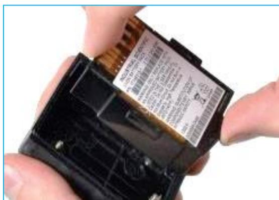
**Figura. 34** Batería de equipo multi-gas
