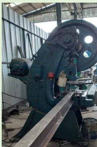
Cortar y aplanar aluminio, acero, ángulos, perfiles dependiendo de la matriz que se le coloque.
