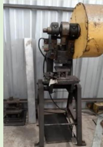
Cortar y aplanar aluminio, acero, ángulos, perfiles dependiendo de la matriz que se le coloque.
