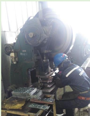
Cortar y aplanar aluminio, acero, ángulos, perfiles dependiendo de la matriz que se le coloque.
