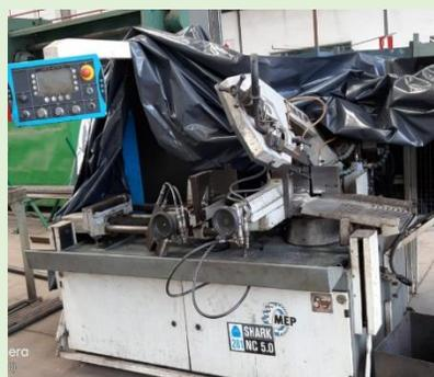
Cortar ángulos, platinas, planchas metálicas y varillas.
