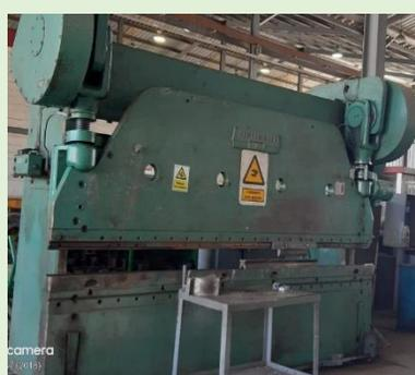
Doblar planchas metálicas, ángulos, varillas y perfiles.
