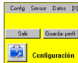
El botón Guardar perfil permite salir de la modalidad de configuración y vuelve a la pantalla de lecturas normales. Los cambios de configuración se guardan en el perfil actual.
