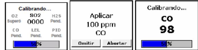
Al finalizar la calibración, la siguiente pantalla muestra los sensores que han superado la prueba, los marginales, los omitidos y los fallidos cuando los seis sensores están instalados. Todos los sensores aprobados deben pasar primero una comprobación cero.
