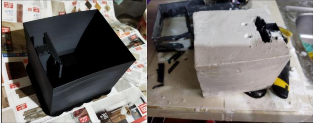
*Nota.* Se muestra la construcción de la caja de yeso con el molde en plástico PLA
