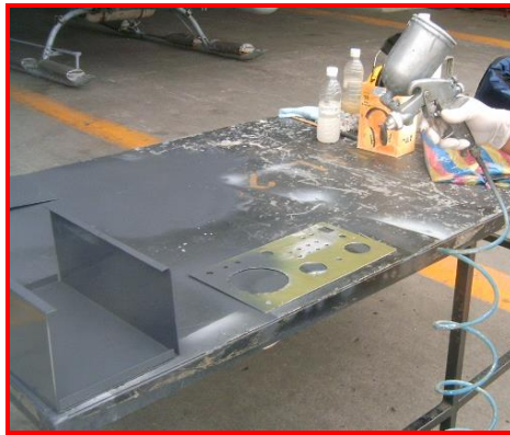
Figura 3.20 Pintura de la estructura.
