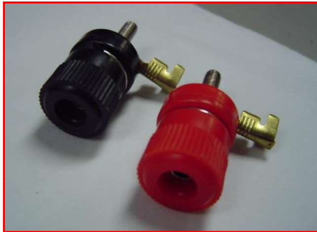
Figura 3.3 Jacks para entrada de voltaje.
