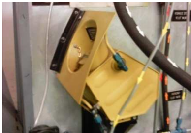
Fig.2.3: Reservorio hidráulico de emergencia Fuente: Investigación de campo
