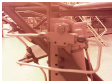
Fig. 3.12: Instalación de la válvula de lanzadera Fuente: Investigación de campo
