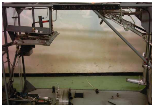
Figura 3.21 Banco didáctico del Sistema de Tren de Aterrizaje Principal del Avión T-33A
