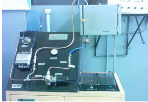
Figura 3.16 Banco didáctico del sistema de la micro bomba, bobina y antorcha del Sistema de Combustible
