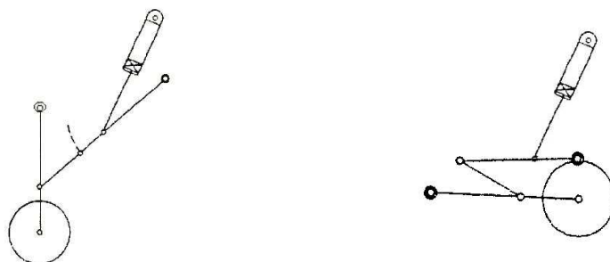
Fig. 2.41: Movimiento de extensión-retracción del tren auxiliar Fuente: Libro “Conocimientos básicos del avión”
