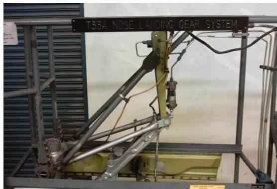
Figura 3.20 Banco didáctico del Sistema de Tren de Aterrizaje de Nariz del Avión T-33A
