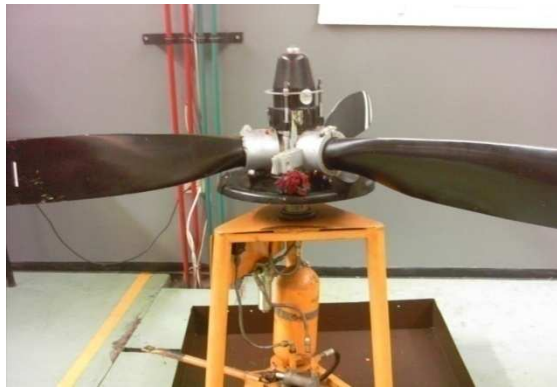
Figura 3.17 Banco de pruebas para evaluar ángulos de la hélice del Avión Twin- Other
