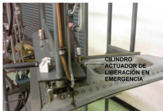
Fig.2.32: Cilindro actuador de emergencia de las compuertas Fuente: Investigación de campo
