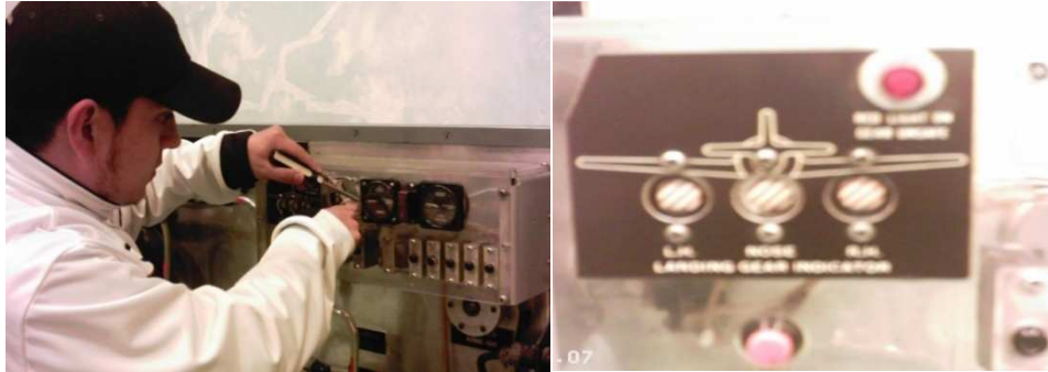
Fig. 3.16: Instalación del foco de la luz de advertencia Fuente: Investigación de campo
