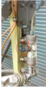
Fig. 3.3: Cilindro hidráulico de seguro arriba desconectado Fuente: Investigación de campo
