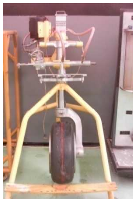
Figura 3.12 Maqueta didáctica del Steering del Avión Fokker F-28
