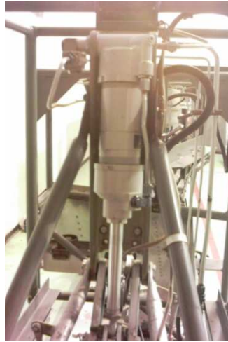
Fig. 3.11: Actuador hidráulico instalado Fuente: Investigación de campo
