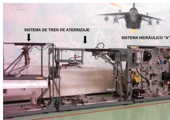
Fig. 2.28: Banco de simulación del tren de aterrizaje del avión T-33A Fuente: Investigación de campo
