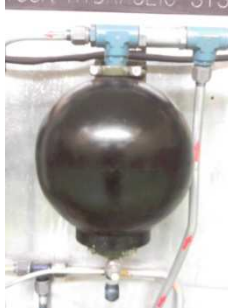
Fig. 3.6: Ausencia de cañería entre el acumulador y el manómetro Fuente: Investigación de campo
