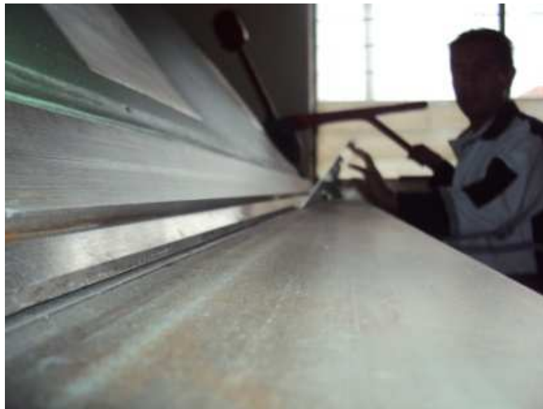
Figura 4.31. Doblado de la viga. Fuente: Investigación de Campo. Editado por: Andrés Balcázar.
