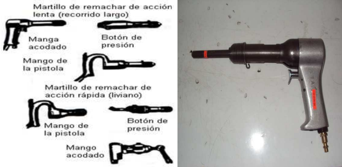
Figura 3.41. Pistolas remachadoras. Fuente: Investigación documental y de campo. Tomado de: Manual de la IAAFA y fotografías.
