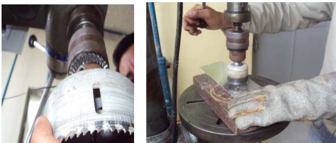
Figura 4.24. Perforación de los agujeros de aligeramiento. Fuente: Investigación de campo. Editado por: Andrés Balcázar.
