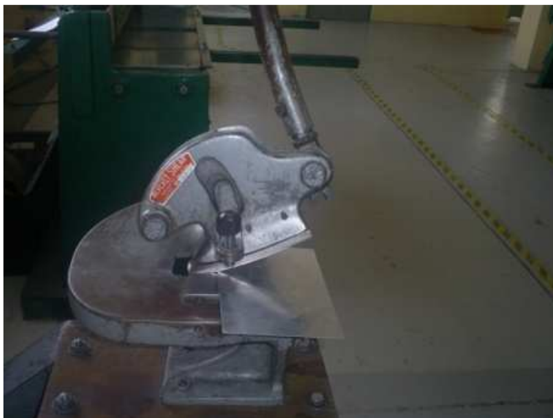
Figura 3.9. Cizalla manual o sin garganta. Fuente: Investigación de campo. Editado por: Andrés Balcázar.
