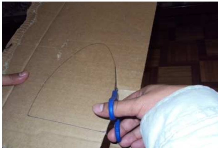
Figura 4.84. Recortado del molde de cartón. Fuente: Investigación de campo. Editado por: Andrés Balcázar.
