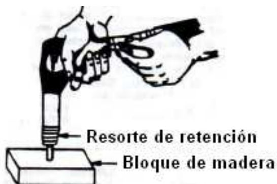
Figura 4.154. Ajuste de la pistola Remachadora en el Bloque de Madera.
