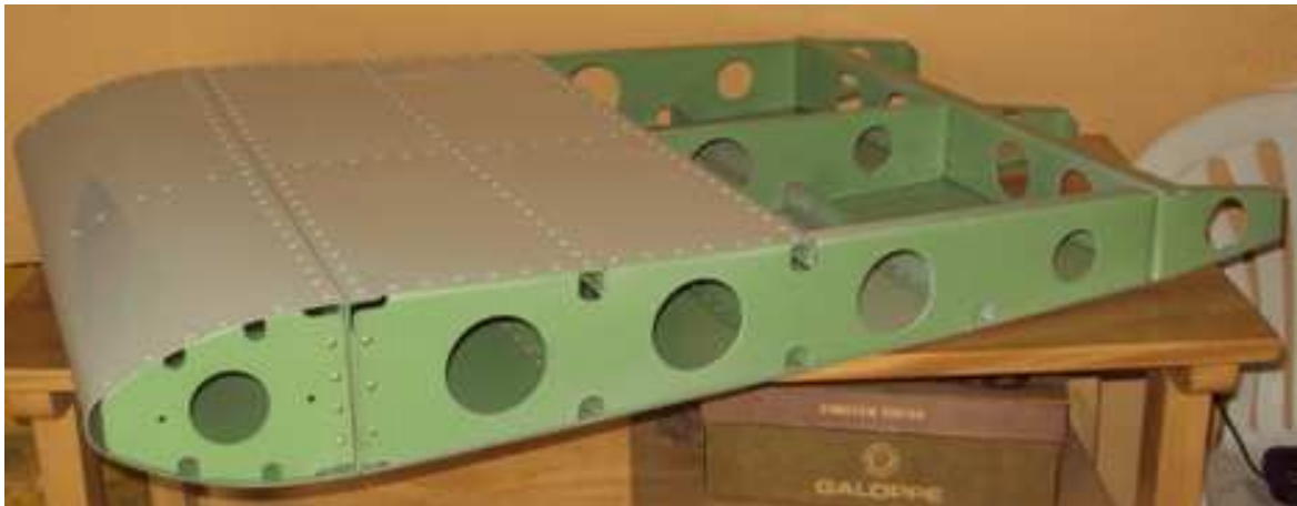
Figura 4.183. Prototipo estructural de ala terminado. Fuente: Investigación de campo. Editado por: Andrés Balcázar.
