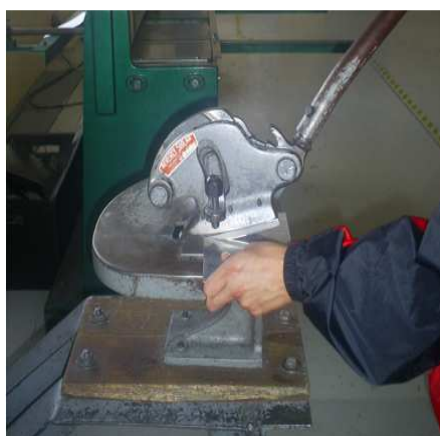
Figura 4.65. Corte con la cizalla manual o sin garganta. Fuente: Investigación documental y de campo. Tomado de: Manual de la IAAFA y fotografías.
