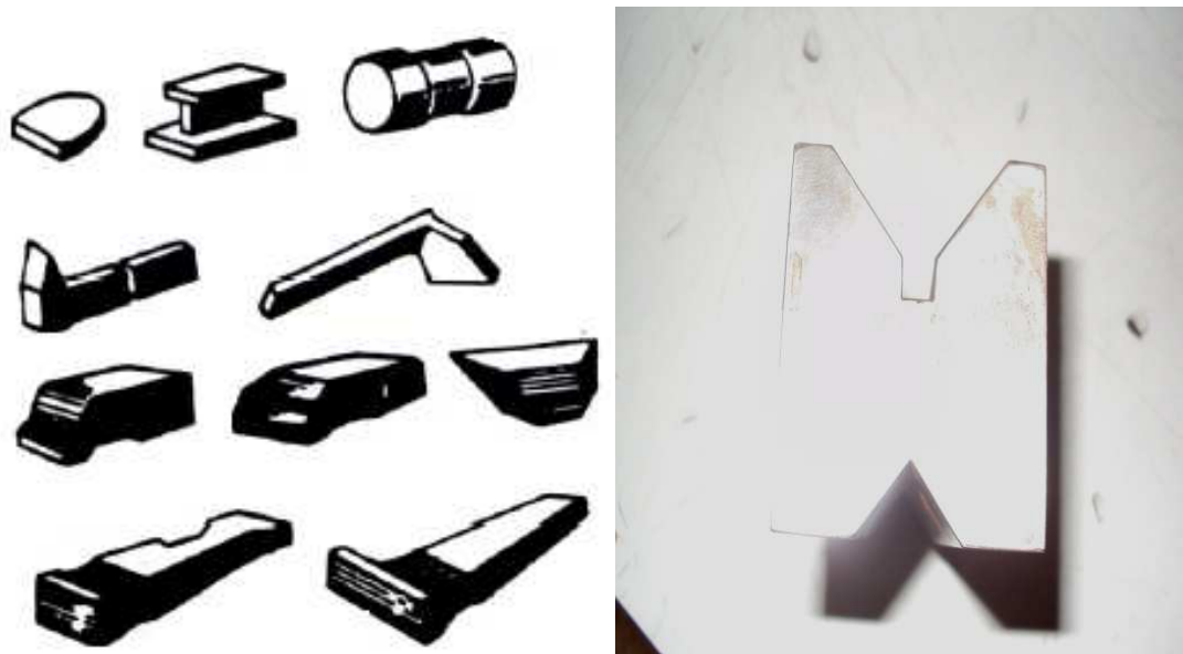
Figura 3.44. Barras contra remachadoras. Fuente: Investigación documental y de campo. Tomado de: Manual de la IAAFA y fotografías.
