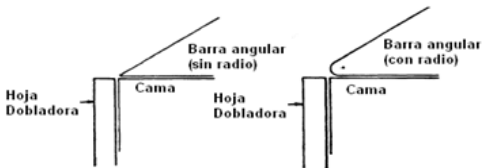
Figura 4.1. Quijadas Superiores de una Dobladora de Cornisa. Fuente: Investigación documental. Tomado de: Manual de la IAAFA.
