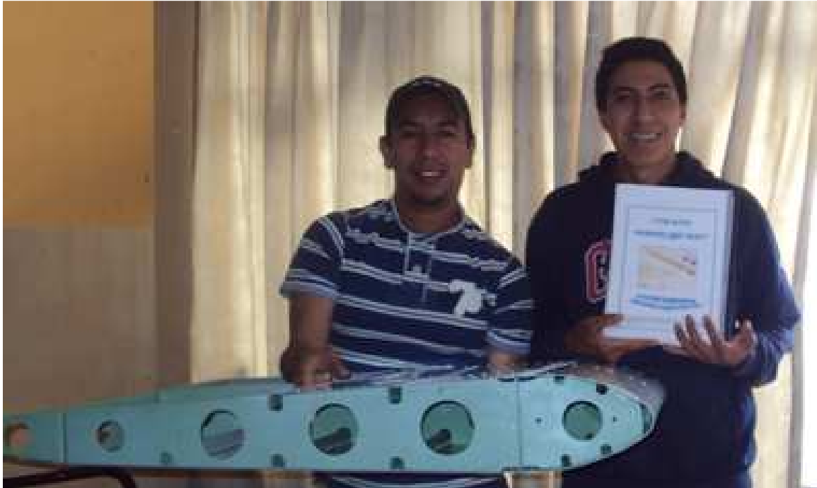
Figura 4.184. Prototipo estructural de ala terminado. Fuente: Investigación de campo. Editado por: Andrés Balcázar.
