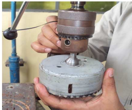
Figura 3.7. Instalación del conjunto de la broca de corona en el taladro de pedestal. Fuente: Investigación de campo. Editado por: Andrés Balcázar.
