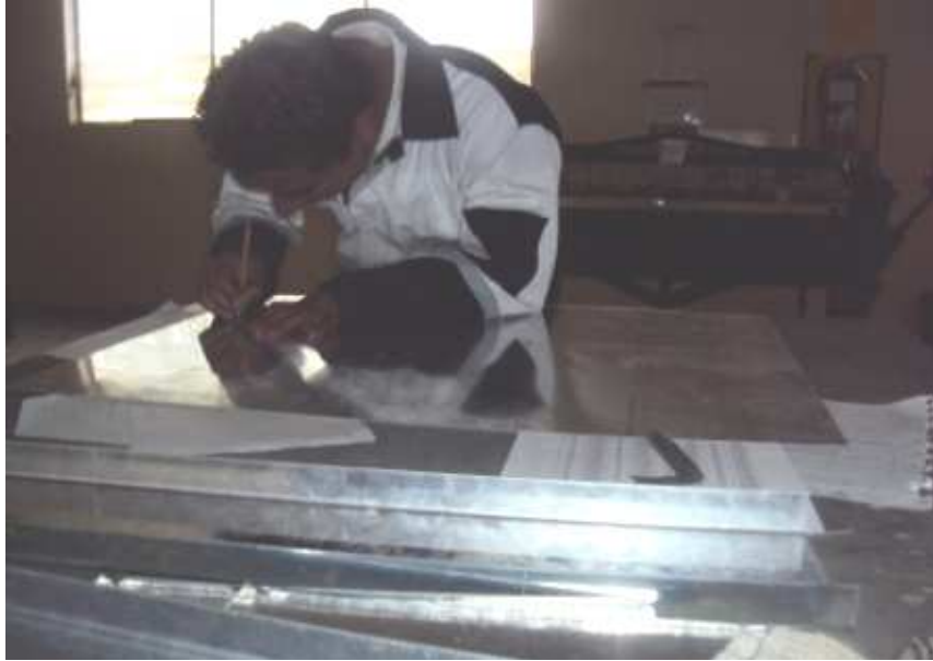
Figura 4.42. Trazado del patrón sobre la lámina. Fuente: Investigación de campo. Editado por: Andrés Balcázar.
