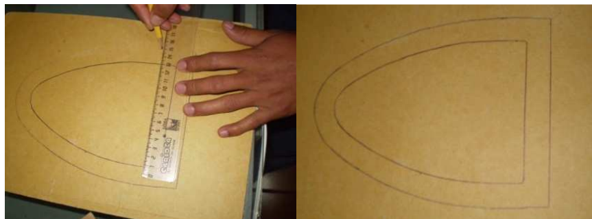
Figura 4.88. Trazado de las medidas de las pestañas en el molde de cartulina. Fuente: Investigación de campo. Editado por: Andrés Balcázar.
