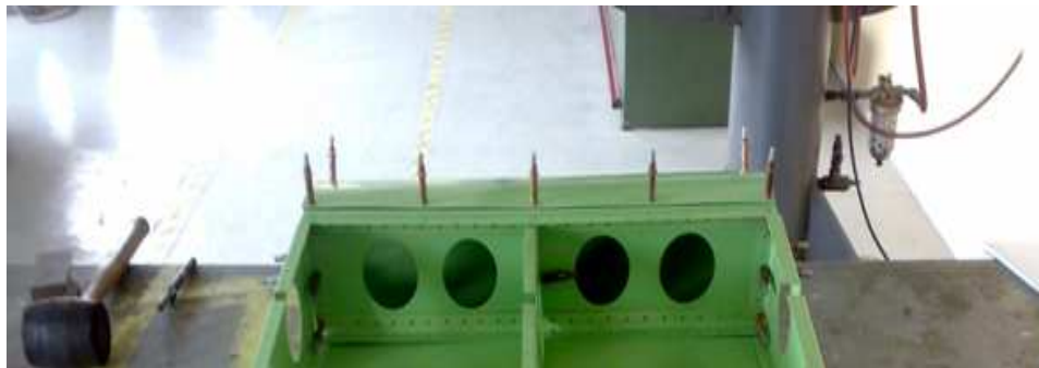
Figura 4.33. Viga del Borde de Ataque terminada. Fuente: Investigación de Campo. Editado por: Andrés Balcázar.
