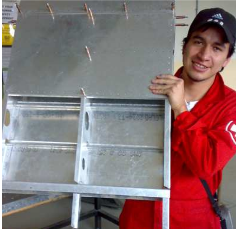
Figura 4.141. Revestimiento, larguerillos y pestaña de la viga del borde de ataque taladradas.
