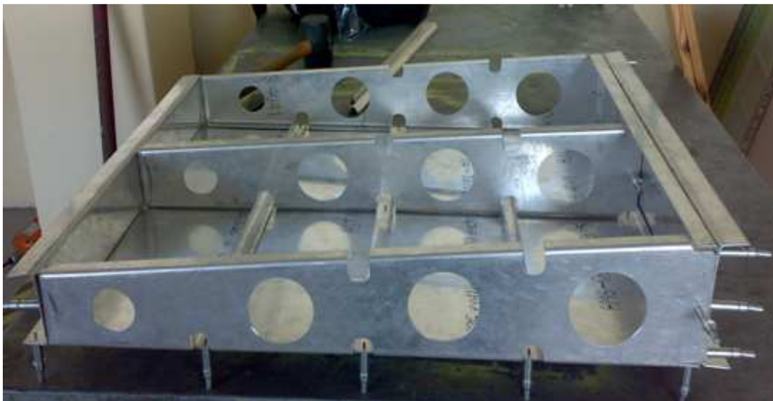
Figura 4.133. Partes ubicadas para taladrar.
