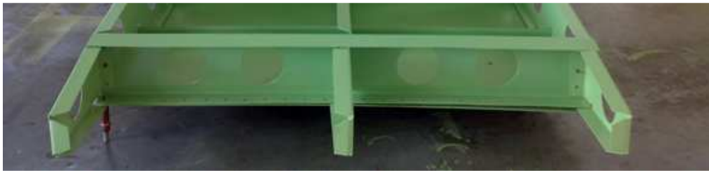
Figura 4.25. Viga del Borde de Salida terminada. Fuente: Investigación de Campo. Editado por: Andrés Balcázar.
