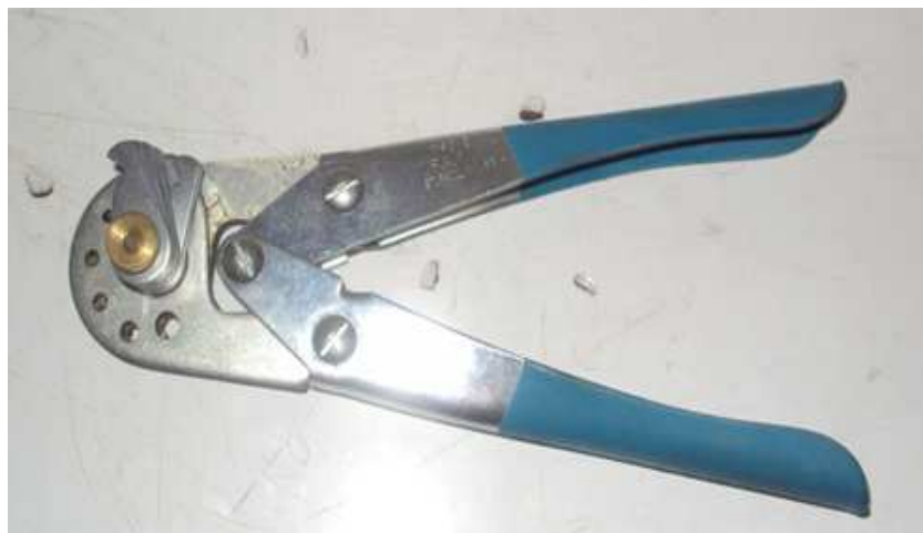
Figura 3.39. Cortadora de Remaches. Fuente: Investigación documental y de campo. Tomado de: Manual de la IAAFA y fotografías.
