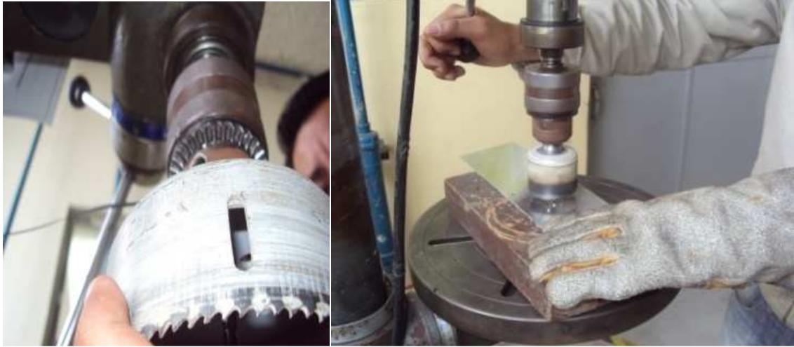
Figura 4.32. Perforación de agujeros de aligeramiento. Fuente: Investigación de campo. Editado por: Andrés Balcázar.
