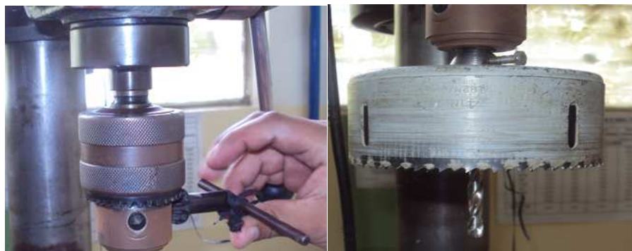
Figura 3.8. Ajuste con la llave de mandril. Fuente: Investigación de campo. Editado por: Andrés Balcázar.
