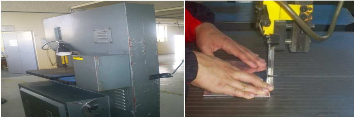
Figura 3.10. Sierra para cortar contornos de metal. Fuente: Investigación de campo. Editado por: Andrés Balcázar.
