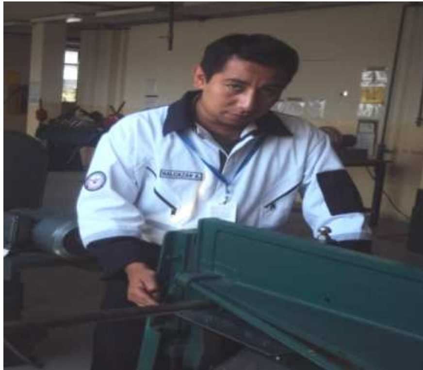
Figura 4.48. Corte de la lámina en la cizalla hidráulica. Fuente: Investigación de campo. Editado por: Andrés Balcázar.
