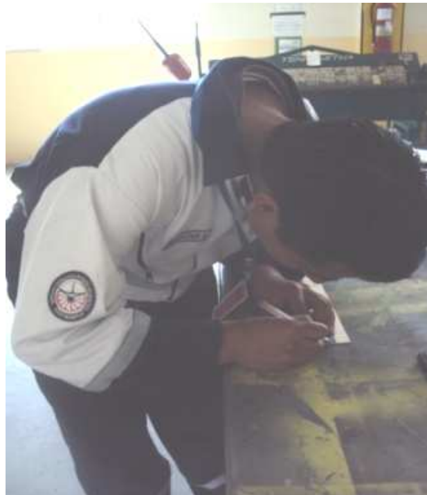
Figura 4.29. Trazado sobre la lámina. Fuente: Investigación de Campo. Editado por: Andrés Balcázar.
