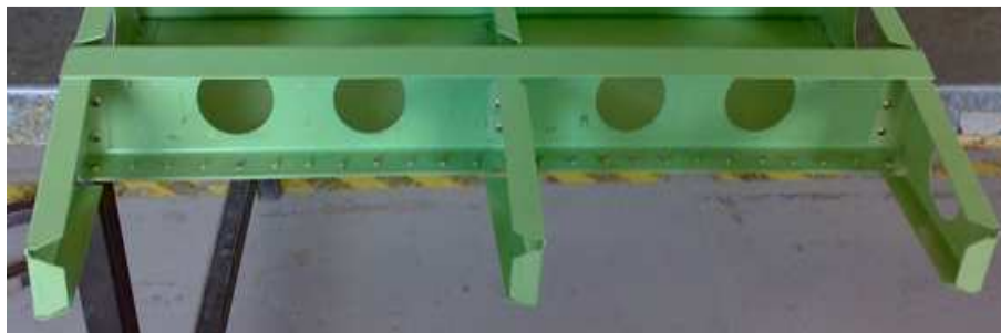
Figura 4.179. Partes traseras de las costillas remachadas. Fuente: Investigación de campo. Editado por Andrés Balcázar.
