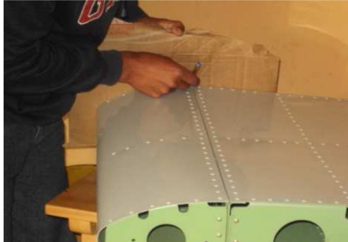
Figura 4.83. Trazado del molde de la parte delantera de la costilla sobre el cartón. Fuente: Investigación de campo. Editado por: Andrés Balcázar.
