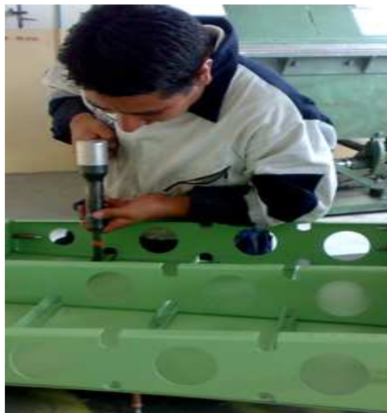
Figura 4.174. Remachado de las partes.
