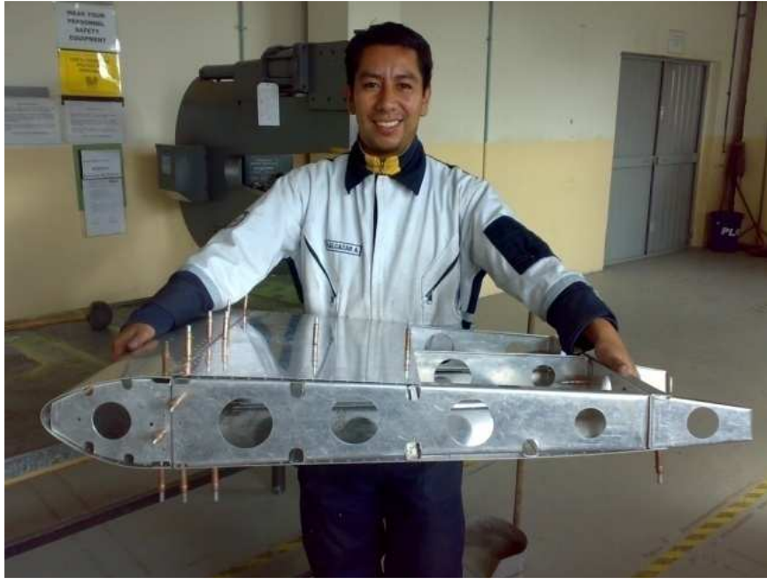
Figura 4.148. Partes ensambladas con clecos. Fuente: Investigación de campo. Editado por: Andrés Balcázar.
