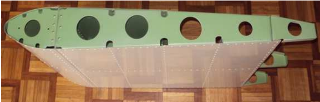
Figura 4.182. Prototipo estructural de ala terminado. Fuente: Investigación de campo. Editado por: Andrés Balcázar.
