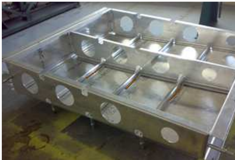
Figura 4.125. Señalamiento de las ubicaciones de los larguerillos en el revestimiento. Fuente: Investigación de campo. Editado por: Andrés Balcázar.
