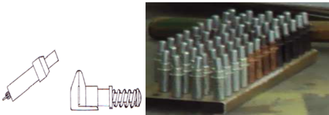
Figura 3.34. Tipos de Sujetadores Clecos. Fuente: Investigación documental y de campo. Tomado de: Manual de la IAAFA y fotografías.
