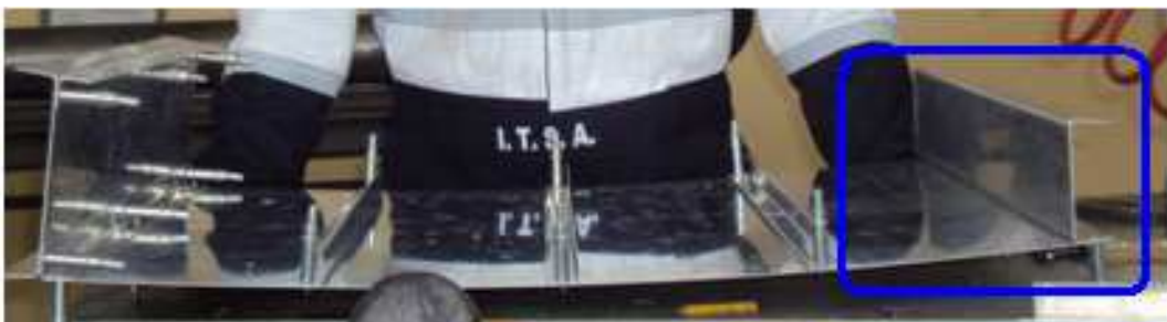
Figura 4.55. Ubicación de la viga de borde de salida. Fuente: Investigación de campo. Editado por: Andrés Balcázar.
