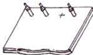
Figura 3.38. Varios Clecos Instalados. Fuente: Investigación documental. Tomado de: Manual de la IAAFA.
