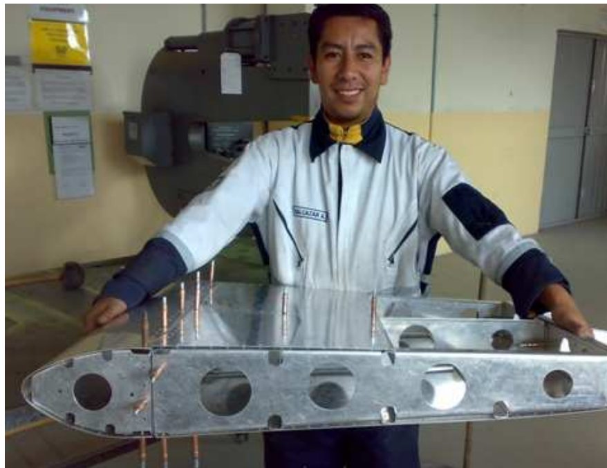
Figura 4.143. Partes sujetadas con clecos.
