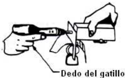
Figura 4.155. Posición de la Pistola Remachadora y de la Barra Contra-remachadora.
