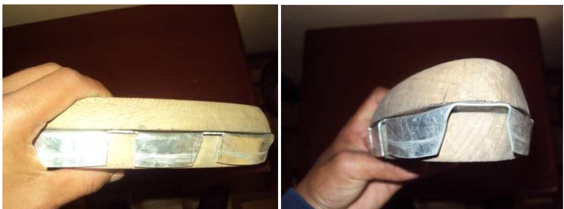
Figura 4.104. Doblado de las pestañas en el molde. Fuente: Investigación de campo. Editado por: Andrés Balcázar.
