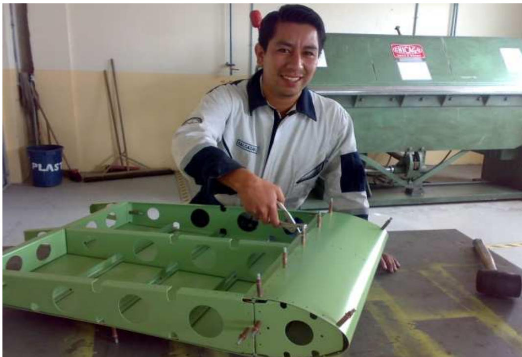
Figura 4.176. Perfil alar sujetado con clecos. Fuente: Investigación de campo. Editado por: Andrés Balcázar.
