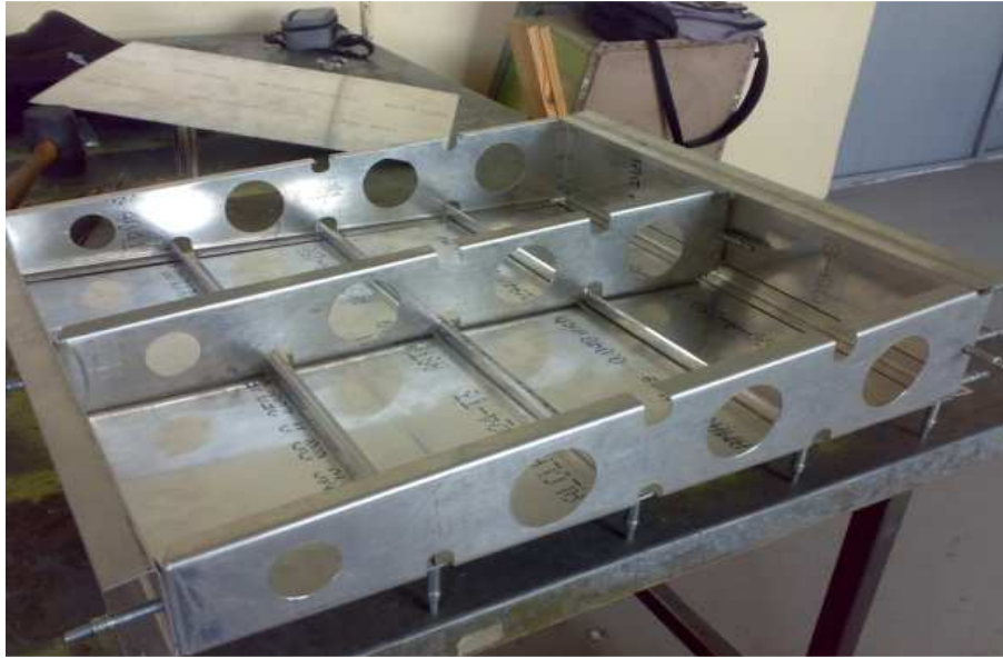
Figura 4.135. Ubicación de las partes intermedias de las costillas para taladrar. Fuente: Investigación de campo. Editado por: Andrés Balcázar.
