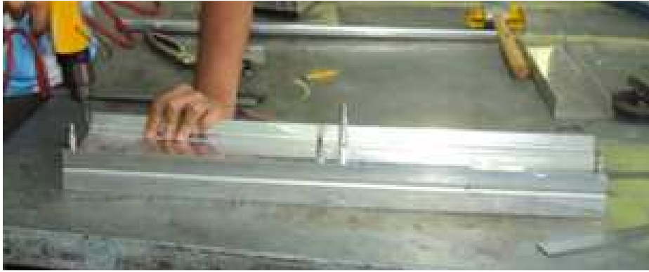
Figura 4.45. Taladrado de los orificios en las pestañas y viga del borde de ataque.
