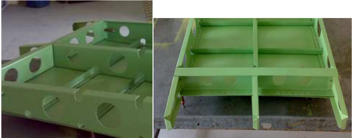
Figura 4.178. Partes traseras de las costillas sujetadas con clecos. Fuente: Investigación de campo. Editado por: Andrés Balcázar.
