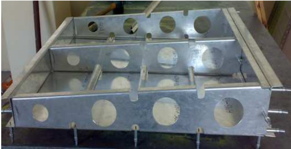
Figura 4.124. Larguerillos y partes intermedias de las costillas sobrepuestas. Fuente: Investigación de campo. Editado por: Andrés Balcázar.
