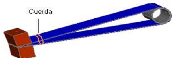
Figura 4.79. Perfil alar sujetado para darle el ángulo. Fuente: Investigación de campo y documental. Elaborado y editado por: Andrés Balcázar.
