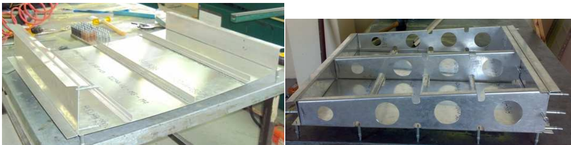
Figura 4.172. Partes sujetadas con clecos para proceder a remachar.
