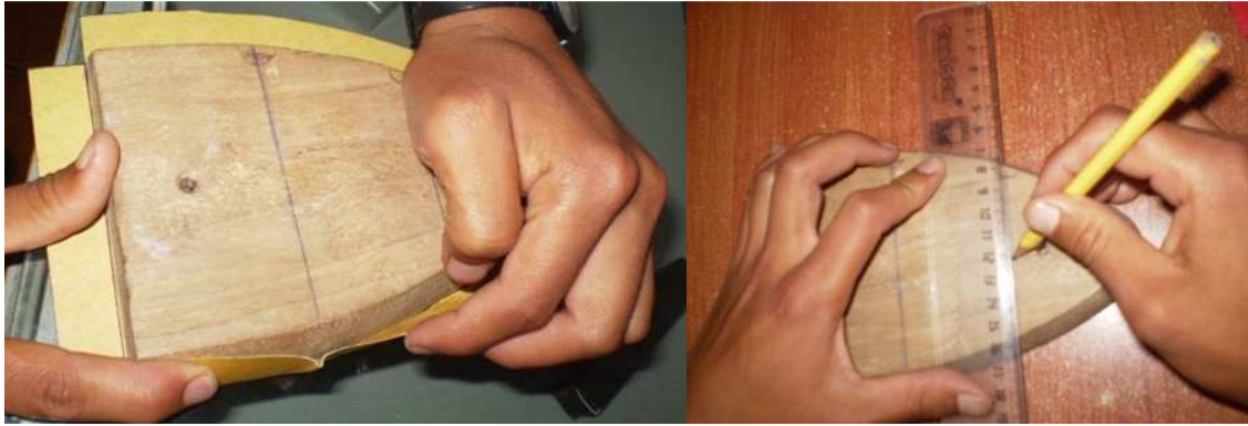
Figura 4.94. Trazado de las líneas ubicación de las ranuras. Fuente: Investigación de campo. Editado por: Andrés Balcázar.
