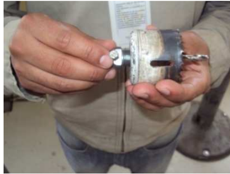
Figura 3.6. Insertado de la broca de campana en el conjunto (adaptador y broca). Fuente: Investigación de campo. Editado por: Andrés Balcázar.
