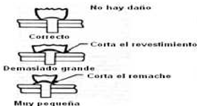
Figura 4.153. Buterolas Correctas e Incorrectas. Fuente: Investigación documental. Tomado de: Manual de la IAAFA.
