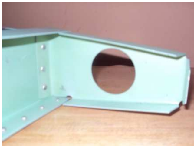
Figura 4.113. Parte posterior de la costilla terminado. Fuente: Investigación de campo. Editado por: Andrés Balcázar.
