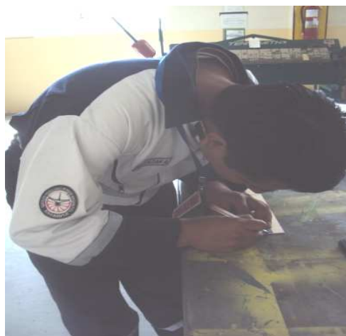
Figura 4.36. Trazado sobre la lámina. Fuente: Investigación de Campo. Editado por: Andrés Balcázar.
