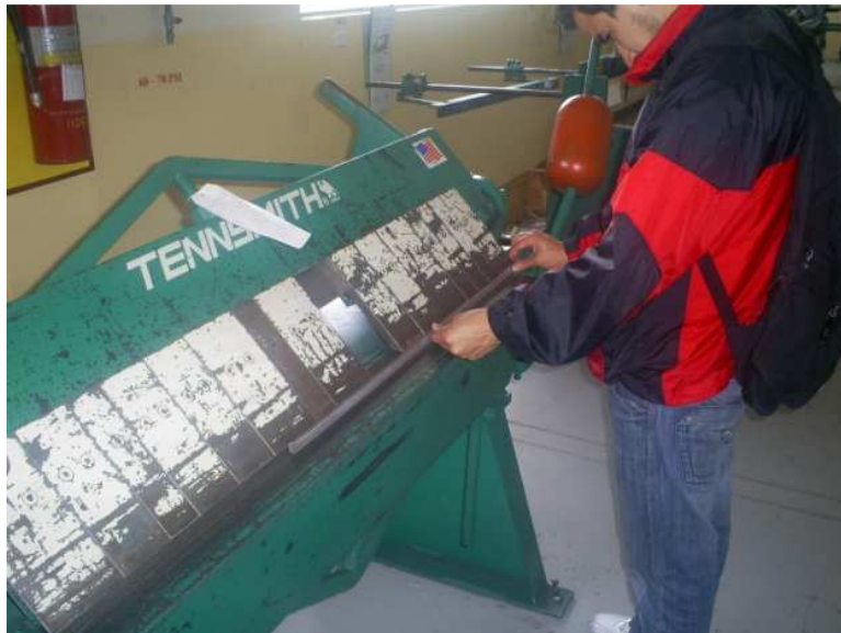
Figura 4.66. Doblado de las pestañas en la dobladora de caja. Fuente: Investigación de campo. Editado por: Andrés Balcázar.
