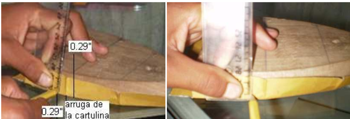
Figura 4.95. Trazado de las líneas para las ranuras a 0.29” Fuente: Investigación de campo. Editado por: Andrés Balcázar.
