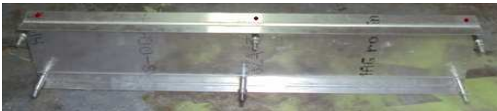
Figura 4.81. Marcas para taladrar las pestañas delanteras de la viga del borde de ataque.
