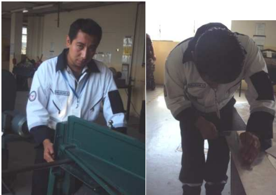
Figura 4.22. Corte y Limado de la lámina. Fuente: Investigación de Campo. Editado por: Andrés Balcázar.
