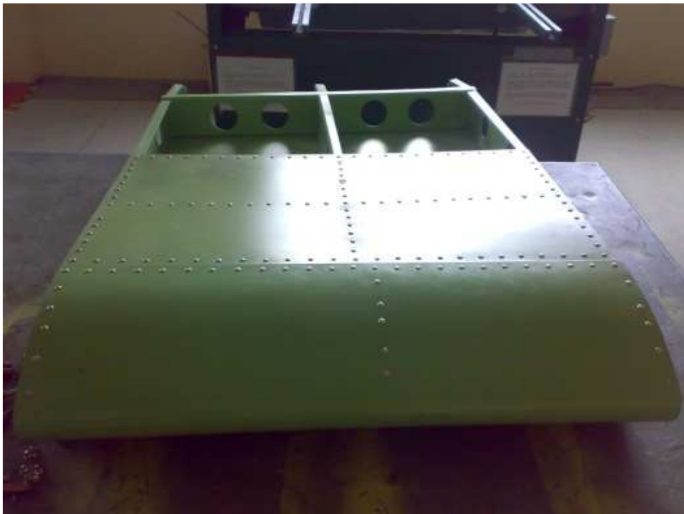
Figura 4.181. Prototipo estructural de ala terminado.
