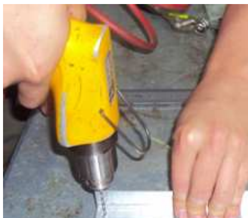
Figura 4.63. Taladrado de los orificios de Alivio de Tensión. Fuente: Investigación de campo. Editado por: Andrés Balcázar.
