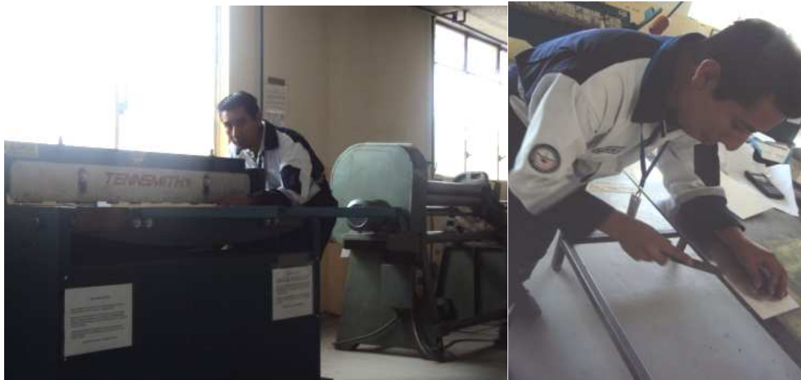
Figura 4.37. Corte y Limado de la lámina.
