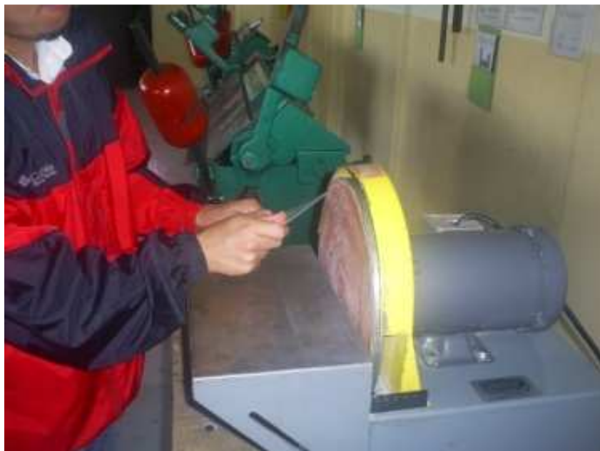
Figura 4.98. Lijado de la parte delantera de las costilla para darle su forma. Fuente: Investigación de campo. Editado por: Andrés Balcázar.
