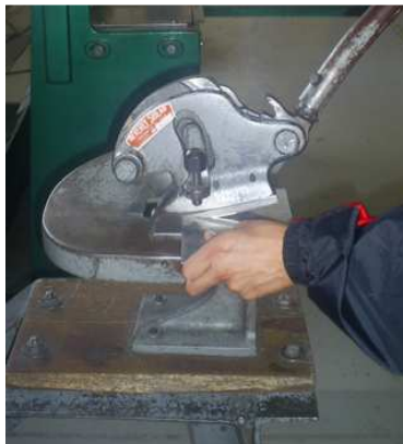
Figura 4.111. Cortado de los trazos en las pestañas laterales. Fuente: Investigación de campo. Editado por: Andrés Balcázar.
