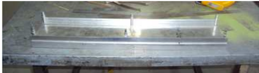
Figura 4.40. Pestañas adicionales de unión para la viga del borde de ataque. Fuente: Investigación de campo. Editado por: Andrés Balcázar.
