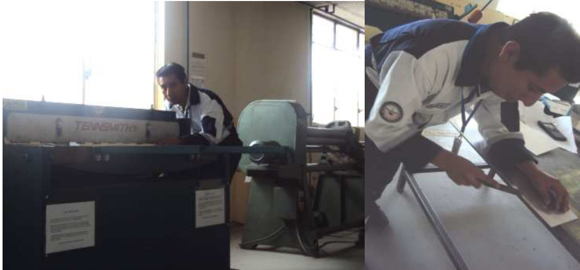
Figura 4.30. Corte y Limado de la lámina. Fuente: Investigación de Campo. Editado por: Andrés Balcázar.
