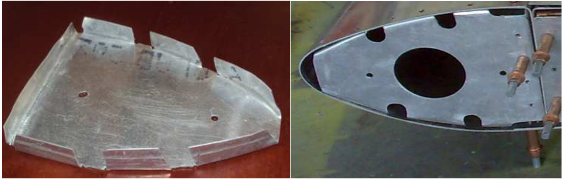
Figura 4.105. Parte delantera de la costilla terminada. Fuente: Investigación de campo. Editado por: Andrés Balcázar.
