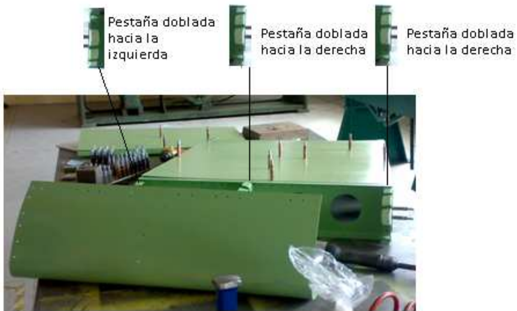
Figura 4.103. Demostración de cómo deben ir ubicadas las partes delanteras. Fuente: Investigación de campo. Editado por: Andrés Balcázar.
