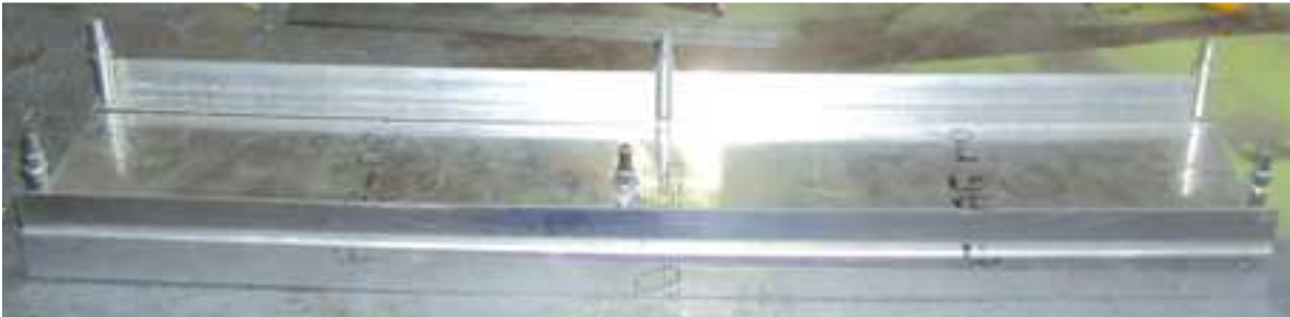
Figura 4.46. Pestañas taladradas y sujetadas con clecos a la viga.
