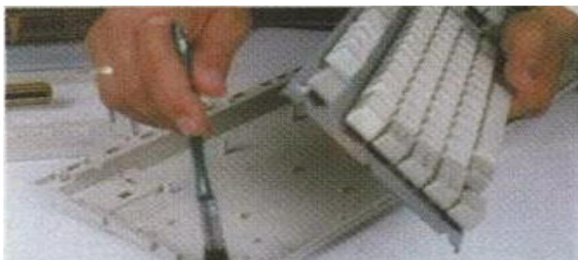
Fig.1.7. Limpieza interna del Teclado
