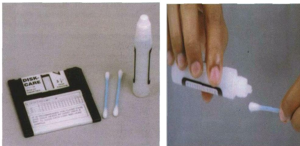
**Fig. 4.10. Elementos para Limpieza manual del drive**
