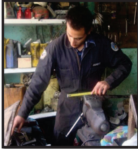
Figura 3.3 Corte de las esquinas de los tubos
