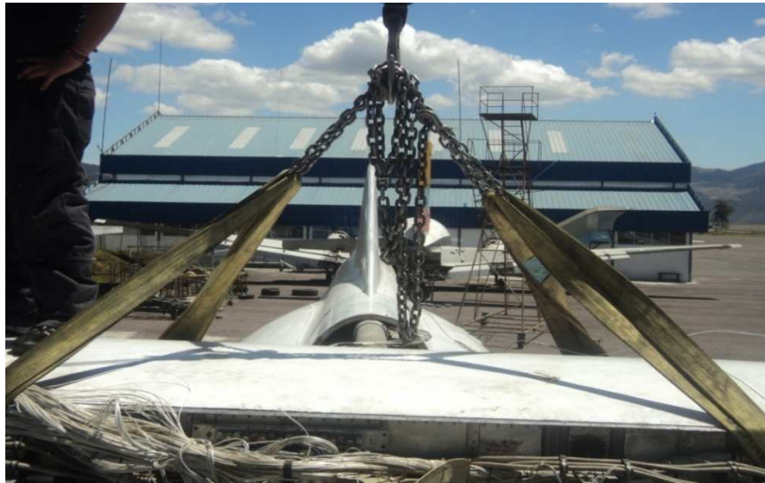
Figura N°3.3 Acoplamiento de las fajas y la grúa
