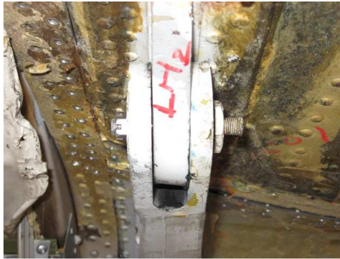
Figura N°3.7 Centrado de las guías Ala y fuselaje
