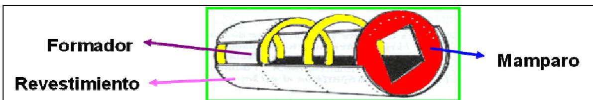
Figura 2. 5.- Partes del Fuselaje.
