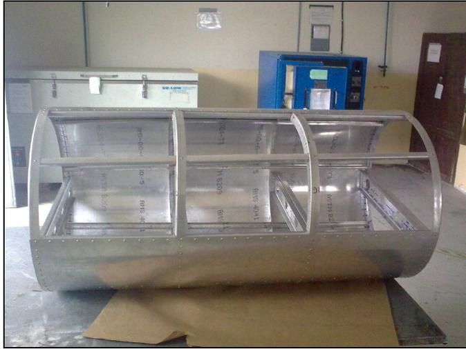
**Figura 4. 35.- Estructura Remachada con todas sus Piezas.**
