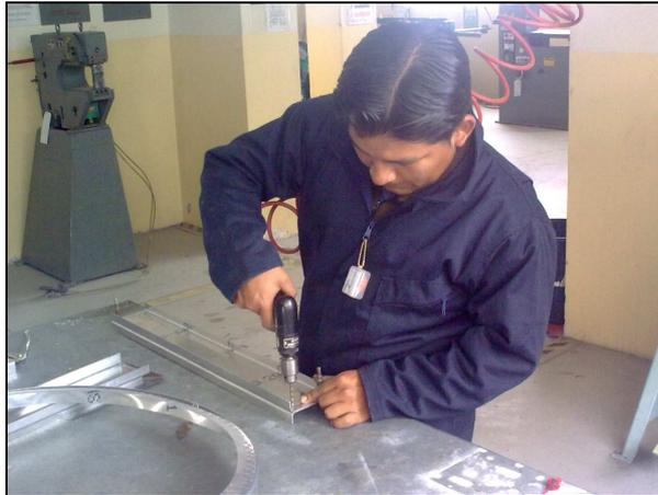
**Proceso de taladrado en los Ángulos para formar los Floor Beam**
