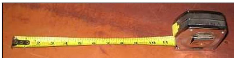
Figura 3. 1.- Flexómetro Extendido.
