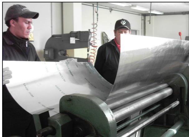
**Figura 4. 24.- Formación del Revestimiento en la Baroladora.**
