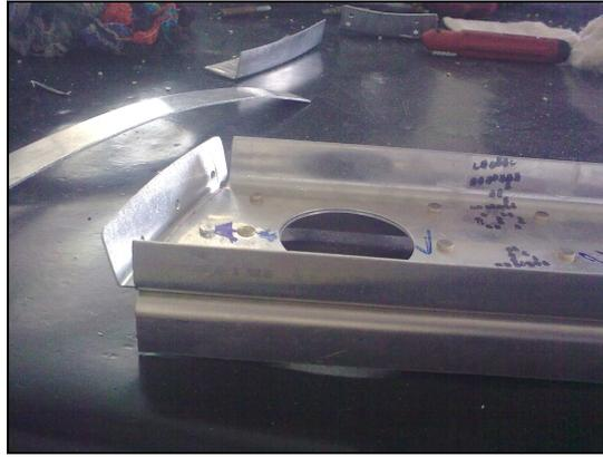
**Figura 4. 32.- Floor Beam con su Respectivo Ángulo.**
