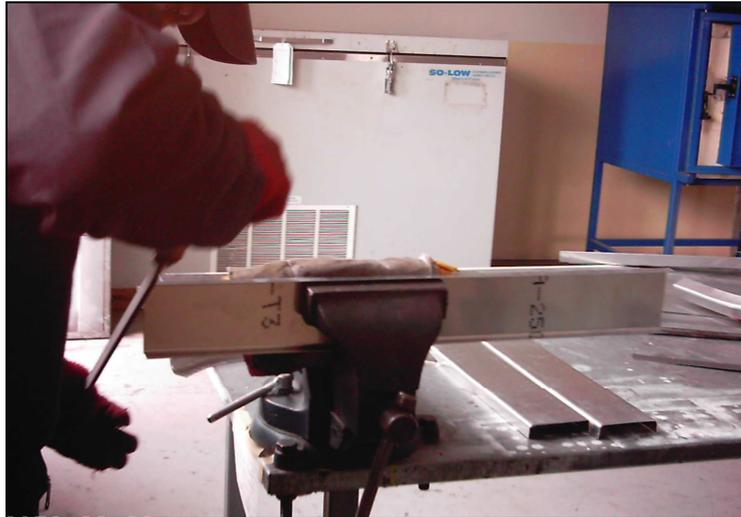
**Proceso de Limado de la Pieza.**
