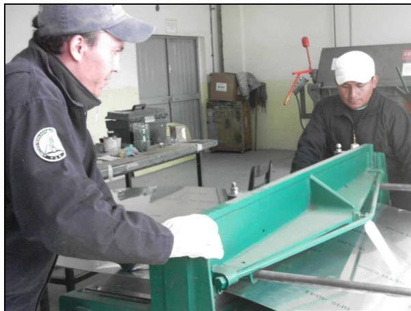
**Corte de la lámina para el revestimiento.**
