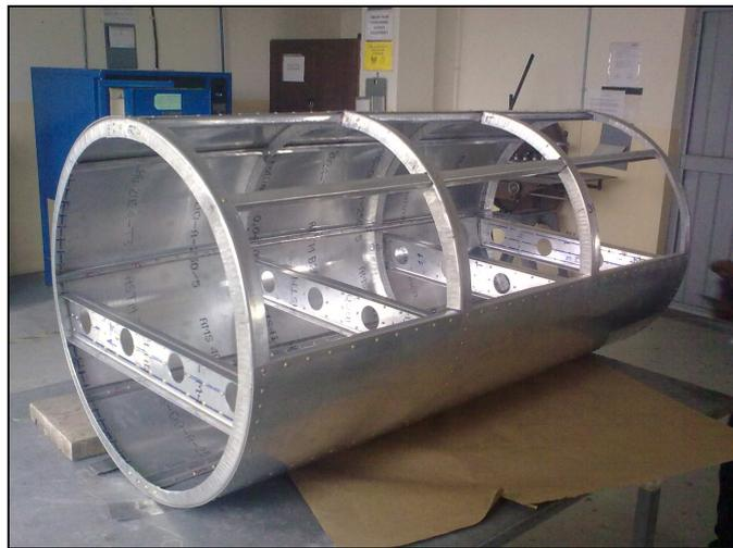
**Figura 4. 36.- Estructura Remachada con todas sus Piezas.**
