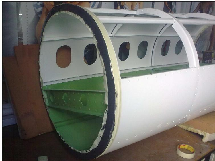
**Figura 4. 38.- Fuselaje Aplicado PRC en sus Extremos y entre Pieza y Pieza.**
