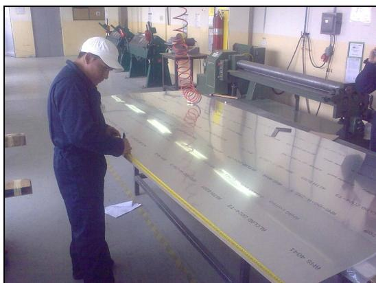
Figura 4. 17.- Lámina de Alclad Aluminio 2024-T3; 0.40.
