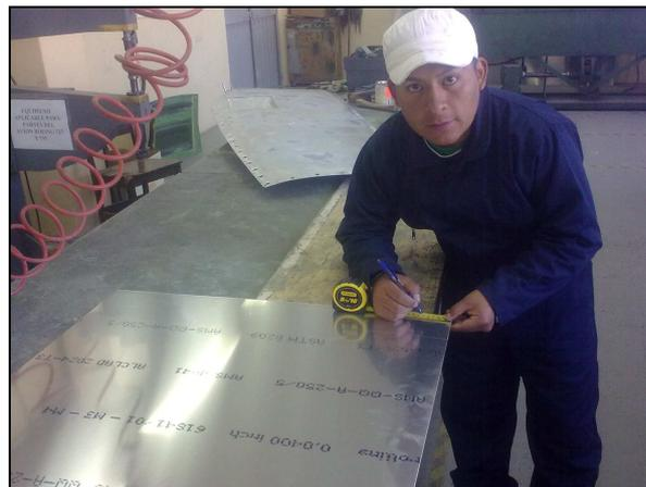
**Realizando las medidas antes de realizar el corte para los ángulos.**
