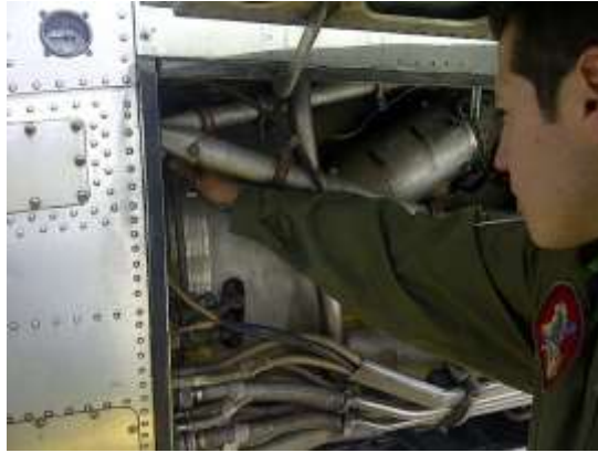
Figura 3. 18 Desembrague los pernos y abrazaderas
