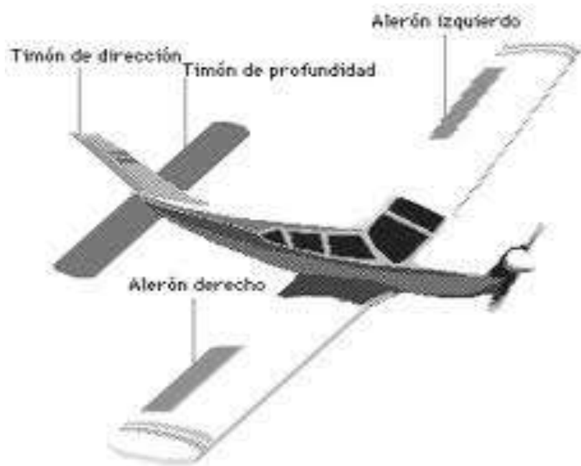
Figura 2. 4 Componentes del empenaje
