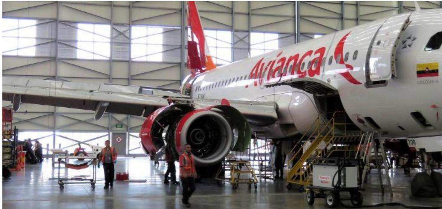
Las inspecciones sistemáticas comprenden, todas las inspecciones después del vuelo, antes del vuelo y las inspecciones diarias que son hechas antes del primer vuelo del día.
