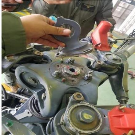
*Nota:* Quitar el tornillo de fijación del buje del rotor al mástil rotor para desmontar la argolla de elevación del buje principal.
