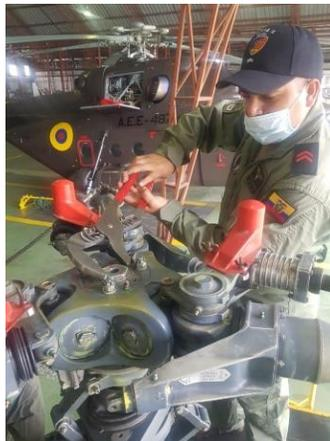
*Nota:* Atornillar la herramienta pinza de extensión y asegurarse de que su cara de apoyo esté en contacto con la parte superior del mástil rotor.
