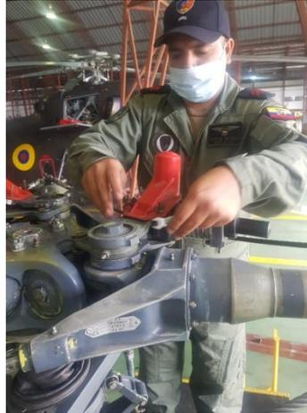
*Nota:* Se debe montar el extractor del buje del rotor (B).
