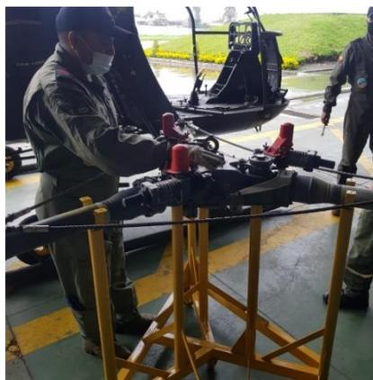
*Nota:* Con la ayuda de la herramienta especial se colocó el buje principal para el desmontaje de los tornillos estriados.
