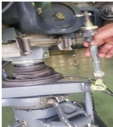
*Nota:* Se desacoplaron las bielas de cambio de paso del buje principal.
