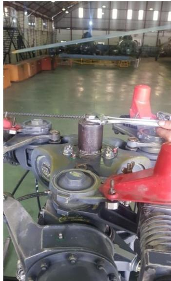
*Nota:* Fijar con sus tres tornillos (3) en los aterrajados de fijación de la argolla de elevación.
