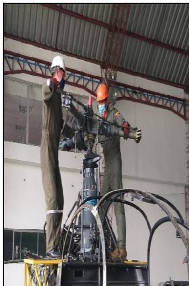
En este punto se procedió hacer girar el rotor, a mano para localizar un punto de fricción o una rigidez incipiente de la C.T.P
