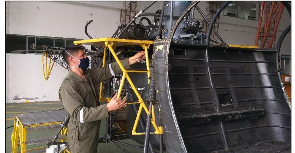
Para la verificación del frenado se realizó el torque de los pernos a fin de frenar los mismo y realizar la verificación correspondiente.
