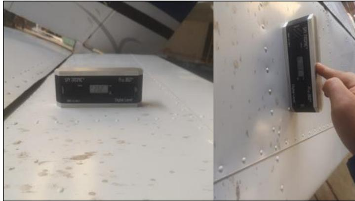
*Nota.* En la imagen se puede observar la medición de los grados del elevador.
