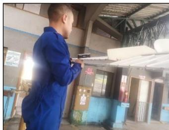
*Nota.* En la imagen se observa la colocación del inclinómetro y ajustándolo a 0.
