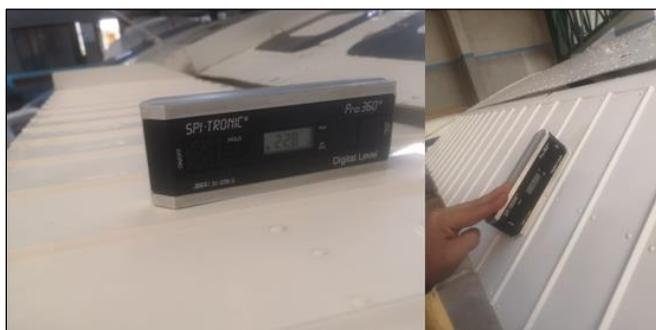
*Nota.* En la imagen tenemos la medición con el inclinómetro del alerón hacia arriba y hacia abajo.
