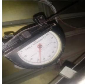
*Nota. En la imagen observamos la medición de la tensión del cable del rudder.*
