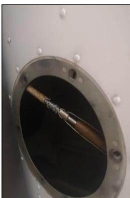
*Nota.* En la imagen se observa el tensor entorchado con uno de los métodos de asegurado
