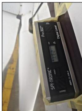
*Nota. En la imagen tenemos el inclinómetro con la medición del rudder.*
