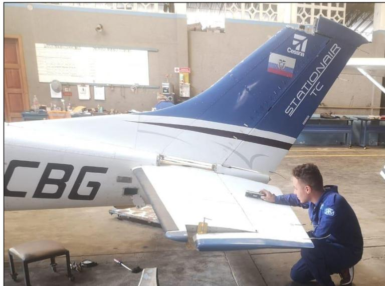
*Nota. En la imagen tenemos la colocación del inclinómetro y ajustado a 0.*
