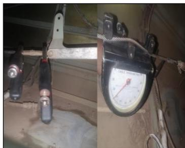
Nota. En la imagen tenemos la medición de la tensión del cable del elevador.
