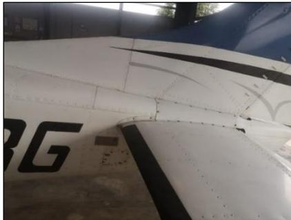
*Nota.* En la imagen podemos observar las tapas de inspección 310BB y carenado 340AL
