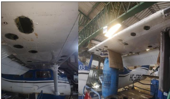
*Nota.* En la imagen observamos las alas de la aeronave sin tapas de inspección.
