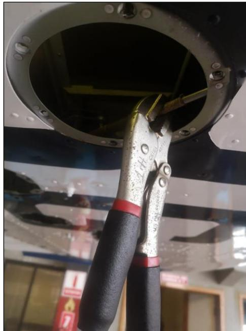
*Nota.* Tensor sin el entorchado de seguridad liberando la tensión de los cables.
