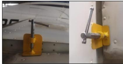
Nota. En la imagen tenemos el elevador instalado la herramienta en posición neutral
