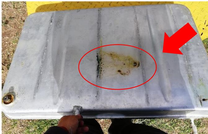
**Nota:** se realizó un chequeo al tanque en busca de fugas y corrosión
