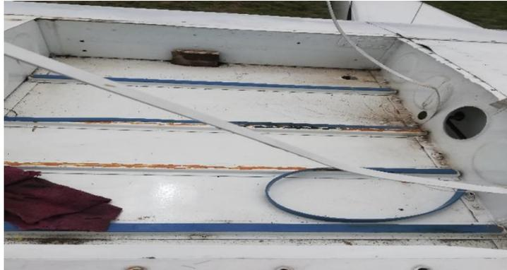
**Nota:** se colocó cauchos para que el tanque no rozara con la estructura de la aeronave
