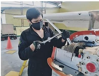
*Nota:* Aplicar el torque especificado en el manual de mantenimiento de la aeronave.
