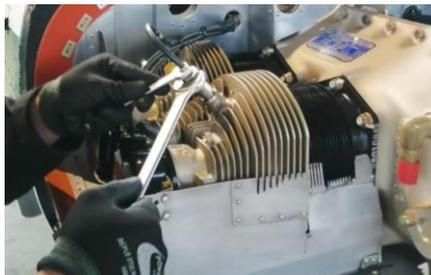
*Nota:* El ajuste del cable de bujías se lo debe realizar moderadamente sin aplicar demasiada presión.
