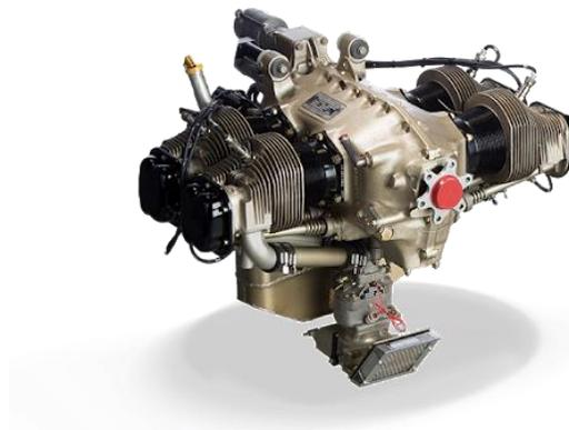
*Nota:* El O-200 es un motor de aeronaves de cuatro cilindros, de transmisión directa, refrigerados por aire, opuestos horizontalmente, de 201 in<sup>3</sup> de cilindrada, que producen entre 90 y 100 caballos de fuerza.
