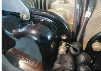
*Nota:* Para fijar los cables de bujías, utilizamos abrazaderas especiales de goma.
