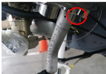
*Nota:* Asegurarnos que los orificios para el guía de la abrazadera no contengan fisuras.
