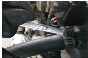
*Nota:* El ajuste de las abrazaderas debe ser moderadamente para evitar dañar la cañería.
