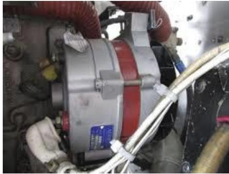
*Nota:* Vista de un alternador instalado en un motor Continental O-200.
