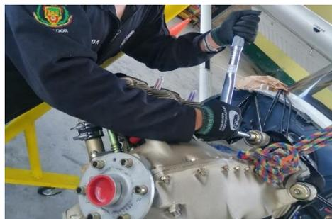
*Nota:* La aplicación de torque debe ser la especificada en el manual de mantenimiento.
