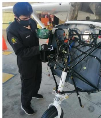
*Nota:* Realizamos una inspección visual en el montante del motor para descartar fisuras en el material.
