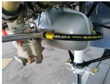
*Nota:* Al momento de colocar combustible verificar que no existan fugas por las cañerías.
