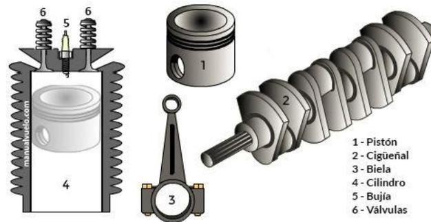
*Nota:* Los componentes principales de un motor reciproco son el pistón, el cigüeñal, la biela, el cilindro, las bujías y las válvulas.
