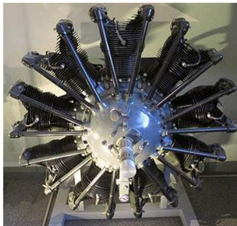
*Nota:* El R-1340 Wasp es un motor radial de nueve cilindros, diseñado y fabricado por la compañía estadounidense Pratt & Whitney para motorizar aviones, y posteriormente, helicópteros.
