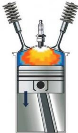
*Nota:* Proceso de combustión dentro de un cilindro del motor.
