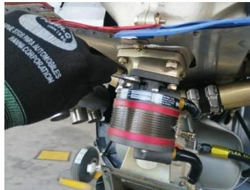
*Nota:* La bomba de succión debe ser asegurada solamente con el torque especificado en el manual de mantenimiento.
