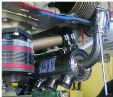
5. Una vez instalado el sistema de escape procedemos a colocar los tubos de escape, para ello primero colocamos el tubo de escape y nos fijamos que se incruste correctamente y que se coincida el orificio del tubo de escape con el orificio del tubo de salida del sistema de escape.
