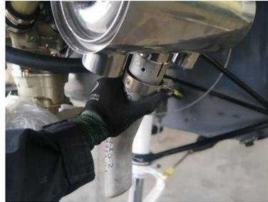
*Nota:* Al colocar las abrazaderas asegurarse que el pin de la abrazadera inserte correctamente en los orificios de los tubos
