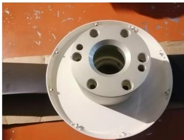
*Nota:* Colocar un poco de lubricante en los orificios del espaciador.
