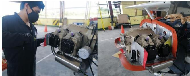
*Nota:* Todos los deflectores de calor deben ser colocados correctamente tal y como lo indica el manual de mantenimiento.
