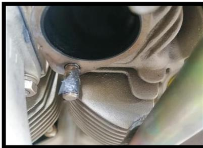
*Nota:* La colocación del LPS es muy importante ya que sirve como un lubricante y evita el daño de la rosca por oxidación.
