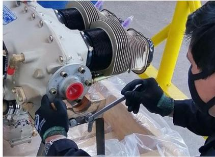
*Nota:* Retirar los pernos que sujetan al motor en la base.
