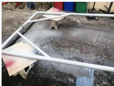
*Nota:* Es muy importante colocar la pintura base para evitar la oxidación del material y que se adhiera bien la pintura.
