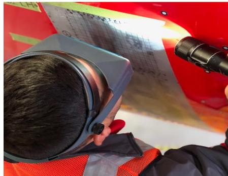
*Nota:* Inspección visual realizada por un técnico de Mantenimiento Aeronáutico.
