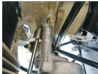
*Nota:* Asegurarse que la junta de asbesto que tiene la base se encuentre en perfecto estado para evitar fugas.
