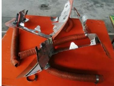
*Nota:* Realizar una inspección visual a los deflectores de calor para localizar rajaduras o daños al material.
