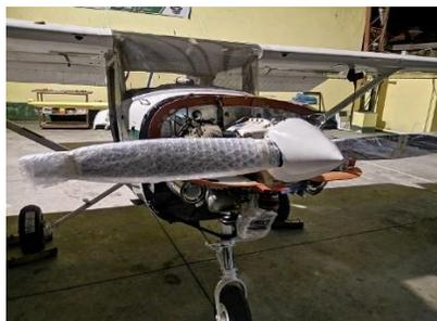
*Nota:* Al terminar de instalar la hélice cubrir las palas hasta terminar el trabajo para evitar daños accidentales.
