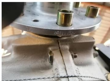
*Nota:* Para la instalación de la hélice es necesario ubicar el Pistón 1 en el Punto Muerto Superior.
