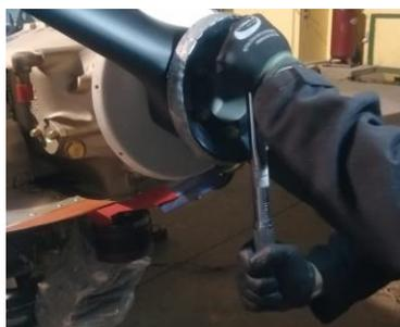
*Nota:* Aplicar el torque recomendado en el manual de mantenimiento de la aeronave.
