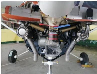
*Nota:* Al terminar de instalar el sistema de escape, cubrirlo con cualquier tela para evitar ensuciarlo hasta terminar de instalar los componentes restantes.
