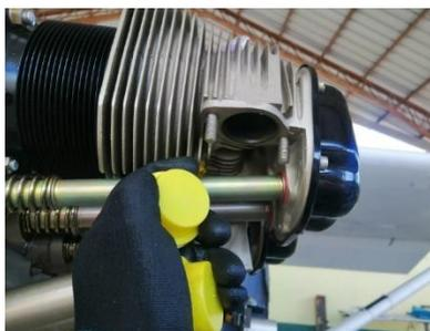
*Nota:* Retirar los tapones que se encuentras en los conductos de entrada del escape, estos sirven para evitar la entrada de cualquier material dañino.
