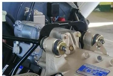
*Nota:* Cuando el motor este instalado nos aseguramos que las bases de los soportes encajen correctamente en los pasadores.
