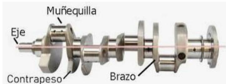
*Nota:* Partes de un cigüeñal como el eje, la muñequilla el contrapeso y el brazo.
