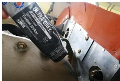
*Nota:* Colocamos silicón donde exista aberturas entre el block del motor y el deflector.
