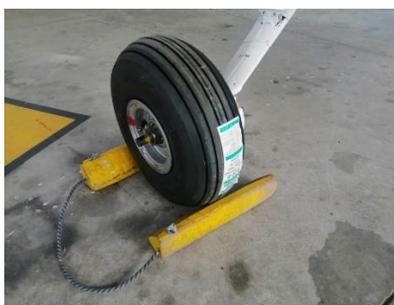
*Nota:* Colocar correctamente los tacos para que la aeronave permanezca fija.
