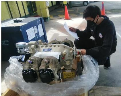
*Nota:* Revisar que todos los números de parte y de serie del motor coincidan con la hoja de componentes del motor.
