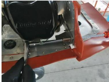
*Nota:* Los deflectores delanteros van unidos a la tapa de válvulas por medio de un perno.
