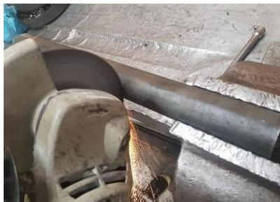
*Nota:* Con la ayuda de una amoladora se procedió a cortar las partes necesarias para el soporte.
