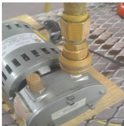
*Nota.* Verificar que se haya realizado la conexión neumática correctamente.
