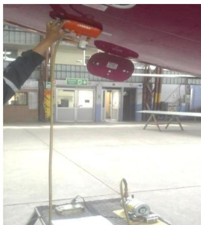
e. Cuando el indicador de vacío muestre 15.8 pulgadas de mercurio (Hg), se procede a ajustar el regulador de presión de aire para aumentar el vacío en incrementos de 0.1 pulgadas de mercurio (Hg).
