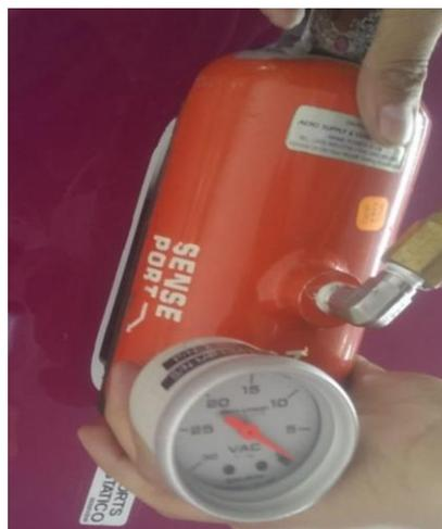
*Nota:* el accesorio se instala asegurando que la junta de accesorio de prueba no esté en la abertura de la válvula.
