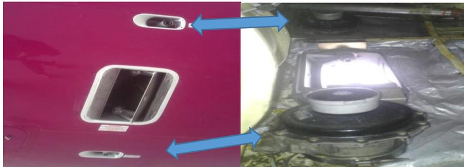
*Nota.* La aeronave Boeing 737 tiene dos válvulas de alivio en la parte inferior del conjunto de cola.
