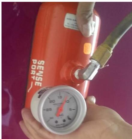
g. Se continúa los aumentos intermitentes de vacío de 0.1 pulgadas de mercurio (Hg) hasta que se abra la válvula; tener precaución en la apertura de la
