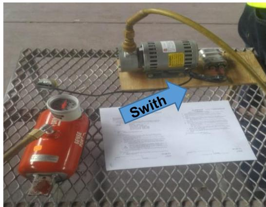
b. Se conecta la fuente de aire al regulador de presión del comprobador de las válvulas de alivio, se debe asegurar de sostener firmemente las líneas neumáticas para evitar una salida descontrolada del aire al momento de la conexión.
