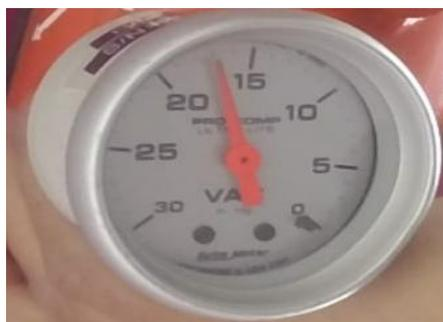
i. Asegurarse de que la válvula se abra entre 16.3 a 17.0 pulgadas de mercurio (Hg), mantener el comprobador en su lugar mientras se acerca la lectura a la presión indicada.
