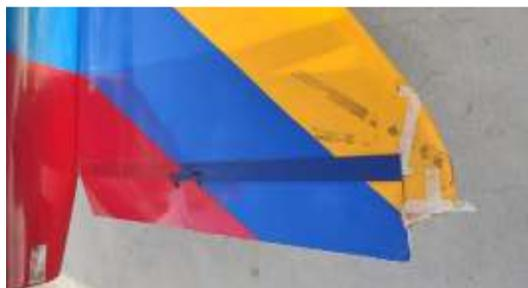
*Nota.* Se observa la punta del ala derecha rota y desgaste en la pintura
