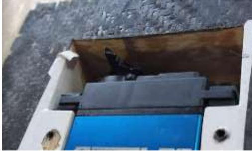
*Nota.* Se visualiza el cuerno u Horn del servomotor roto
