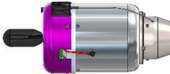
*Nota.* Se observa la vista externa del motor P80SE. Tomado de (JetCat, 2019)
