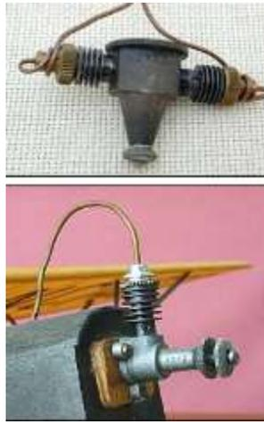
*Nota.* Se visualiza un motor CO2 instalado en aeromodelo. Tomado de (Ecured, 2019)
