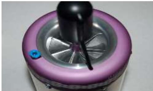
*Nota.* Se observa la sección de admisión del motor. Tomado de (JetCat, 2019)
