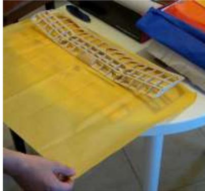
*Nota.* Se visualiza el recubrimiento con papel clásico alrededor de la estructura del ala
