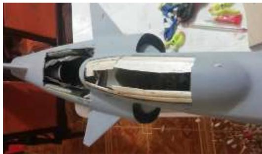
*Nota.* Se utilizó varillas de balsa para darle forma a la cubierta.
