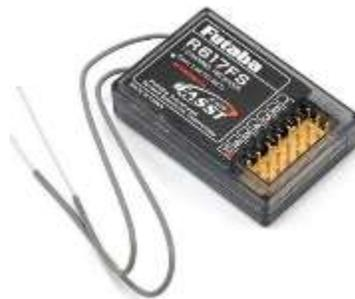
*Nota.* Se visualiza un receptor de marca Futaba. Tomado de (Ecured, 2019)
