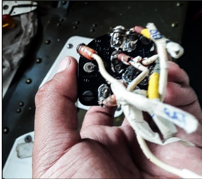
Figura 23 Switch de ignición defectuoso
