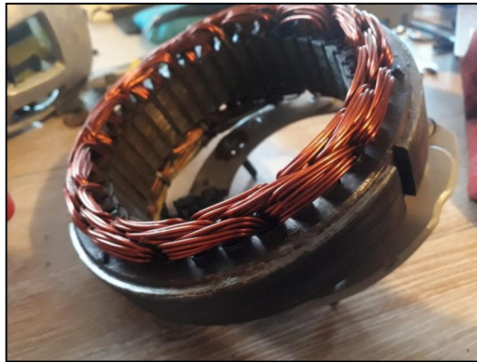
Figura 33 Aislamiento del bobinado
