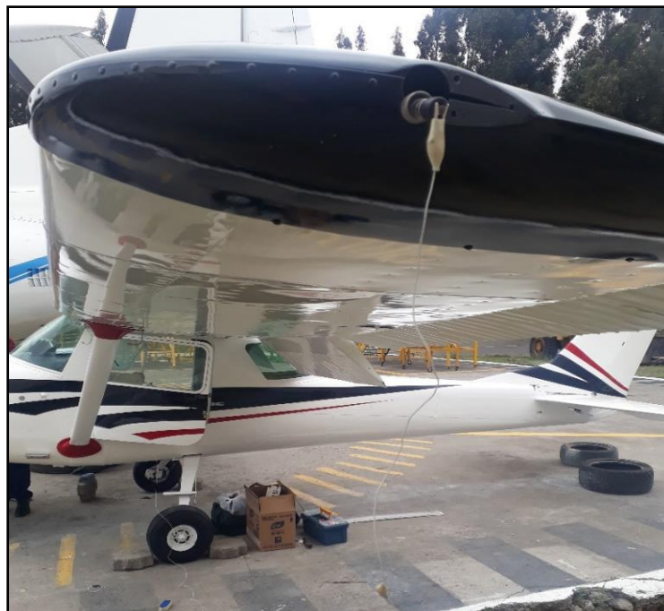
Figura 41 Test de continuidad de luz de navegación
