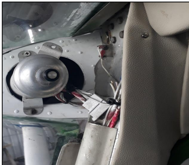
Figura 38 Cableado suelto en ala derecha
