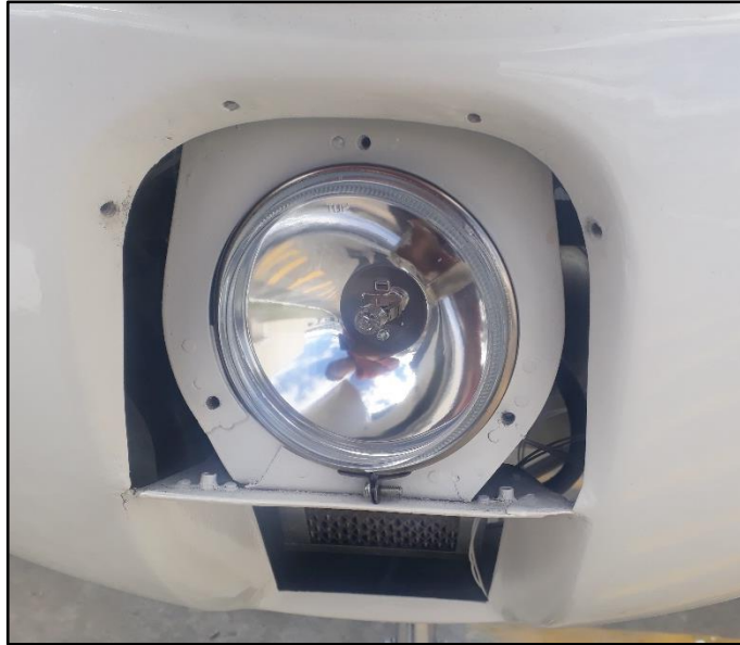
Figura 44 Luz de aterrizaje instalada
