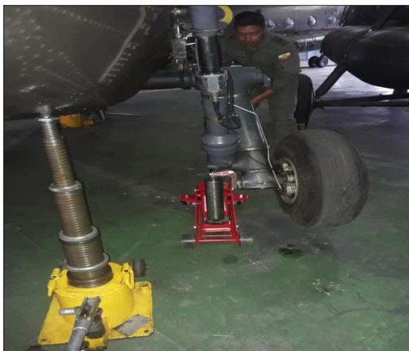
Figura 79 Uso del Gato Hidráulico de 3 Toneladas
