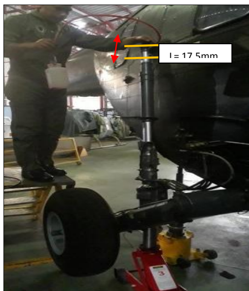
Figura 94 Compresión del Vástago Hasta la Medida de L= 17.5mm
