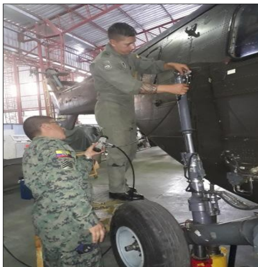
Figura 83 Instalación del Equipo De Llenado de Presión
