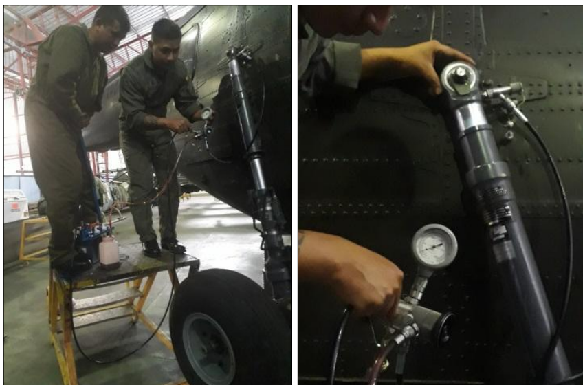
Figura 87 Llenado del Amortiguador Controlando la Presión
