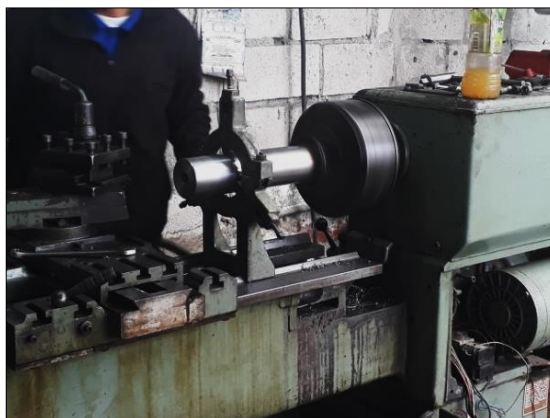
Figura 46 Elaboración del Acople del Gato Hidráulico
