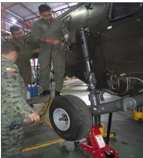
Figura 86 Control de la Presión Para su Llenado
