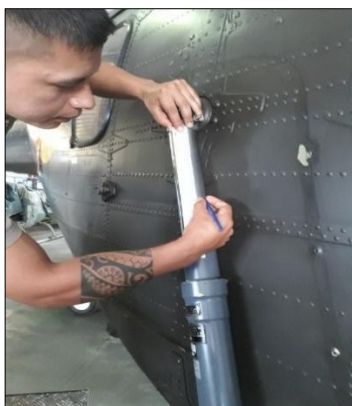
Figura 93 Medida de acuerdo al manual L = 17,5 \text{ mm}
