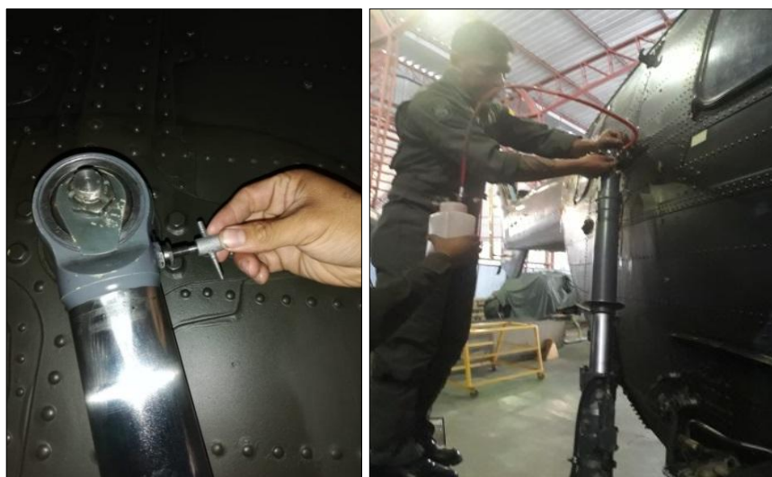
Figura 82 Extracción del Recipiente de Hidráulico
