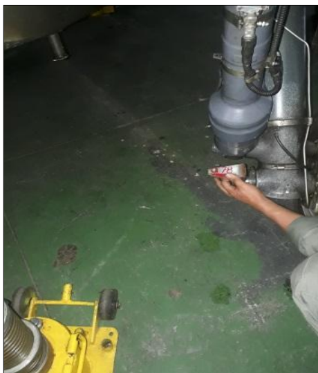
Figura 99 Retiro de la Rótula de Elevación
