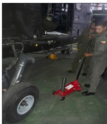
Figura 98 Retiro del Gato Hidráulico
