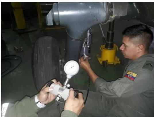
Figura 59 Apriete del Obús del Dispositivo
