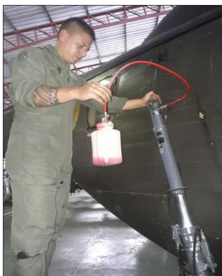
Figura 80 Purga del Fluido Hidráulico
