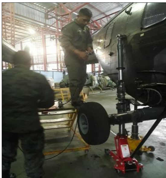
Figura 90 Uso del Gato Hidráulico para Comprimir el Amortiguador
