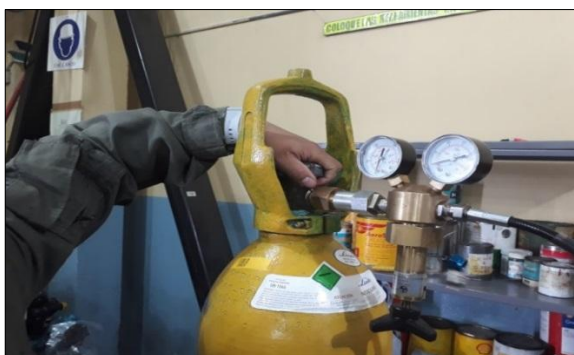
Figura 68 Comprobación de la Presión
