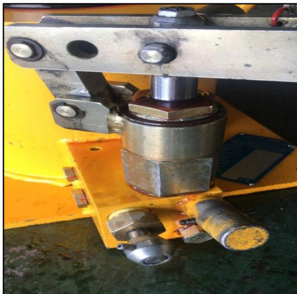
**Figura 62 Fuga en la Bomba**
