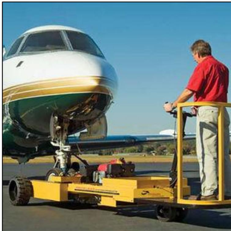
**Figura 23 Tractores con Barra de Remolque**
