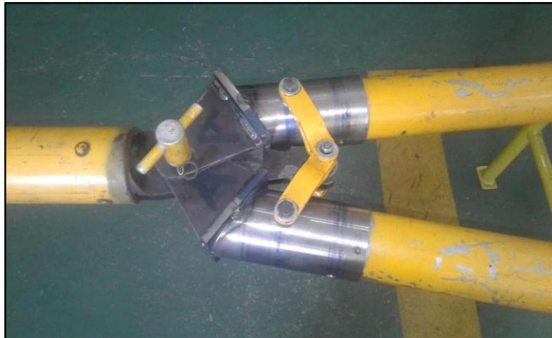
**Figura 57 Armado de la junta a la barra de remolque**
