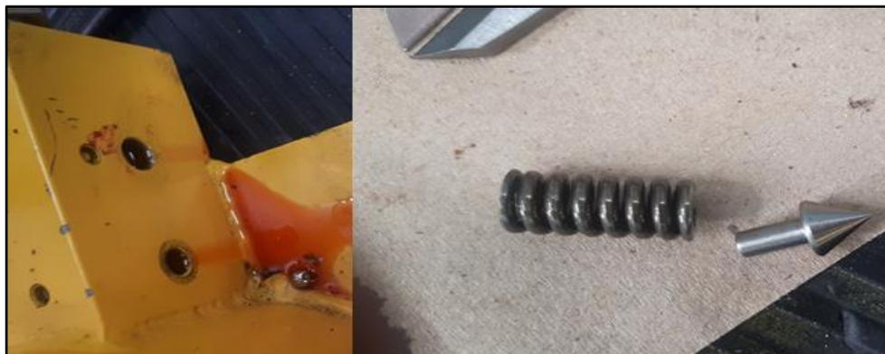
**Figura 66 Válvulas de presión y retorno**
