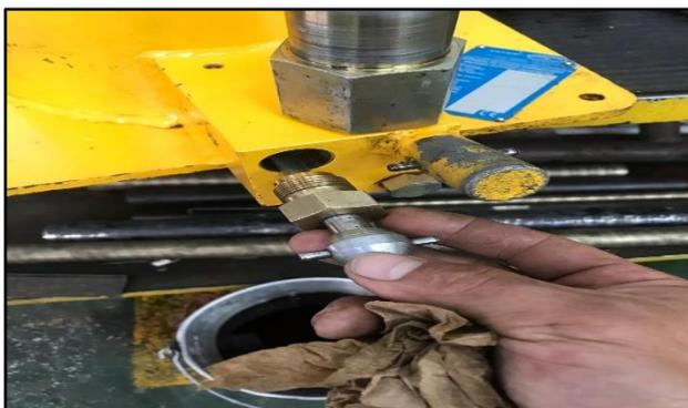
**Figura 64 Válvula de Alivio de Presión**
