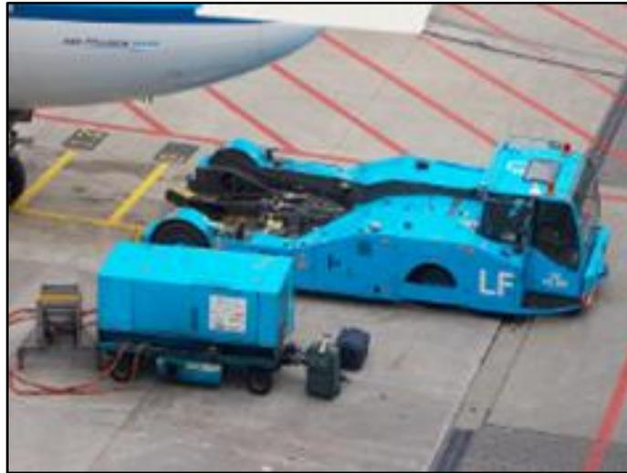
**Figura 24 Tractores sin Barra de Remolque**
