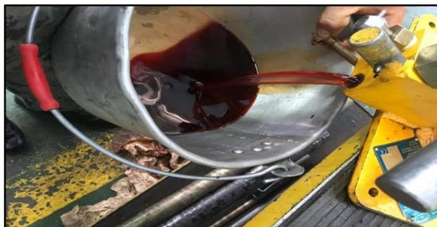
**Figura 63 Vaciado del Líquido Hidráulico**
