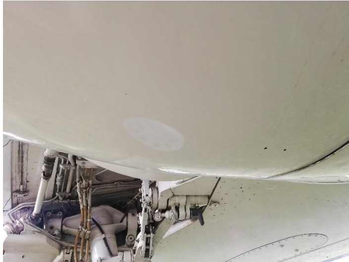
Figura 84 Funcionamiento de la compuerta izquierda del tren de aterrizaje
