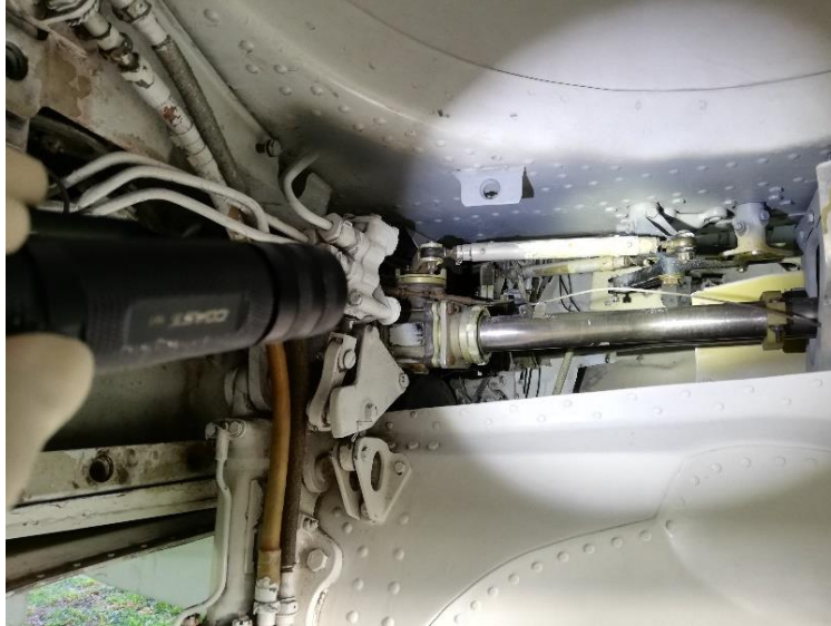
Figura 90 Estructura central y cañerías de combustible
