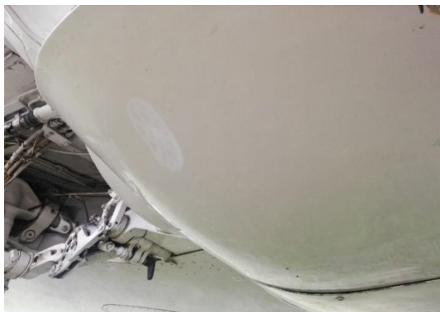
Figura 88 Limpieza e inspección de estructura en general del carenado L/H
