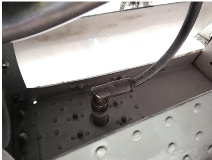
Figura 76 Instalación del plug de la antena de COM HF
