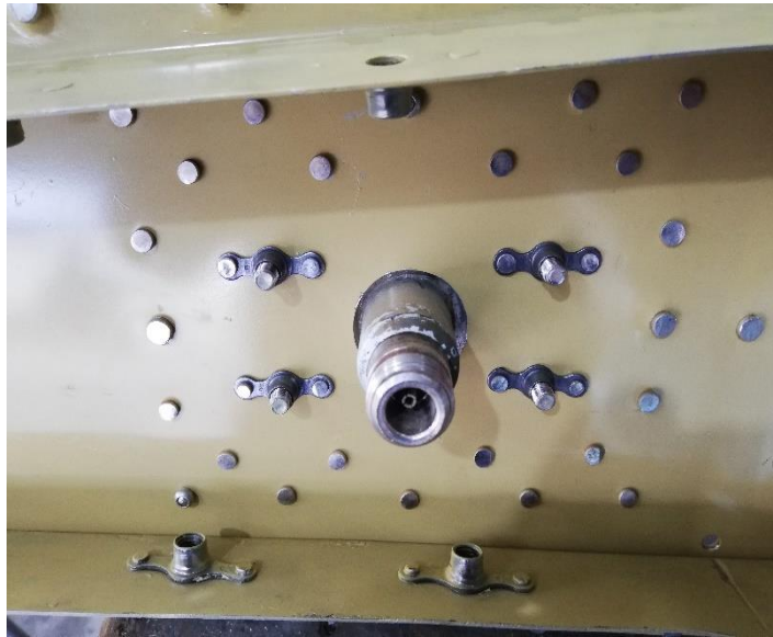
Figura 73 Esquema de remachado y aseguramiento de la antena HF
