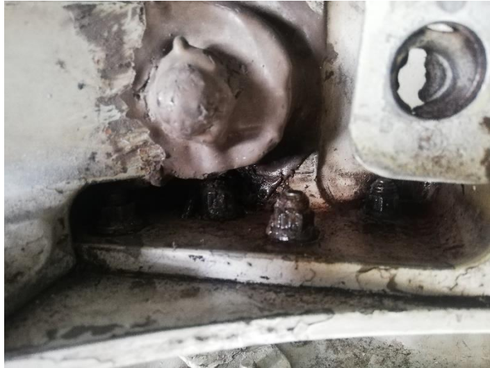
Figura 82 Aceite hidráulico sobre pernos y tuercas
