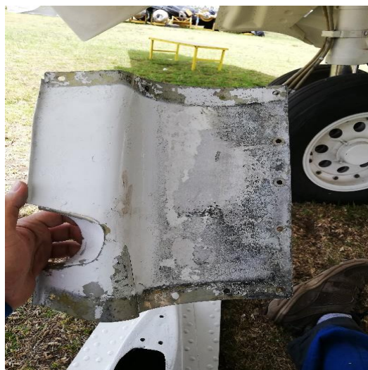
Figura 40 Condiciones de los paneles que sujetan al panel de la antena de COM HF y luz beacon
