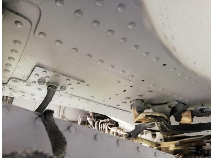
Figura 37 Limpieza y aplicación de Primer a la estructura y costilla
