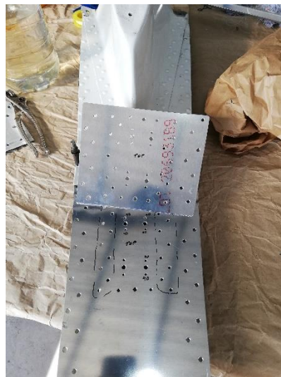
Figura 58 Marcación orientación de las nuevas pieles
