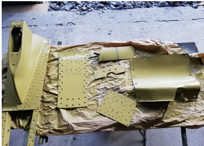
Figura 66 Aplicación de Primer a todas las partes
