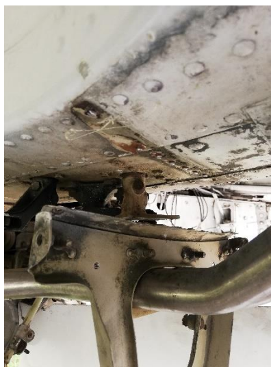
Figura 36 Estado de la costilla y fuselaje de la aeronave
