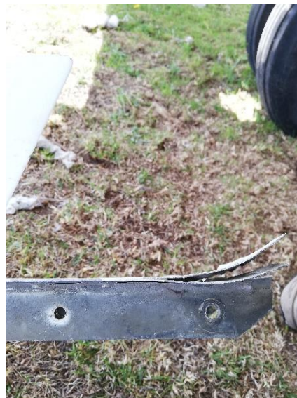
Figura 42 Condiciones de las pieles del panel en los puntos de sujeción
