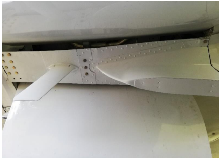
Figura 75 Instalación del panel de la antena de COM HF
