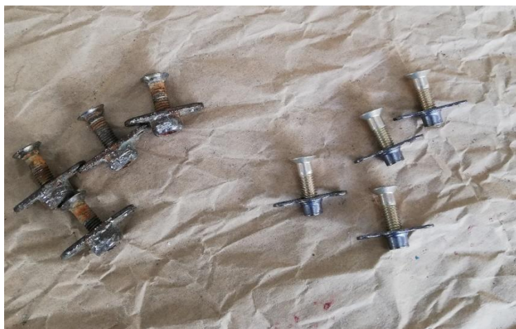
Figura 62 Nut Plates K1000-3 y tornillos AN507C-832R8 de rosca fina
