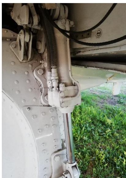
Figura 92 Limpieza e inspección del strut del carenado derecho R/H
