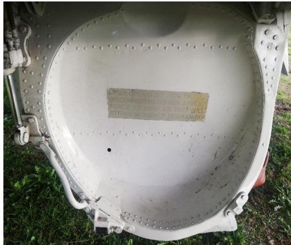
Figura 78 Compuerta de acceso L/H
