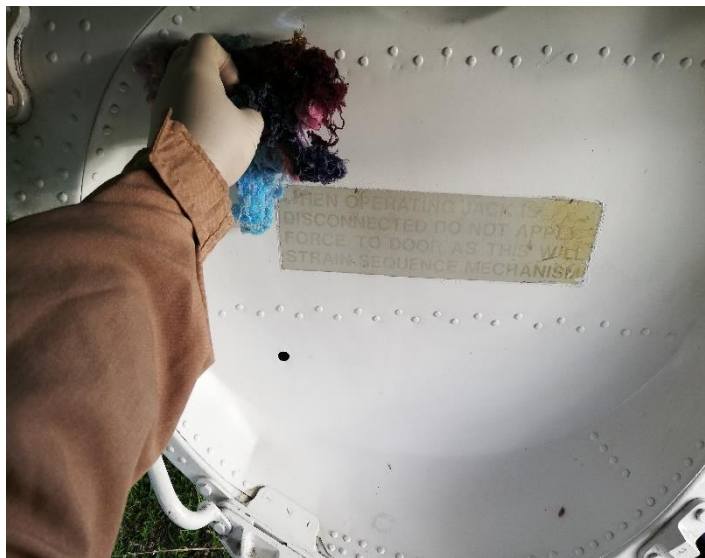
Figura 85 Limpieza e inspección de la compuerta izquierda del tren de aterrizaje
