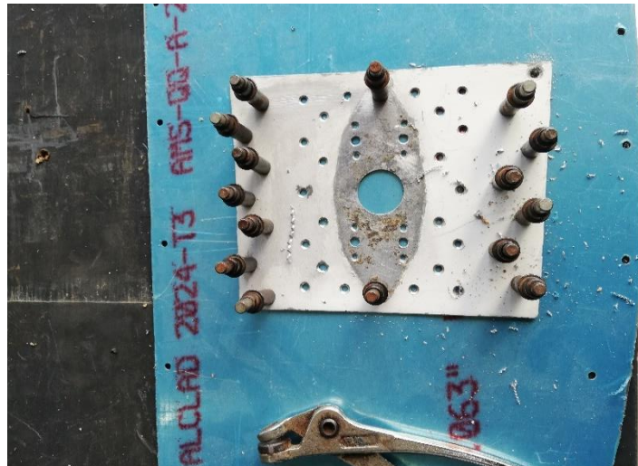
Figura 51 Molde sobre la lámina de espesor 0.063 in de la estructura
