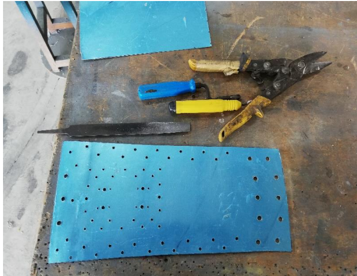
Figura 53 Lámina de espesor 0.032 in cortado
