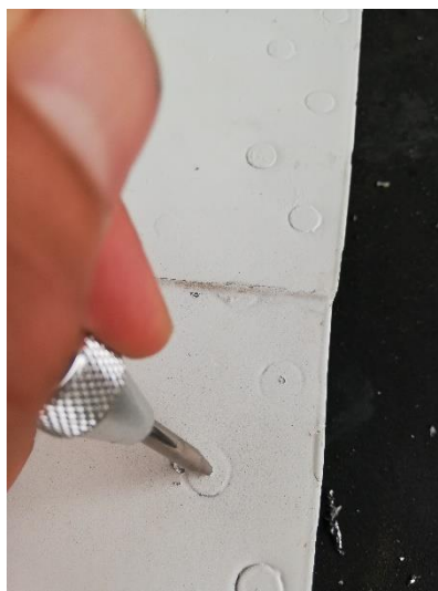
Figura 43 Marcación con el puntero guía en remaches AN 426
