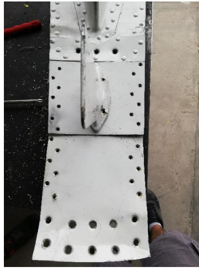
Figura 44 Extracción de remaches AN 426 5-4, 5-6 del panel VHF
