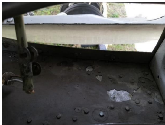
Figura 39 Condiciones del panel IN de las antenas HF y VHF fuselaje
