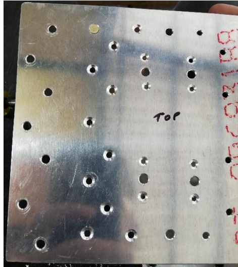
Figura 59 Huecos avellanados para remaches AN 426
