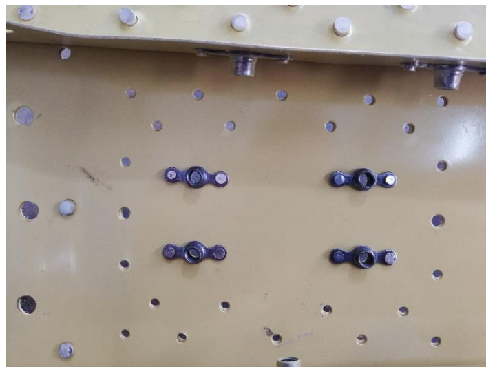
Figura 70 Remachado de los Nut Plates K1000-3 para la antena de COM HF
