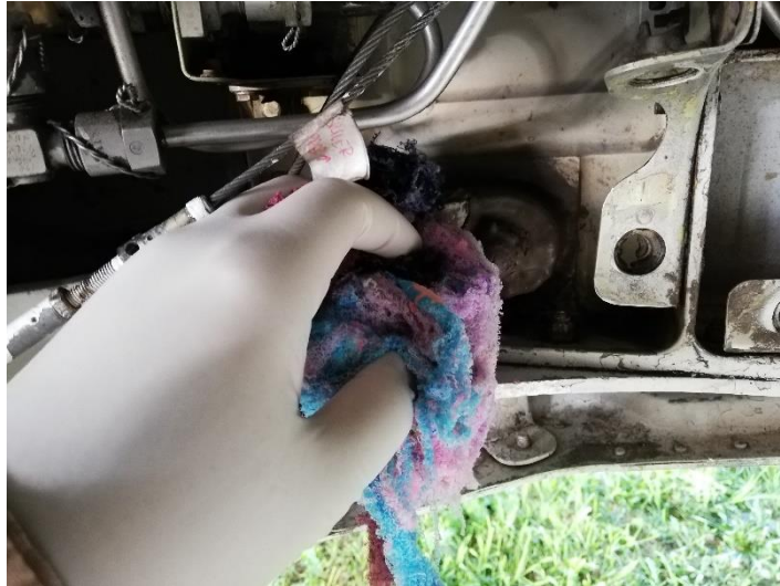
Figura 86 Limpieza e inspección de la unión del carenado y perfil alar
