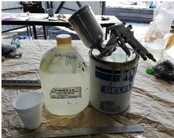
Figura 65 Preparación de Primer relación 1:1
