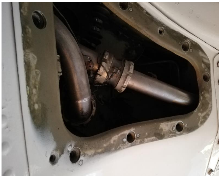
Figura 91 Inspección interna de cañerías del carenado R/H
