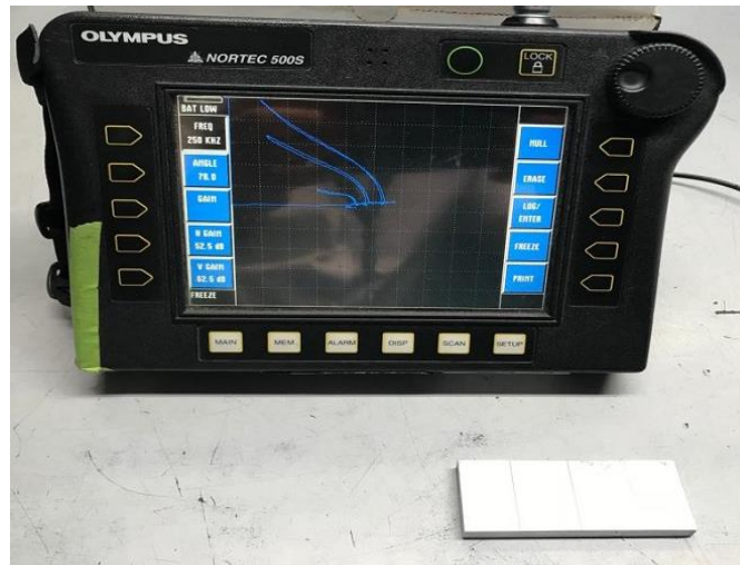
Figura 9 Inspección por medio de corrientes inducidas Fuente: (IAC, 2005)
