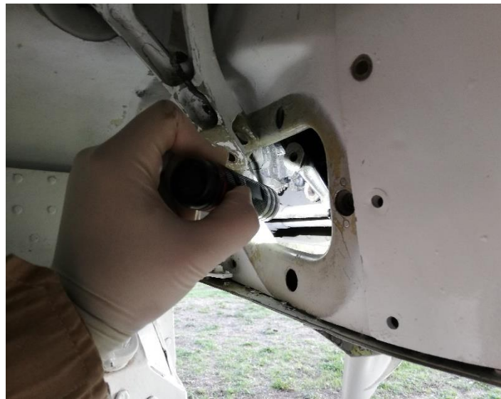
Figura 81 Inspección de cañería y cables en el panel 2
