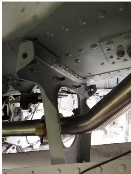
Figura 38 Remachado con remaches Pop LP5-6 a la estructura
