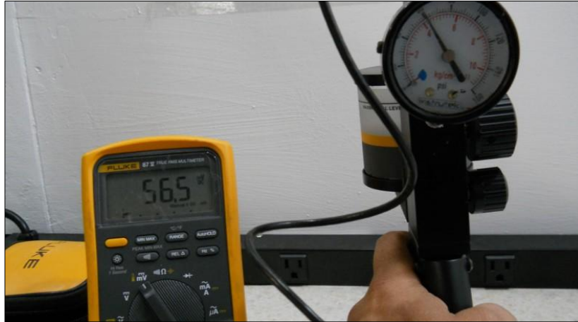
Figura 18. Calibración de manómetros.
