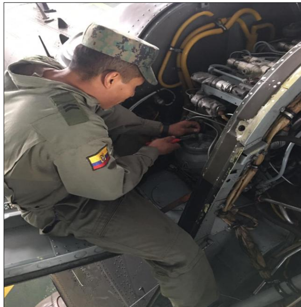
Figura 26. Desbloqueo del reservorio
