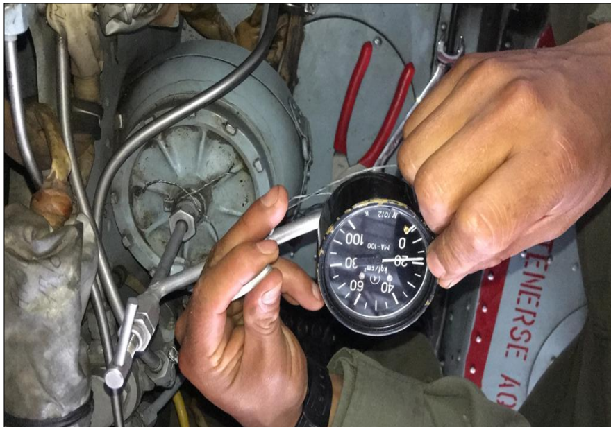
Figura 22. Comprobación de carga del reservorio
