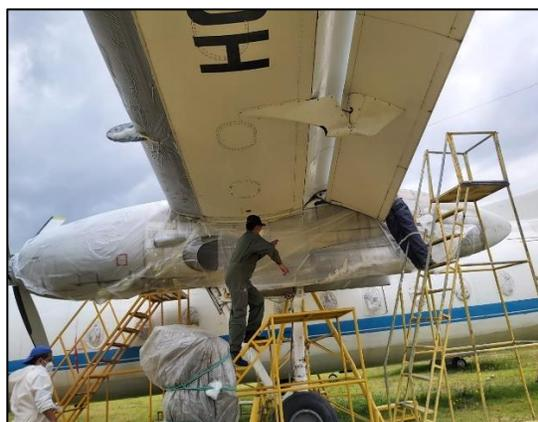
*Nota :* En esta imagen se visualiza la preparación de la aeronave antes de realizar el decapado.
