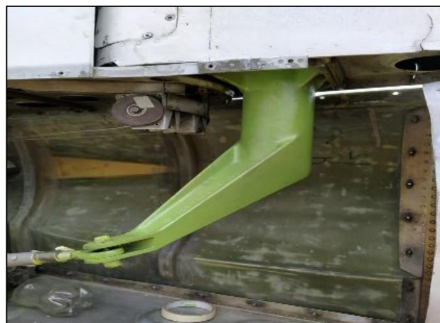
Figura 86. Anticorrosivo en los componentes.
