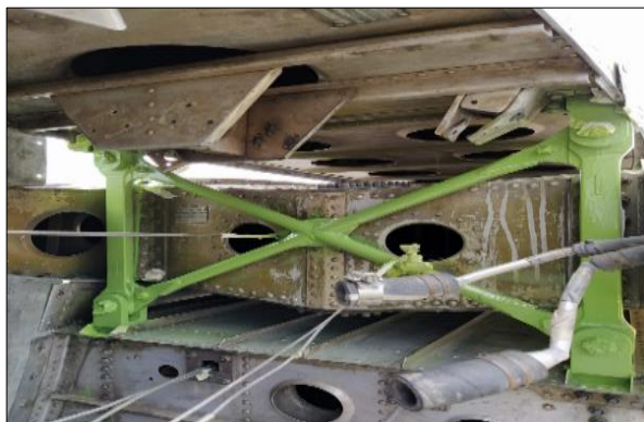
Figura 87. Secado del anticorrosivo.
