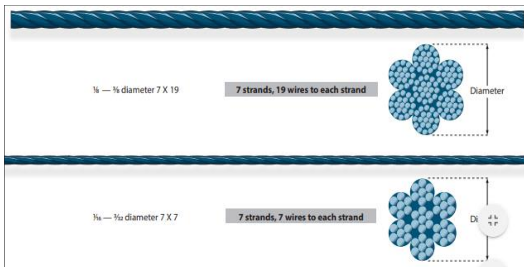
Figura 8. Medidas de cables.
