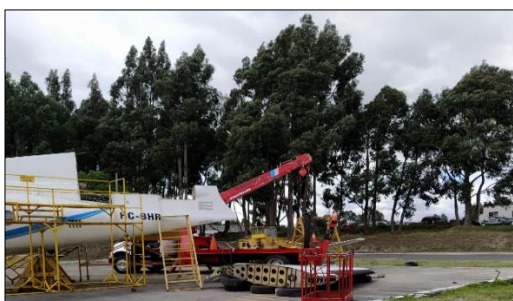
Figura 62. Soporte del estabilizador.
