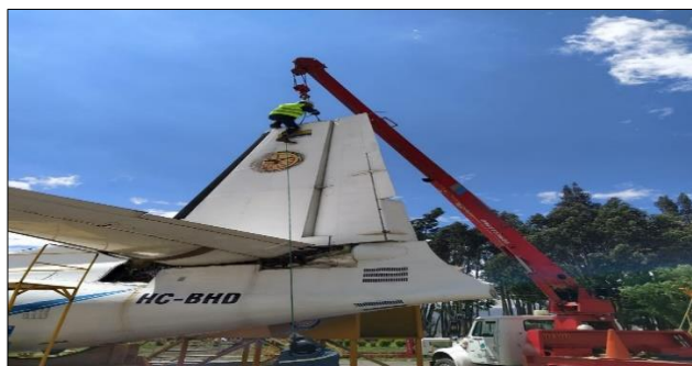
Figura 60. Levantamiento del estabilizador.
