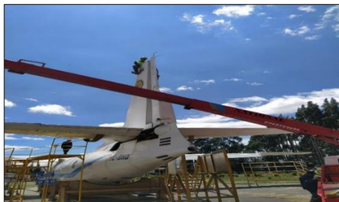
Figura 56. Colocación de eslinga.
