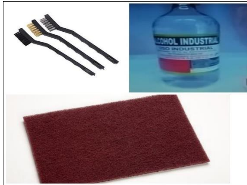
Figura 70. Limpieza de la corrosión.
