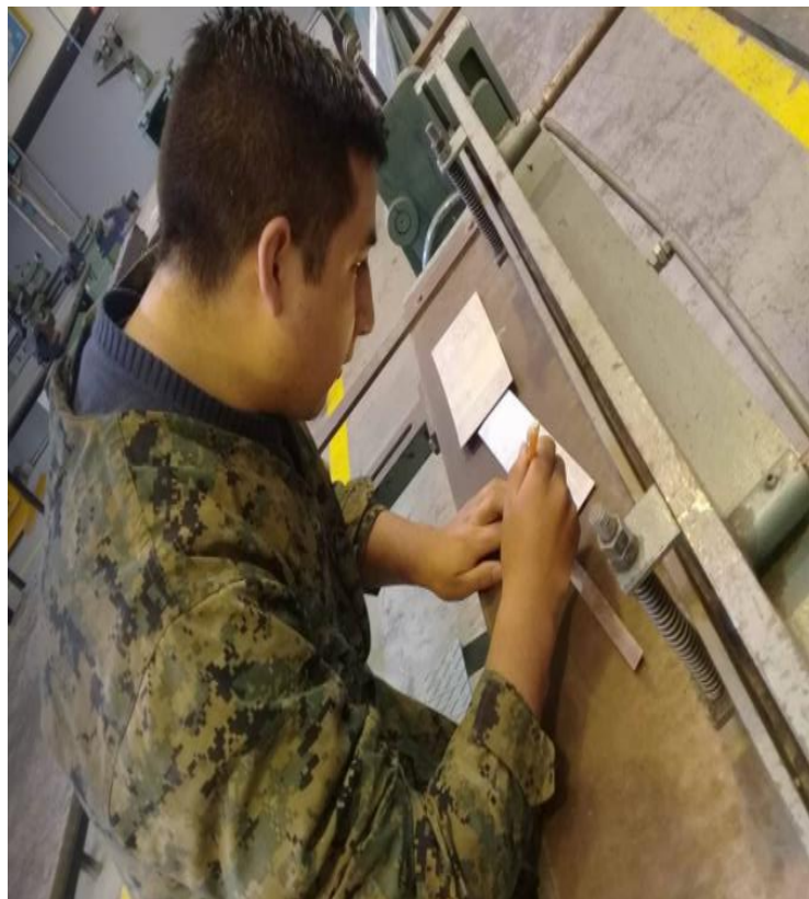
Figura 44 Realización de los montantes del panel AFDS
