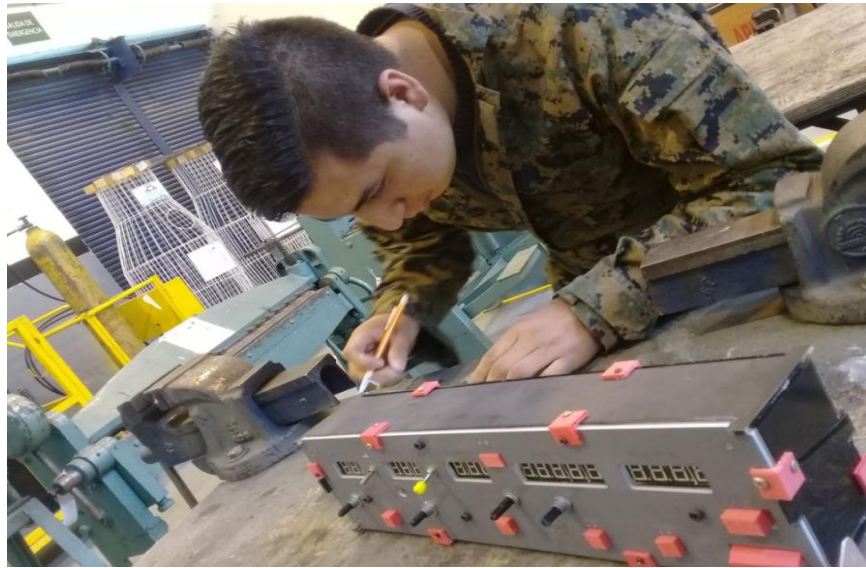
Figura 42 Realización de los montantes del panel AFDS
