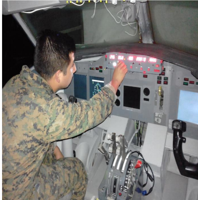
Figura 52 Prueba funcional AFDS
