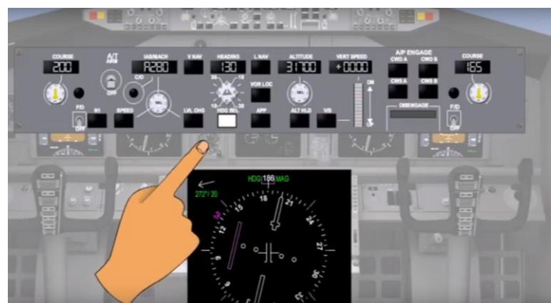
Figura 8 AFDS GYRO COMPAS funcionamiento con el PA
