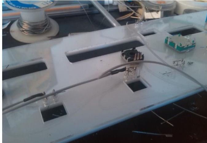
Figura 41 Colocación de los ENCODERS de posición en el AFDS
