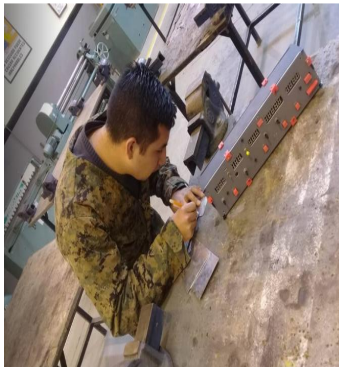
Figura 43 Realización de los montantes del panel AFDS
