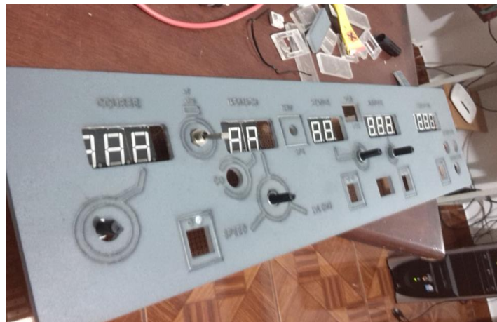
Figura 36 Posición de los displays en el panel mecanizado
