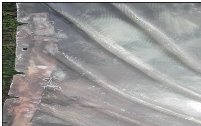
Figura 26. Carenado dañado seleccionado
