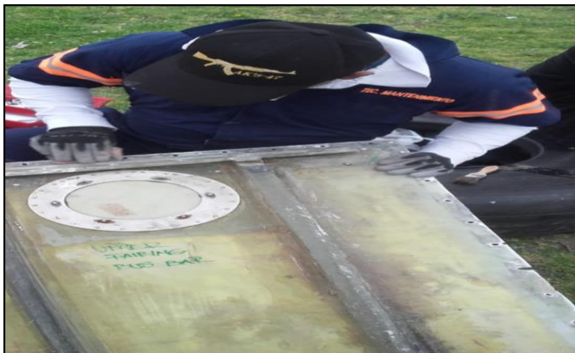
Figura 29. Lijado de la capa de Fibra
