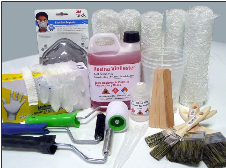
Figura 25. Materiales para reparar carenados
