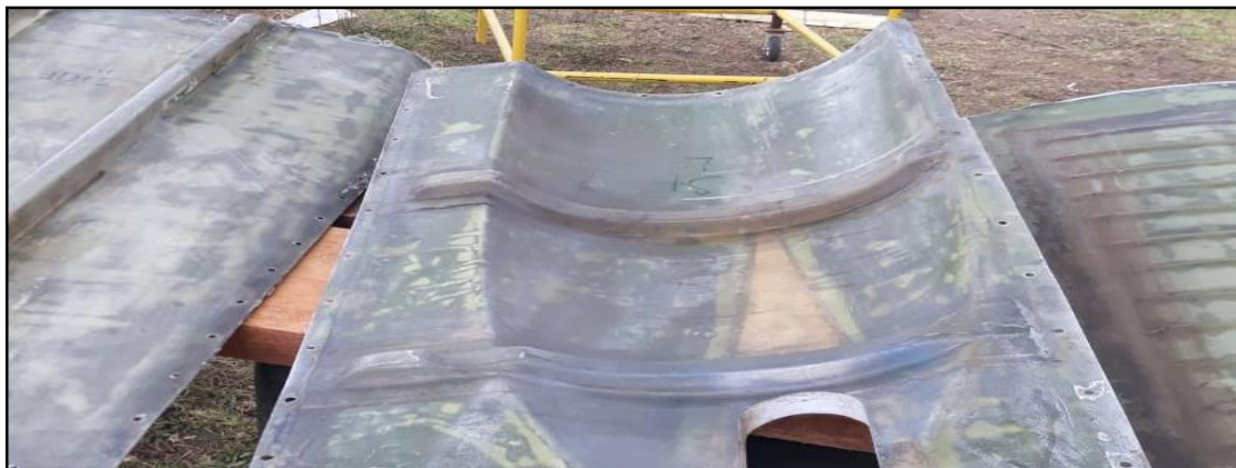
Figura 35. Secado de los carenados y verificación del grosor
