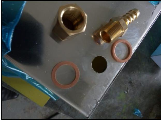
Perforación y colocación de acoples para vaciado del combustible
