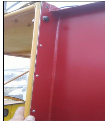
Fijación del tanque, con remachado y colocación de pernos.
