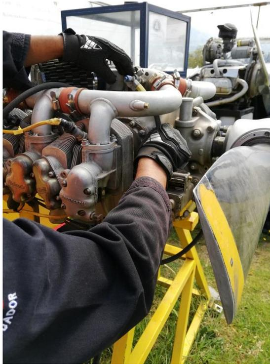
4. Se debe verificar que los sistemas de inducción y escape tengan la instalación adecuada, de abrazaderas y uniones.
