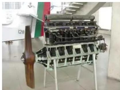
Nota. Motor de cilindros con ubicación lineal, (Ramón, 2013).
