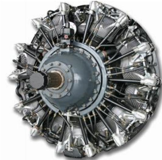
Nota. Motor con cilindros alrededor de su cigüeñal, FAA, 2012, Aviation Maintenance Technician handbook- Power plant Vol 1.
