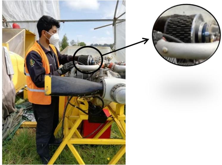
6. Se debe comprobar la libertad de movimiento, instalación adecuada y seguridad de los extremos de los controles del motor.
