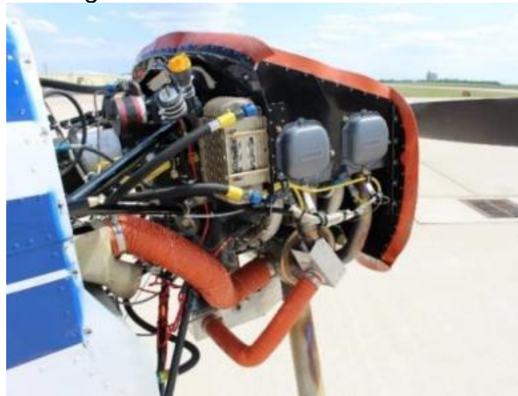
Sistema de refrigeración
