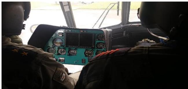
*Nota:* Esta imagen representa el chequeo en cabina para proceder al arranque de los motores.
