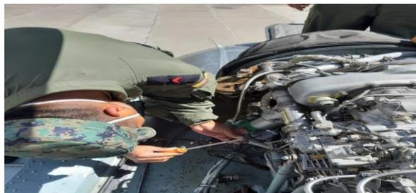
*Nota:* Esta imagen representa la sujeción de la herramienta en el motor específicamente en la base del filtro.
