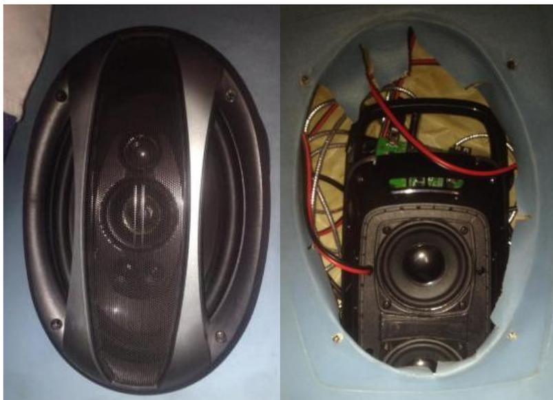
*Nota.* La figura nos muestra los altavoces instalados en la aeronave, se puede observar que los mismos no pertenecen a la aeronave, si no que han sido reemplazados por altavoces genéricos.
