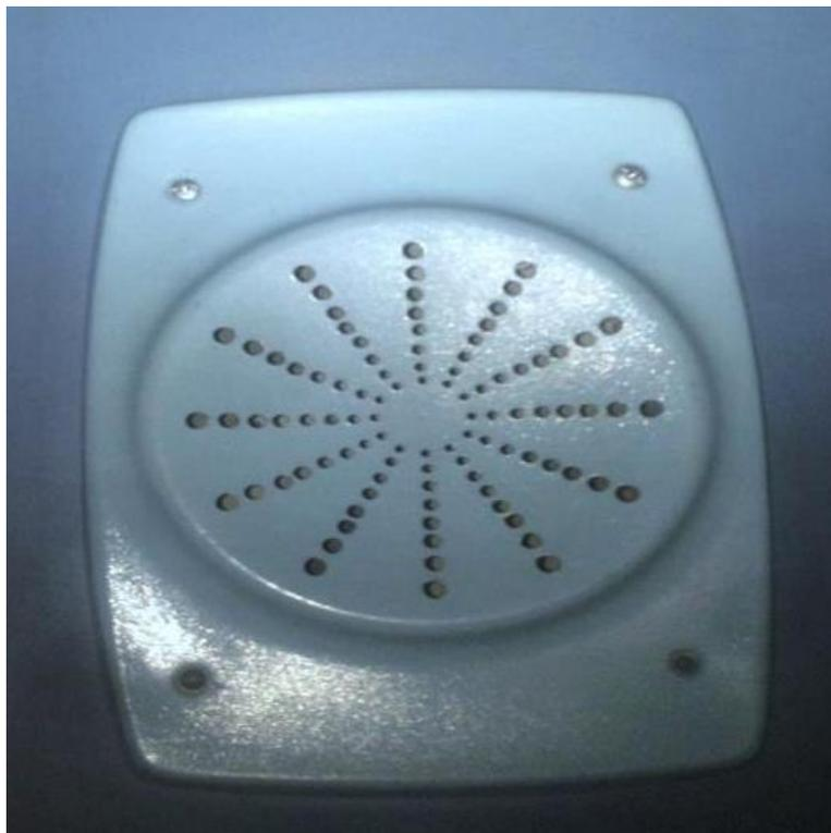
*Nota.* La figura nos muestra la tapa de un parlante perteneciente al sistema Passenger Address, ubicado en los paneles laterales del compartimiento de pasajeros.
