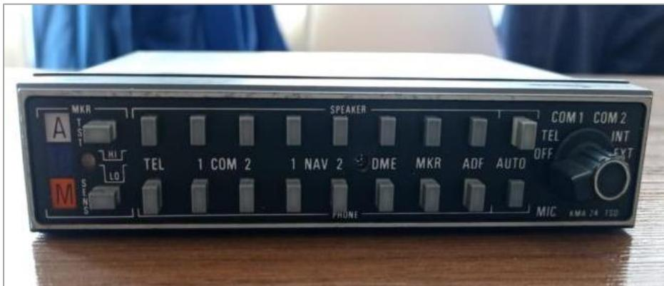
*Nota.* La imagen muestra el panel selector de audio ubicado en la cabina, en el lado izquierdo del asiento del piloto. En el panel mostrado podemos identificar las diferentes opciones de comunicación que nos permite seleccionar.
