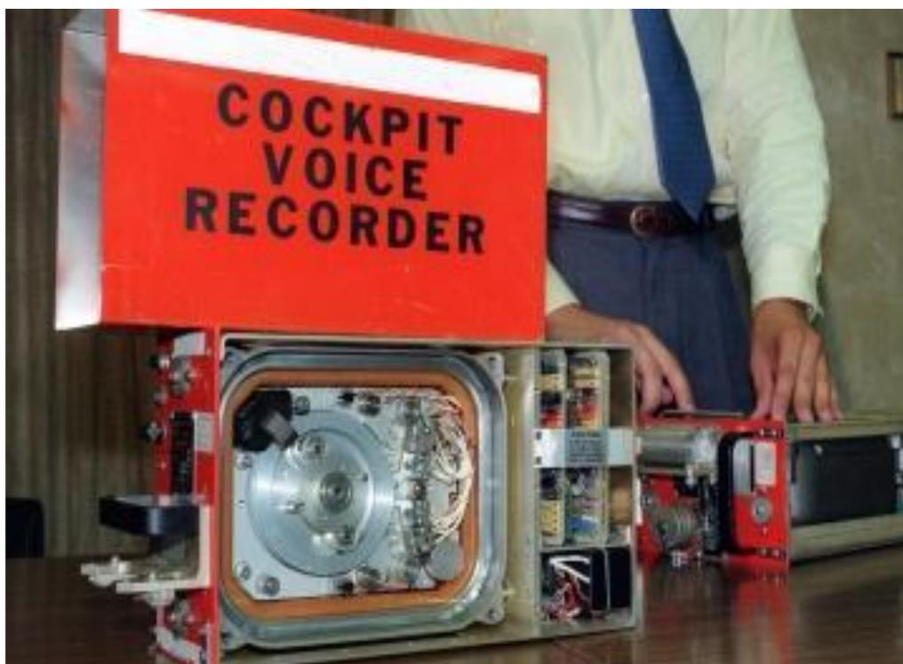
Nota. El gráfico muestra la estructura interna de un grabador de voz en cabina o mejor conocido por su nombre en inglés, Cockpit Voice Recorder. Tomado de *Almacenamiento de datos en la nube*, de R. Rotolo, 2014, Howstuffworks (<https://science.howstuffworks.com>).
