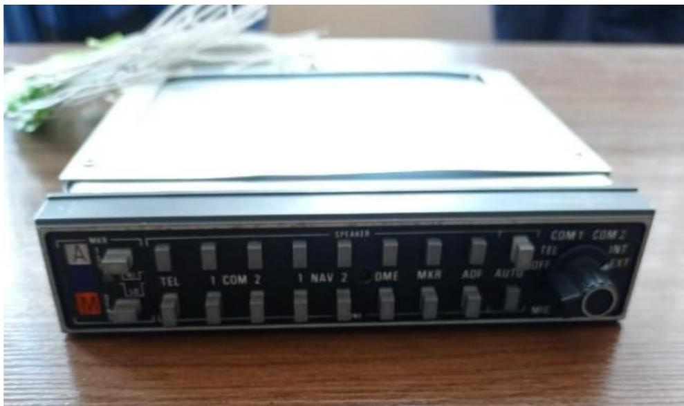
*Nota.* El gráfico muestra el panel de control de audio del equipo Kma 24, su funcionalidad y todos los sistemas a los que puede dar utilidad. Tomado del Manual del Equipo de control de audio Kma 24, Honeywell, 2000.
