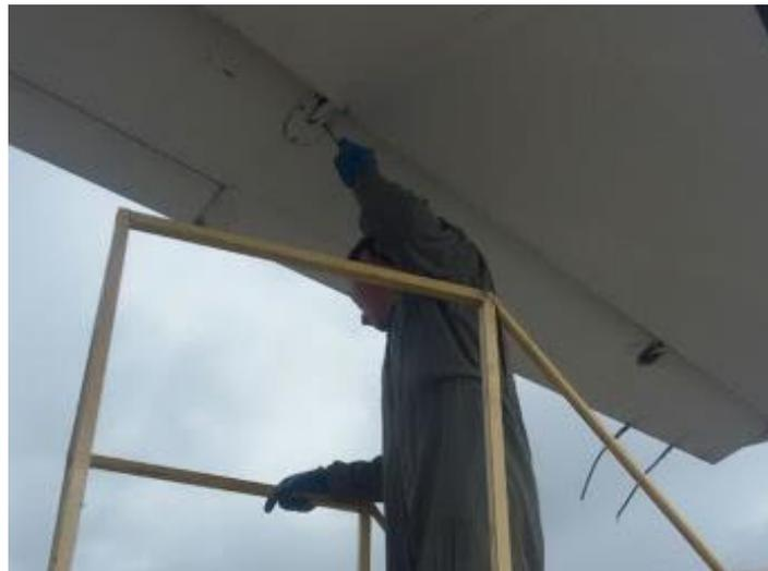
**Figura 45** Limpieza de las bisagras del elevador horizontal
