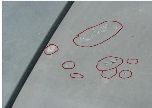
**Figura 30** Corrosión Filiforme
