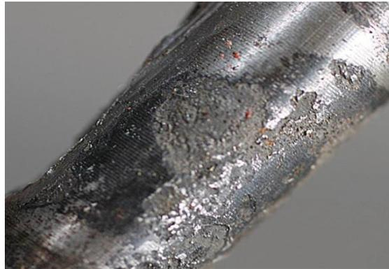
**Figura 31** Corrosión por materiales disimiles
