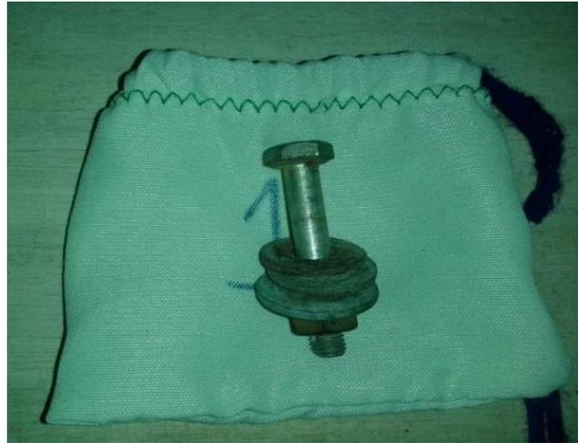
**Figura 54** Perno de sujeción de la bisagra del elevador izquierdo
