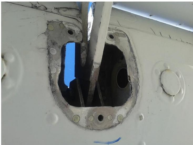
**Figura 59** Soporte de la bisagra 1 izq. del estabilizador
