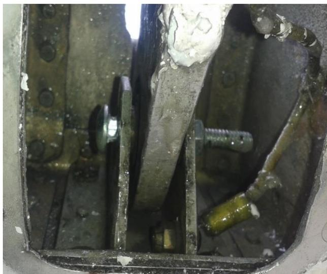
**Figura 62** Bisagra 1 derecha, antes de la limpieza y remoción de pintura
