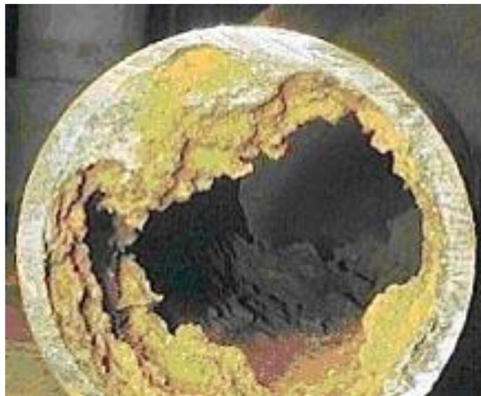
**Figura 34** Corrosión por picadura
