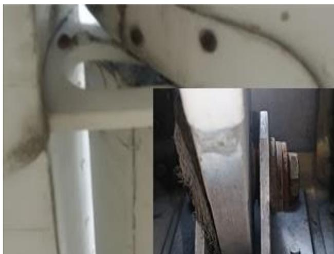
**Figura 43** Corrosión por oxidación perno, y tornillos de tapa de revisión
