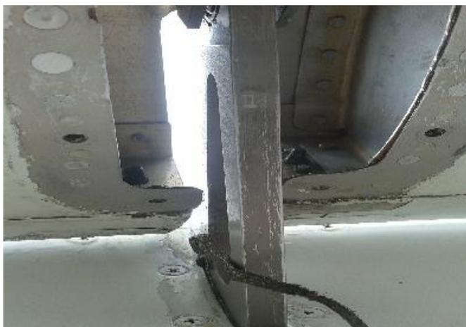
**Figura 61** bisagra 2 izq después de la limpieza
