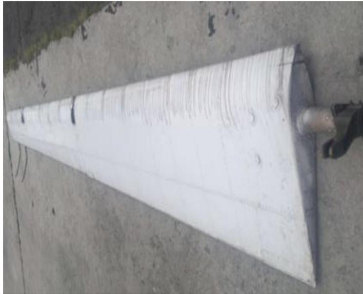
**Figura 25** Elevador despues de ser removido avión Fairchild FH-227J
