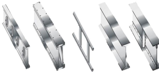
**Figura 17** Formas de vigas usadas en largueros metálicos
