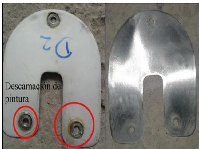
**Figura 77** Tapa de la bisagra 2 derecha antes y después
