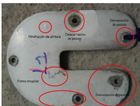
**Figura 69** Tapa de revisión bisagra 1 izquierda
