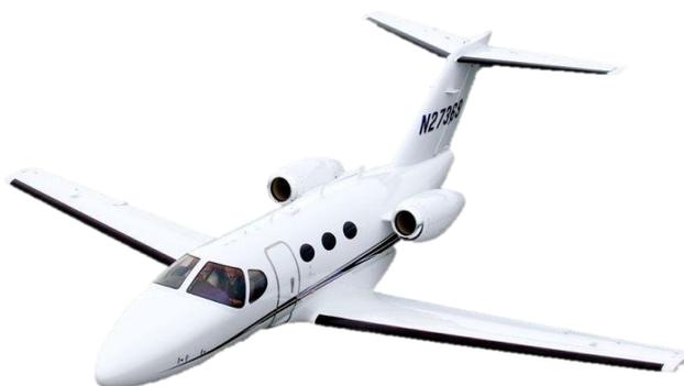
**Figura 10** Cessna Citation Mustang jet fabricado en materiales compuesto
