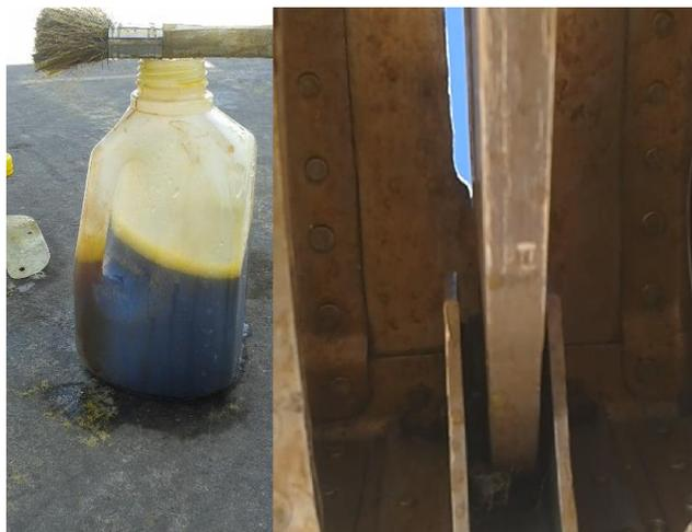
**Figura 78** Aplicación de alodine 1200 a la superficie de aluminio
