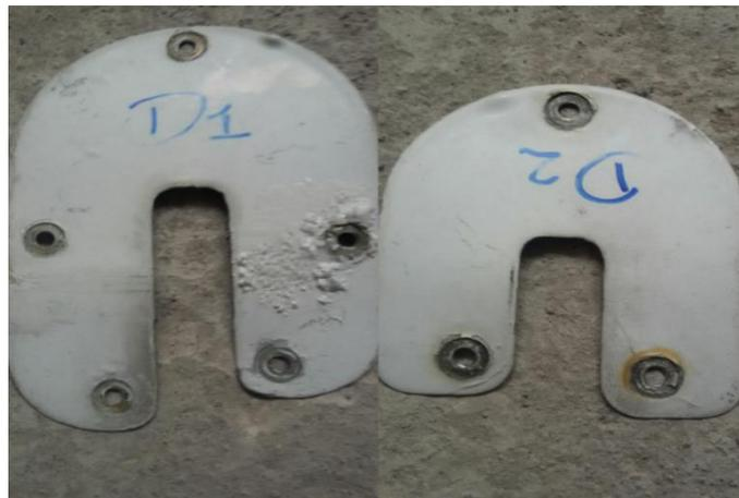
**Figura 51** Tapas de revisión bisagras elevador derecho
