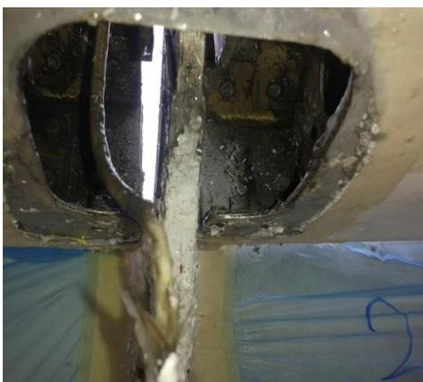
**Figura 64** Bisagra 2 derecha antes de la limpieza y remoción de la pintura
