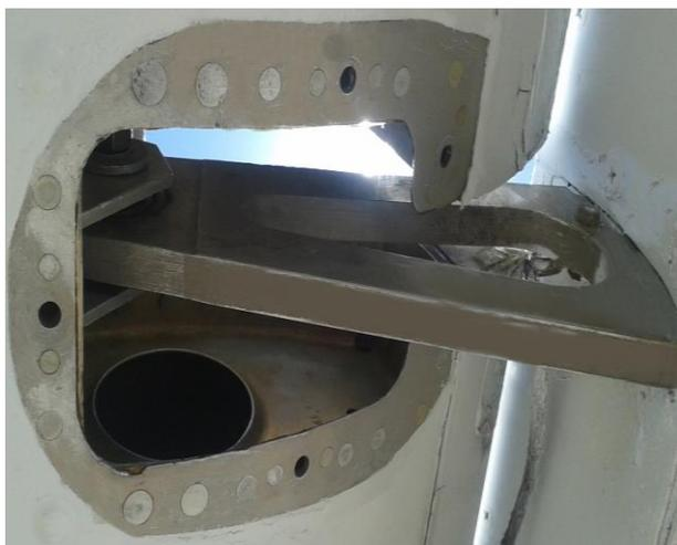
**Figura 66** Bisagra 2 derecha después de la limpieza
