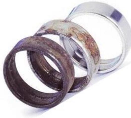
**Figura 38** Comportamiento a la corrosión en aleación de Mg (AM50)
