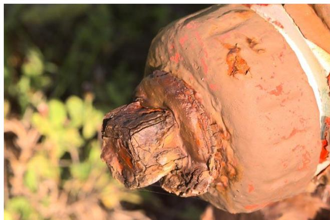
**Figura 33** Corrosión por exfoliación
