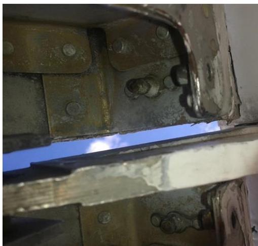
**Figura 44** Posible presencia de corrosión superficie, filiforme
