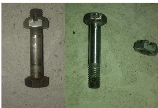
**Figura 71** Perno bisagra 1 antes y después de la limpieza de oxidación.
