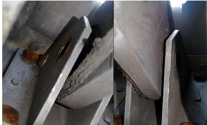
**Figura 53** Bisagra 1 elevador izquierdo luego de ser removida el perno de sujeción
