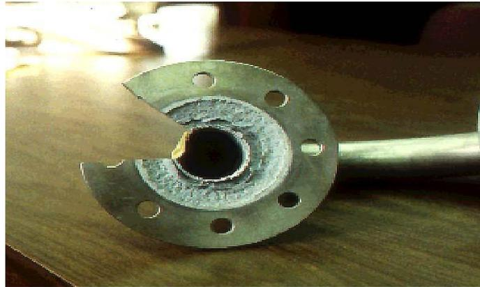
**Figura 32** Corrosión por celdas de concentración
