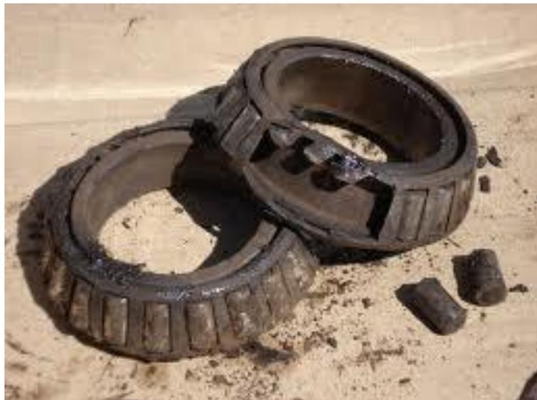
**Figura 35** Corrosión por desgaste
