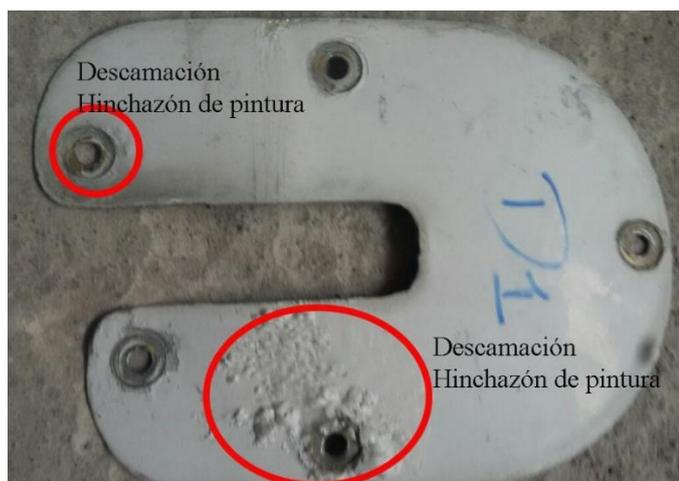
**Figura 75** Tapa de revisión Bisagra 1 derecha
