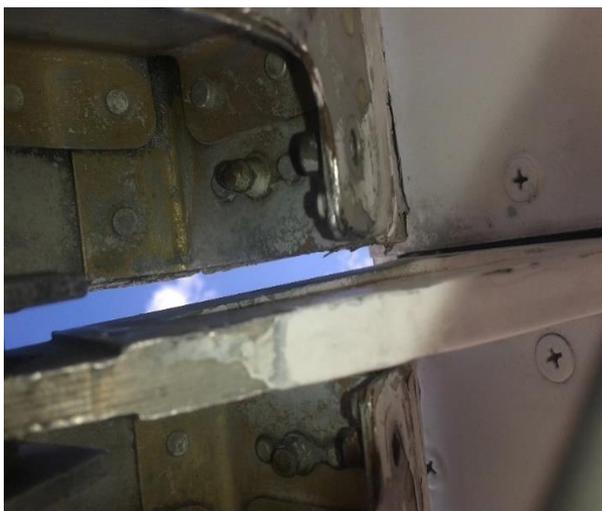
**Figura 55** Bisagra 1 izq luego de limpieza con solvente no abrasivo.
