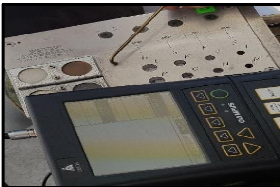
Figura 54 Probeta en el punto nulo del bloque
