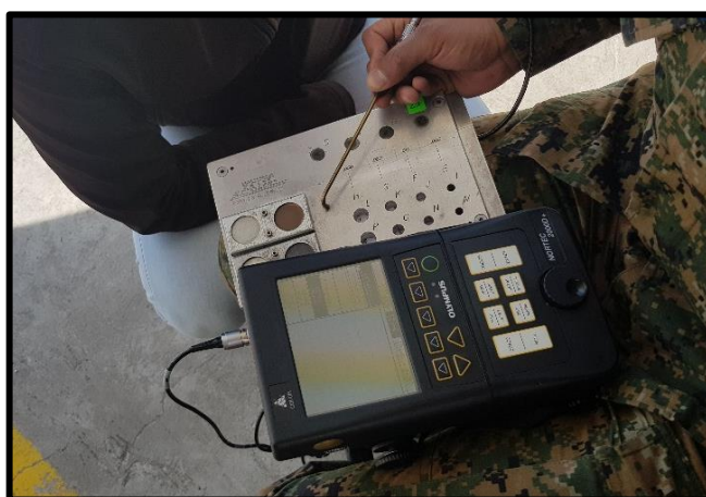
Figura 53 Calibración del equipo de Eddy Current
