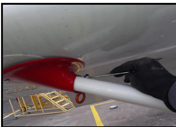
Figura 27 Carenado y ping de aseguramiento a tierra del strut
