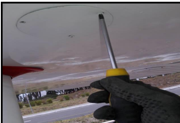
Figura 26 Destornillando las tapas de inspección.
