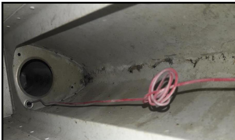
Figura 32 Montículo de tierra en el interior del ala
