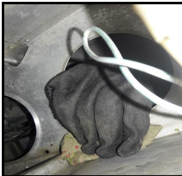
Figura 34 Limpieza parte interna del ala
