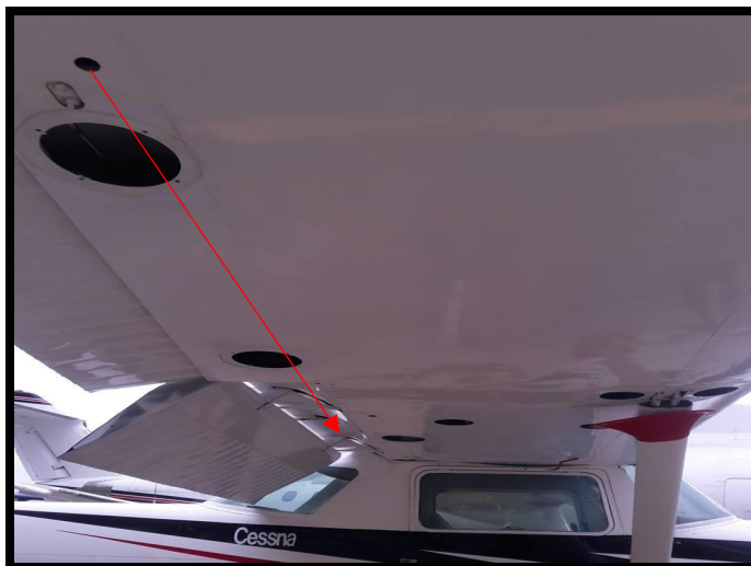
Figura 44 Orden de inspección de los accesos
