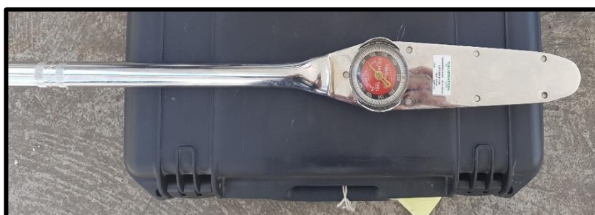
Figura 69 Torquímetro de 250 lbs*fl
