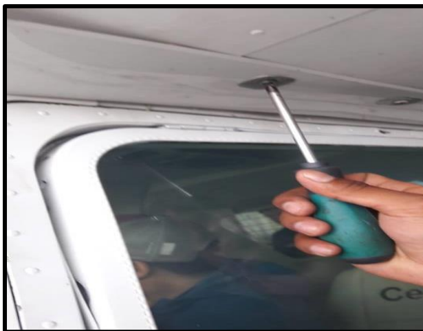
Figura 41 Remoción de carenados del ala
