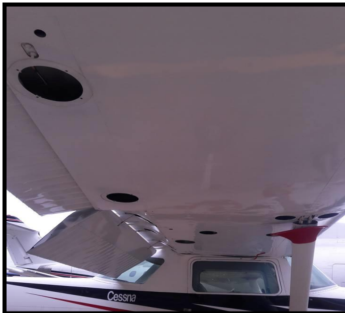
Figura 39 Tapas de inspección removidas
