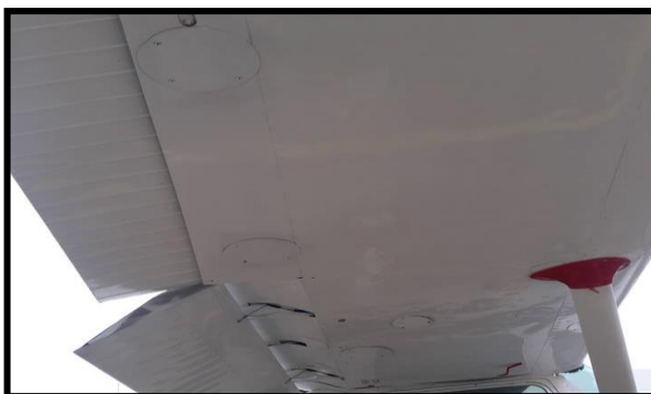
Figura 23 Tapas de inspección en el ala.
