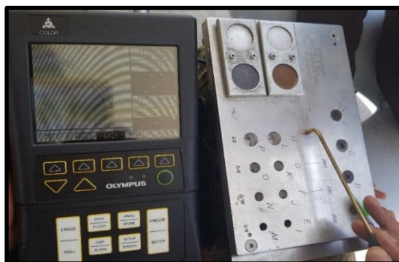
Figura 56 Probeta en una muesca del bloque
