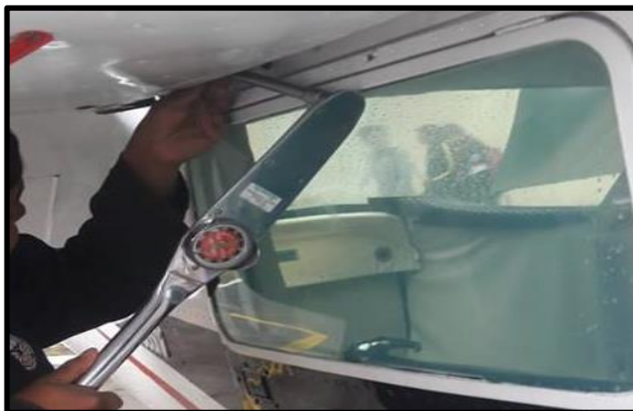
Figura 61 Torque en pernos del ala.
