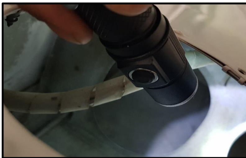
Figura 48 Inspección a miembros estructurales principales del ala
