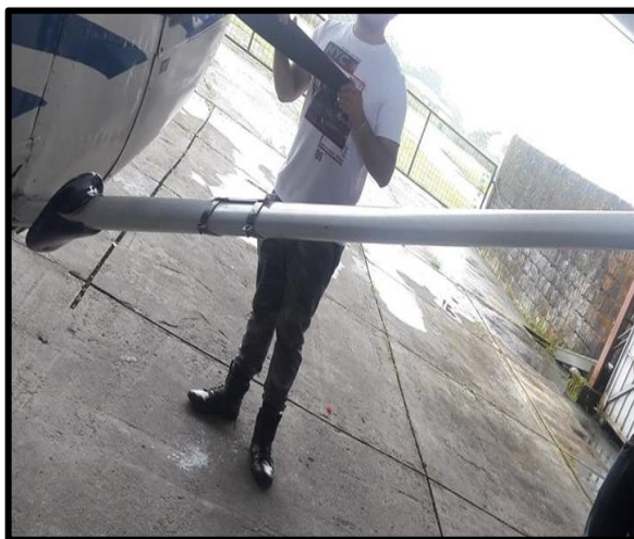
Figura 63 Inspección visual del strut
