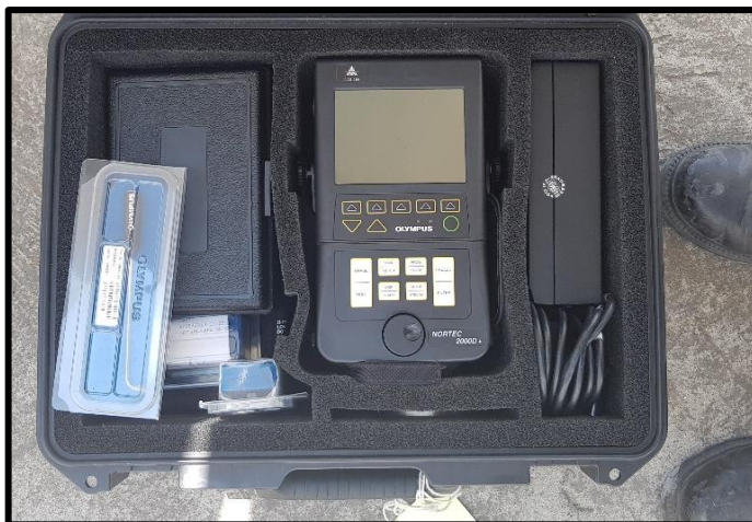
Figura 50 Equipo de NDI Eddy Current
