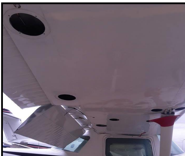
Figura 29 Acceso a la parte interna del ala
