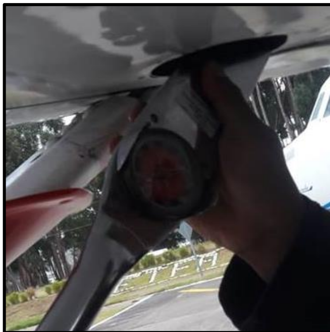
Figura 70 Torque en la parte superior del strut
