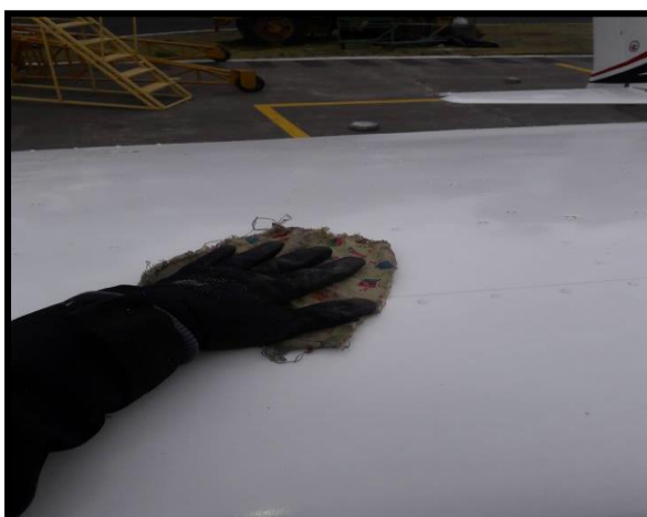
Figura 22 Limpieza de la superficie alar.
