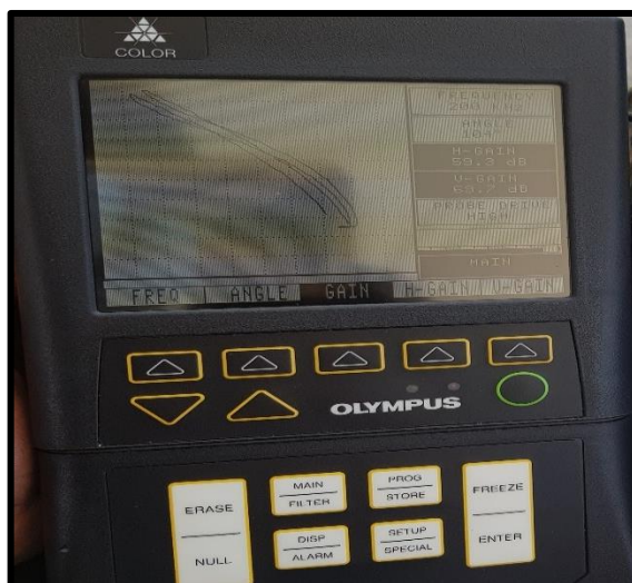
Figura 57: Señal en el instrumento de Eddy Current
